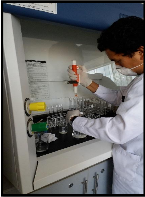
Figura 11: Realizando las diluciones seriadas con agua destilada estéril (9 ml/ tubo) y 1ml de la muestra en cada tubo
