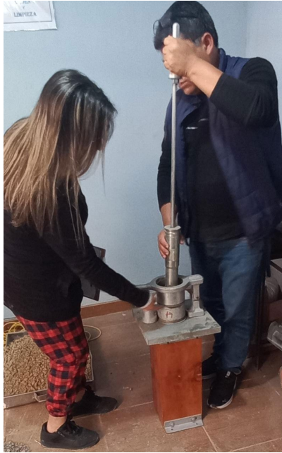
Figura 5 Compactación con martillo compactador
