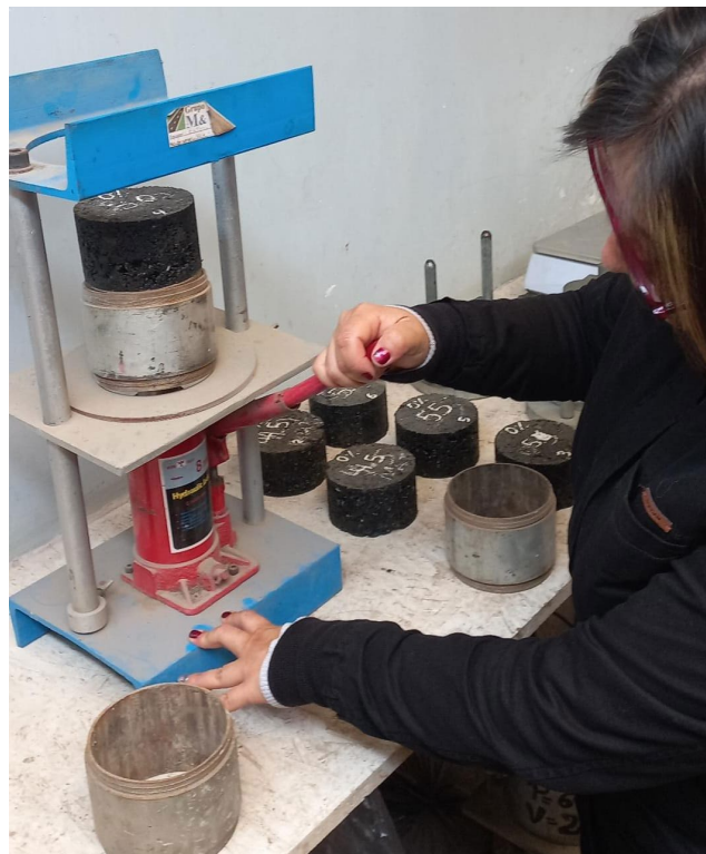
Figura 6 Retiro de muestras con gata hidráulica
