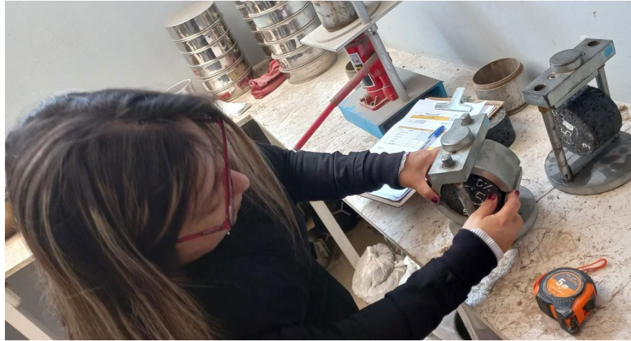
Figura 7 Colocación de muestras en las mordazas Marshall y Lottman
