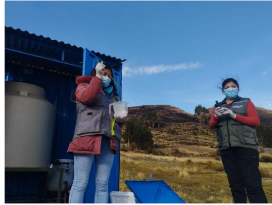
Figura 19. Monitoreo de cloro residual en el reservorio.
