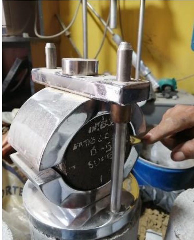
Figura 12 Briqueta sometida a rotura
