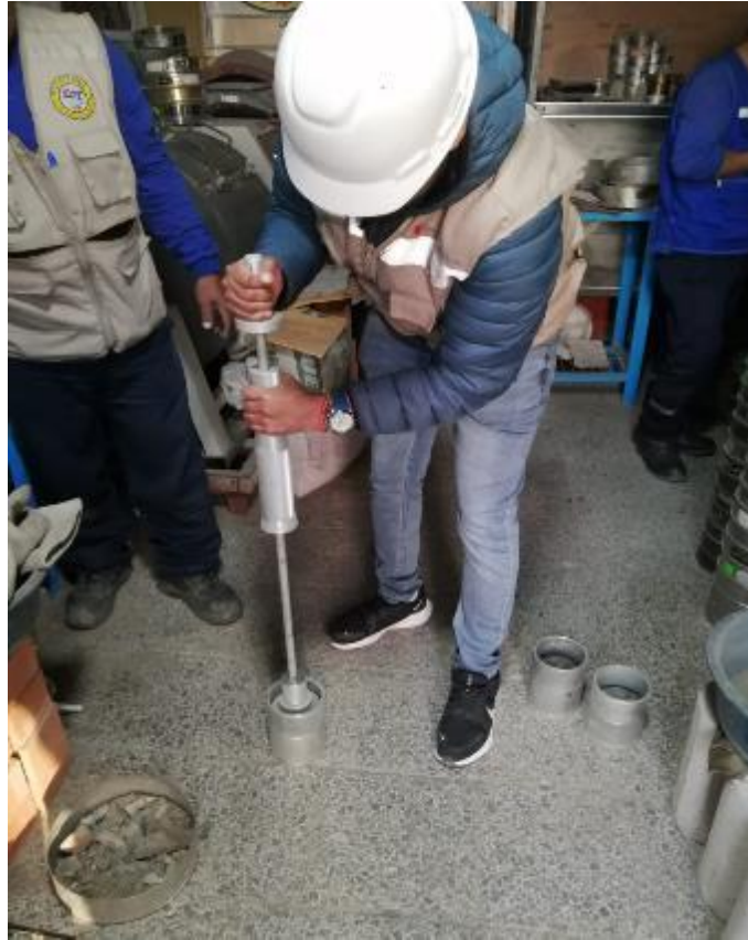
Figura 10 Compactación de briquetas mac-2
