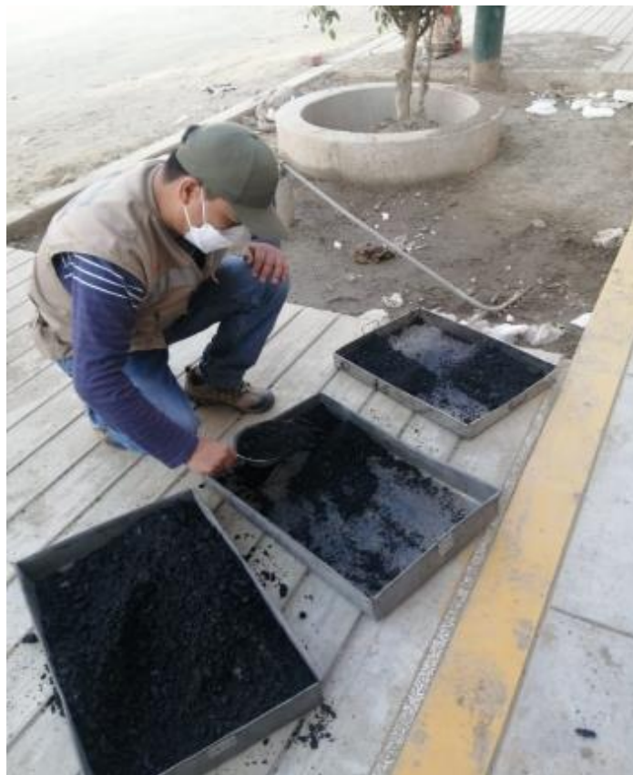
Figura 9 Preparación de la mezcla asfáltica
