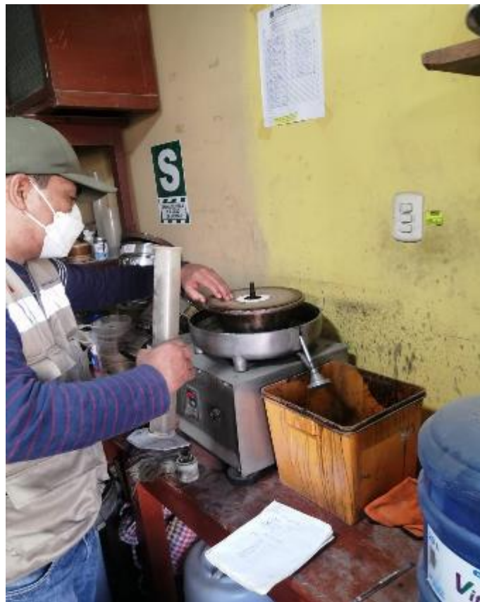
Figura 13 Aplicación de cloruro de metileno
