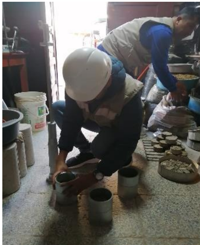
Figura 11 Extracción de briquetas para rotura
