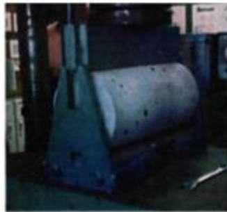
Figura 02: método de la resistencia a la tracción indirecta
