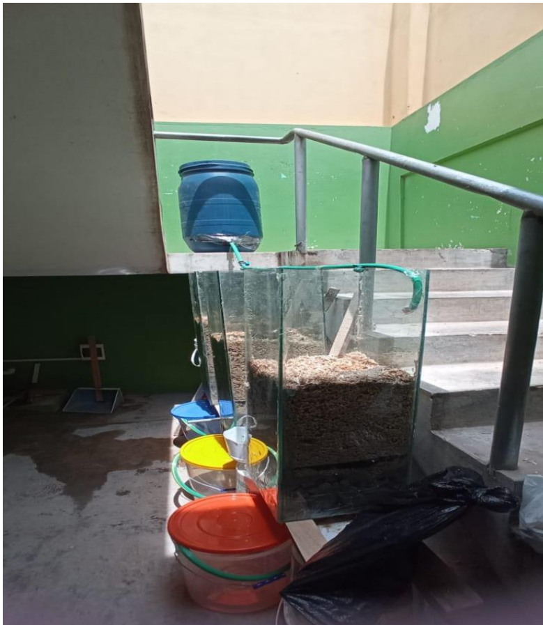
Figura 8. Proceso del tratamiento de las aguas residuales del camal
