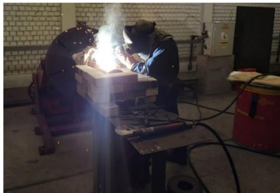
Se inició el cordón de soldadura por la parte externa y se termina a unos 10mm aproximadamente del apéndice (de dentro hacia fuera). El cordón debe tener una altura entre 3 a 4mm y un ancho entre 12 a 15mm. El segundo cordón es paralelo al primer cordón, pero se ubica a 90° con relación a la circunferencia del
