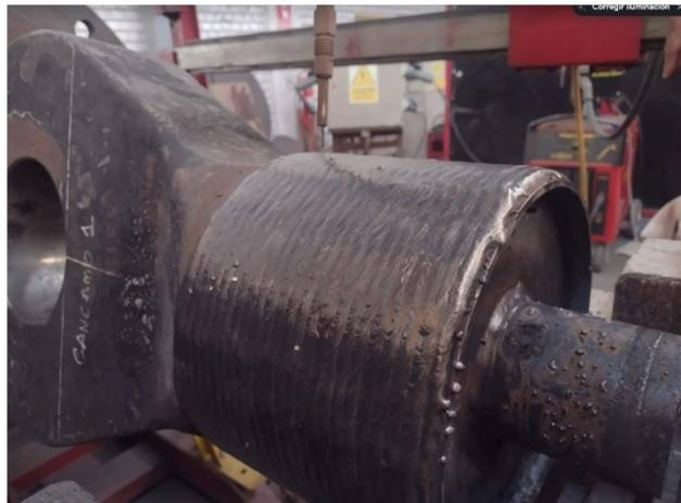
Cuando se terminó el proceso de soldadura de la zona roscada del cáncamo, se procedió a reconstruir el alojamiento de la bocina del cáncamo. En esta operación se repite las mismas actividades que en la aplicación convencional de soldadura al cuerpo del pitch brace.
