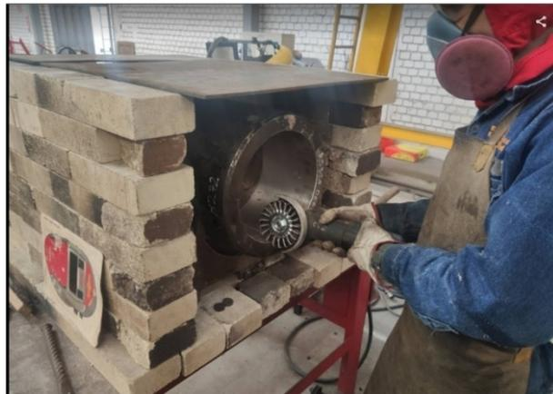
Posteriormente, se realizó un calentamiento para poder soldar los apéndices a los extremos del cuerpo del pitch brace.
