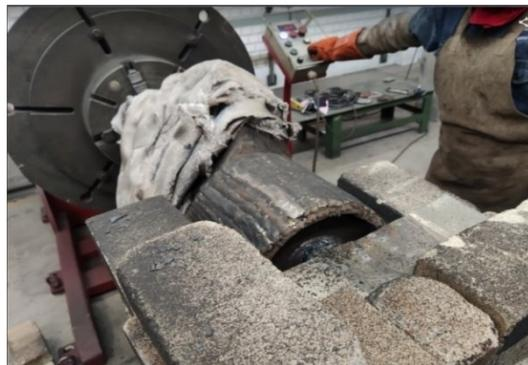
Cuando se haya terminado de reconstruir por soldadura la zona roscada del cáncamo, se procedió a reconstruir el alojamiento de la bocina del cáncamo. En esta operación se repite las mismas actividades que en la aplicación convencional de soldadura al cuerpo del pitch brace.
