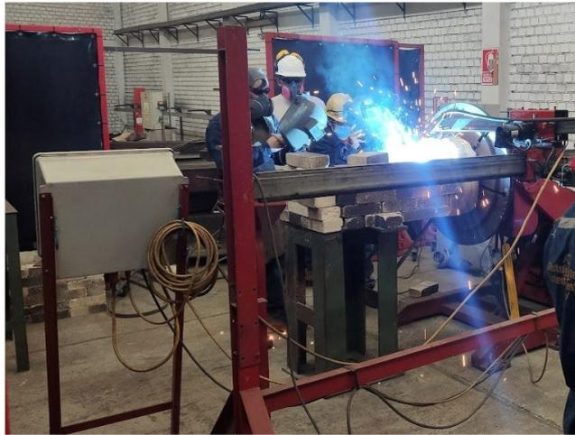
Se debe entender que el inicio de la soldadura es de afuera hacia adentro del componente; esto es para distribuir la mayor cantidad de calor a toda la masa del componente. Se realizó 4 capas de soldadura de 3mm de espesor por capa, obteniendo una altura de aproximadamente 12mm.
