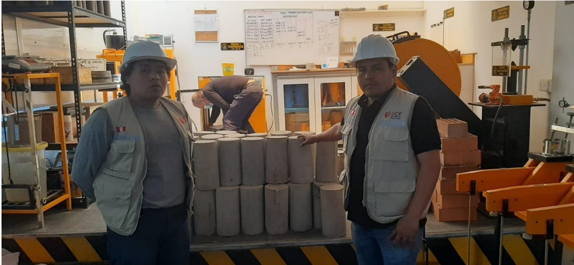
Testigos de cilíndricos de concreto para ensayar a compresión.
