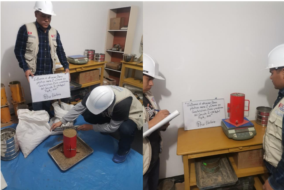
Ensayo de peso unitario de los agregados
