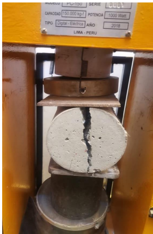
Ensayo de resistencia a la tracción dividida.
