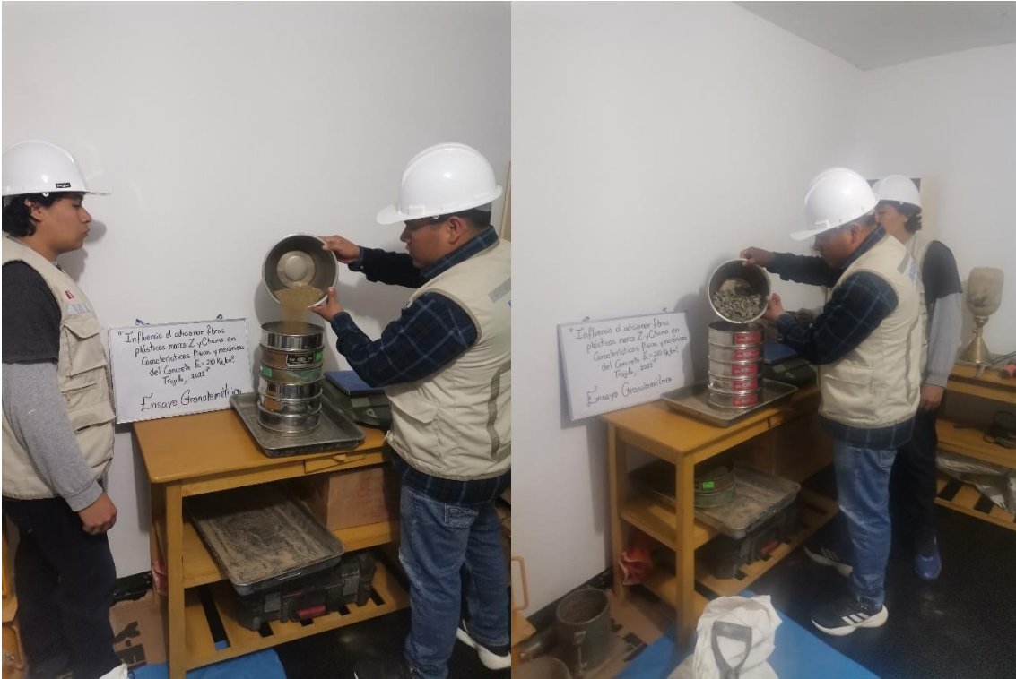
Ensayo de análisis granulométrico de los áridos pétreos
