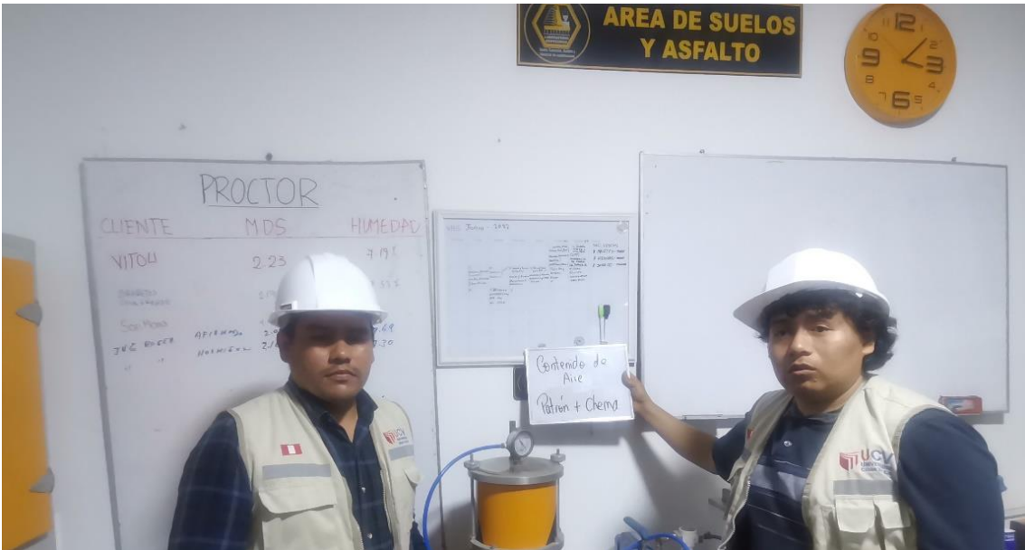
Ensayo de contenido de aire por método de presión.
