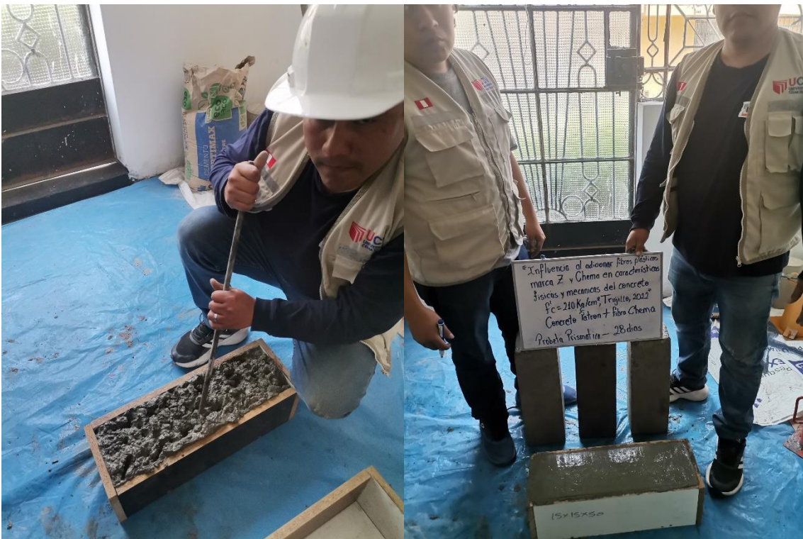
Elaboración de las vigas de concreto para el ensayo de flexión
