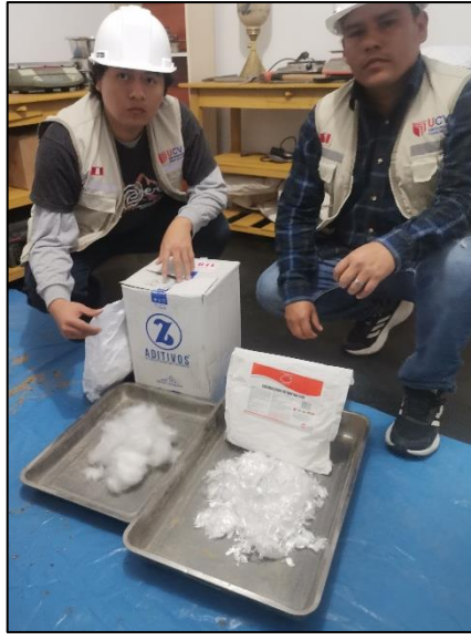
Figura 4. Fibra Z de Polipropileno (izquierda) y Fibra Chema Ultrafina (derecha)
