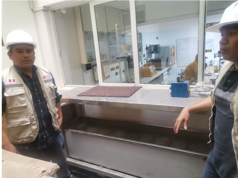
Figura 10. Curado de los testigos de concreto en pozas de agua.
