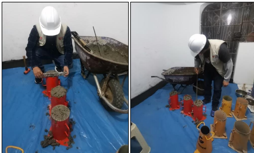
Figura 8. Moldeado del concreto fresco en las probetas cilíndricas.
