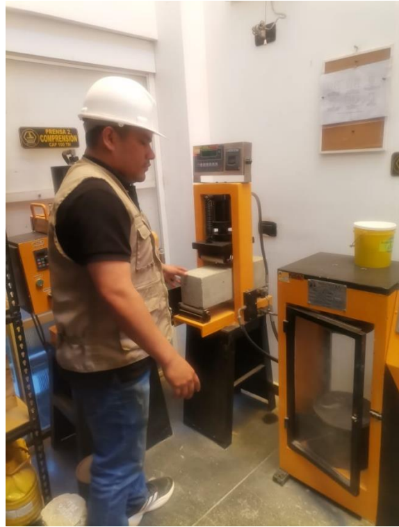
Ensayo de resistencia a la flexión del concreto.
