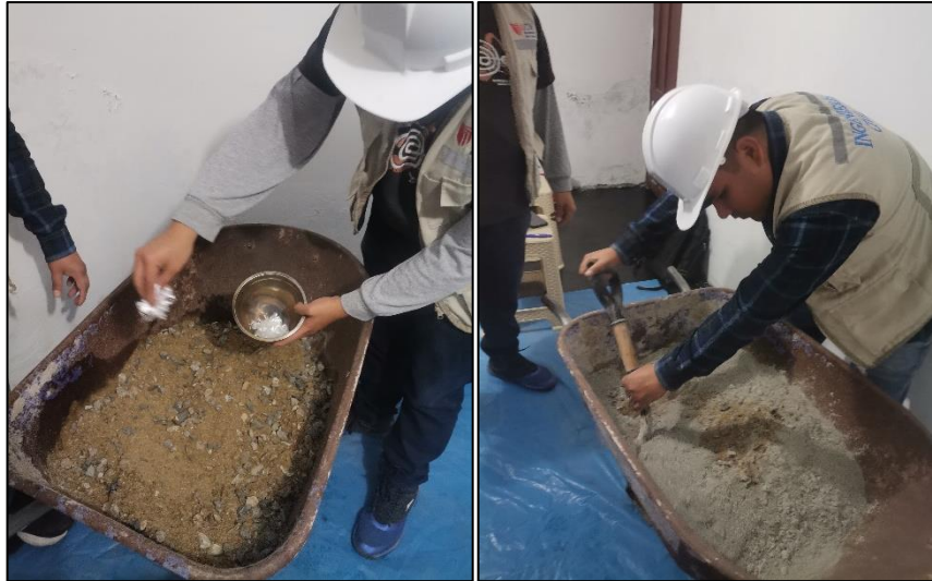
Figura 7. Dosificación y mezclado de las fibras plásticas con los materiales en seco.
