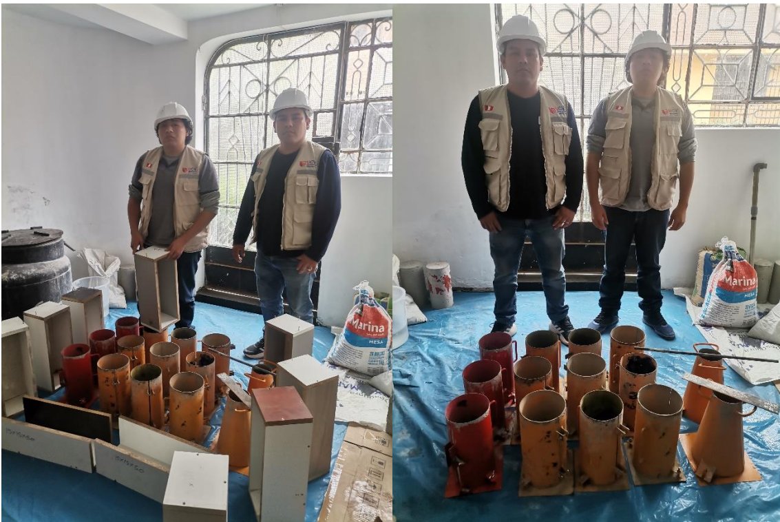
Moldes cilíndricos y prismáticos para la elaboración de especímenes de concreto.
