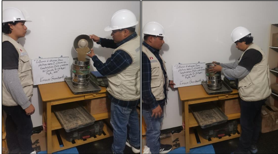
Figura 5. Procedimiento del ensayo de análisis granulométrico de los agregados.
