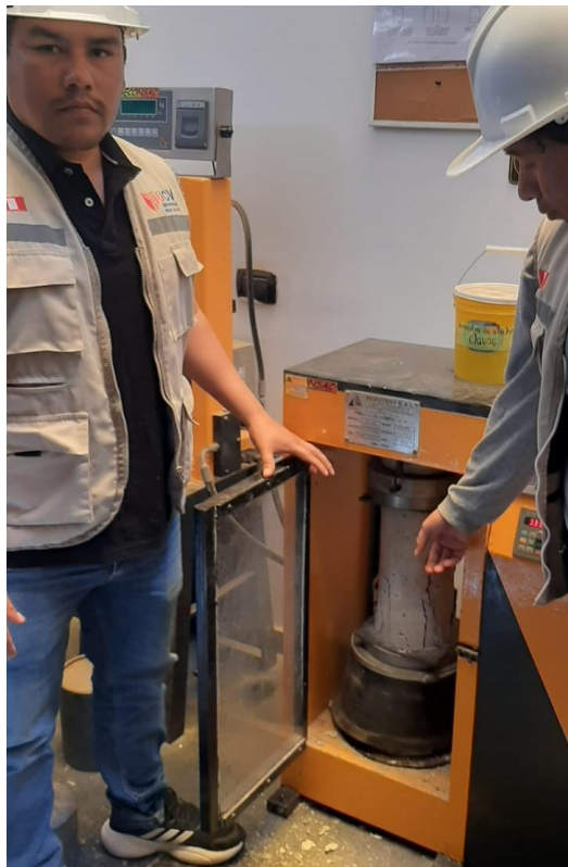
Ensayo de resistencia a la compresión del concreto.
