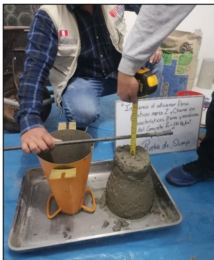
Figura 9. Prueba asentamiento del concreto fresco.
