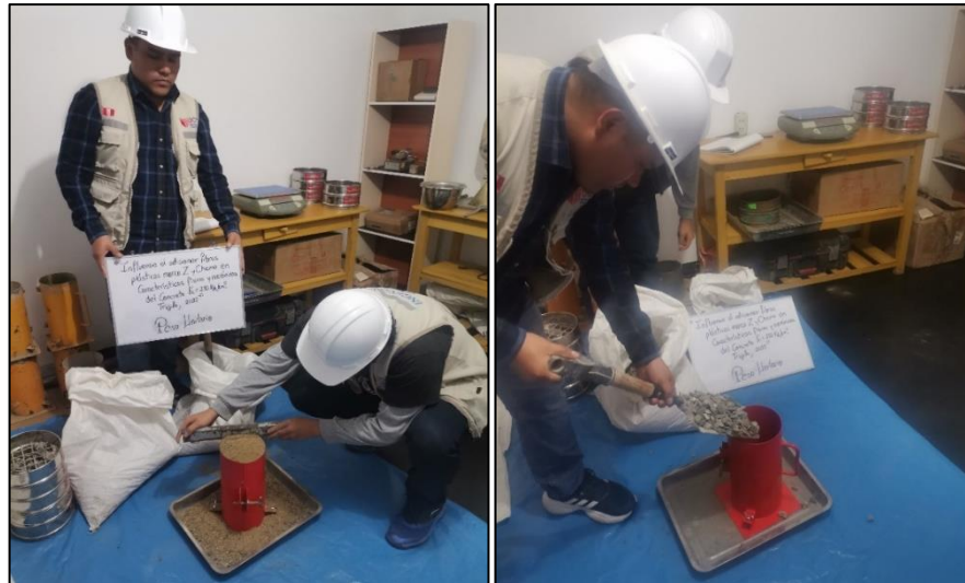
Figura 6. Ensayo de peso unitario de los agregados pétreos
