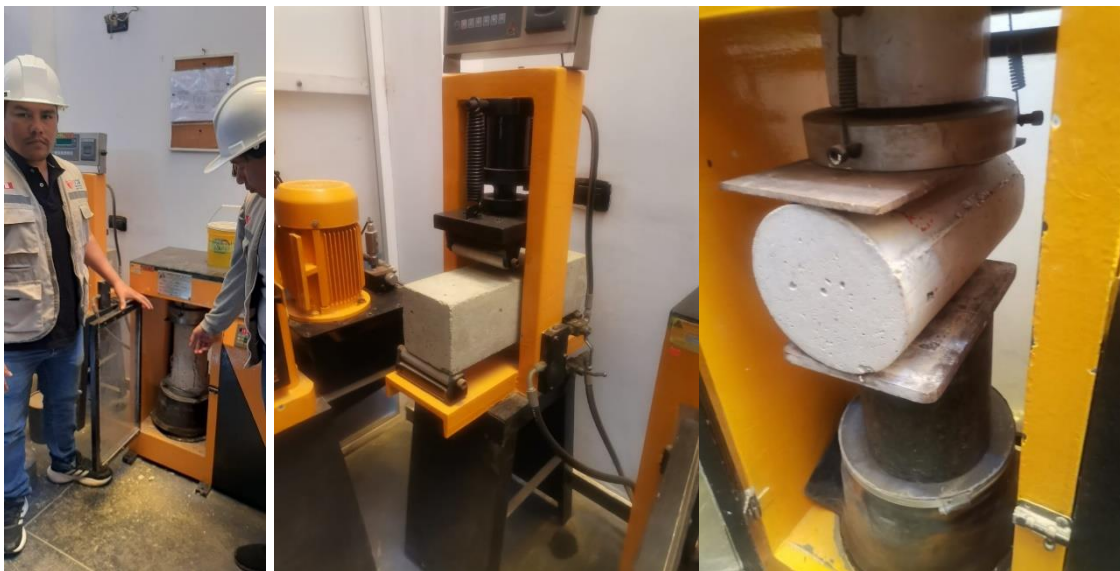
Figura 11. Realización de los ensayos (de izquierda a derecha) de resistencia a la compresión, flexión y tracción.
