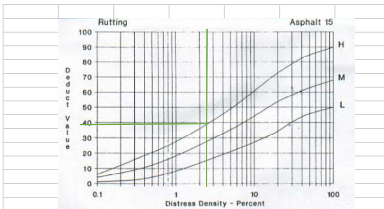
Figura 10. V. D de la falla ahuellamiento.
