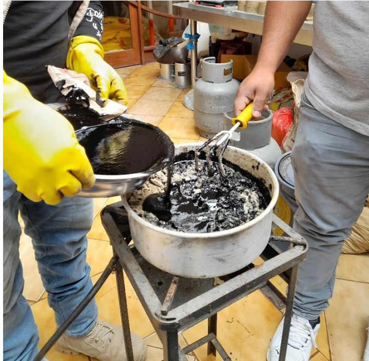
Figura 91. Mezclamos con los agregados.
