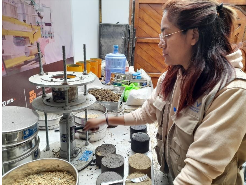
Figura 97. Extracción de briqueta 1.
