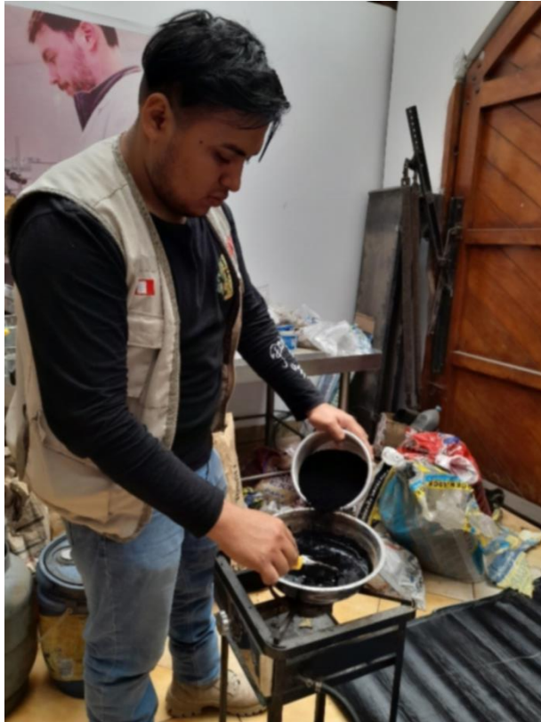
Figura 89. Adición del caucho al cemento asfáltico.
