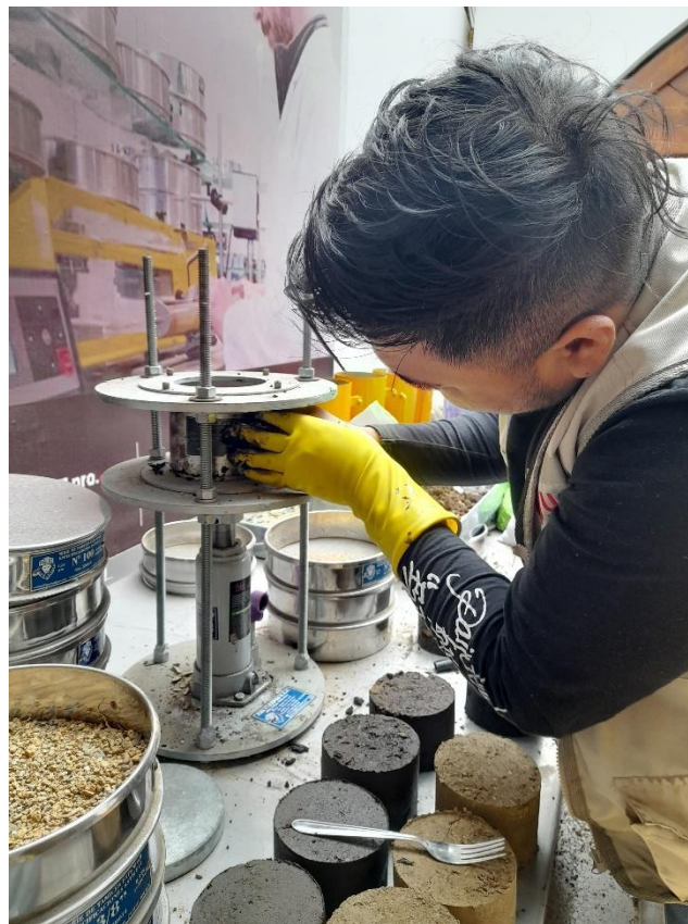
Figura 98. Extracción de briqueta 2.
