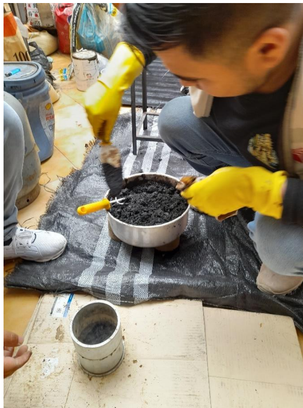
Figura 92. Primera capa de la briqueta.
