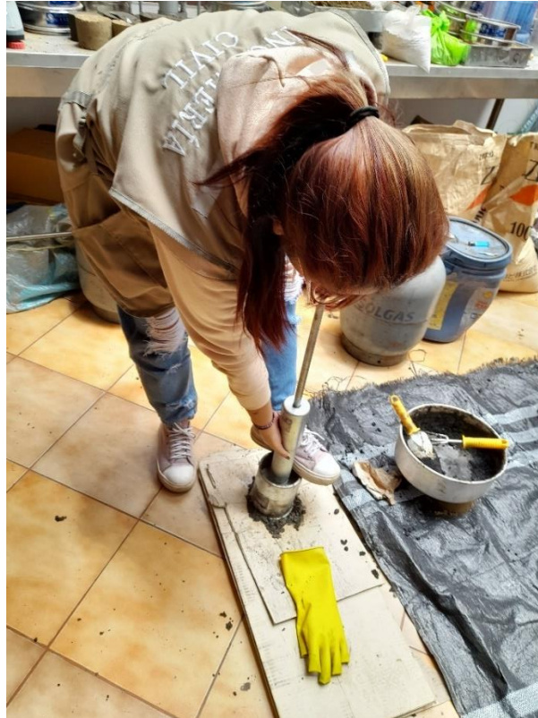
Figura 93. Compactación segunda capa.
