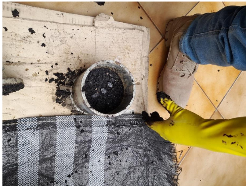
Figura 94. Muestra en su segunda capa compactada.
