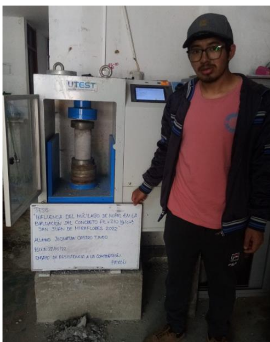
Figura 11: Rotura de probeta patrón.
