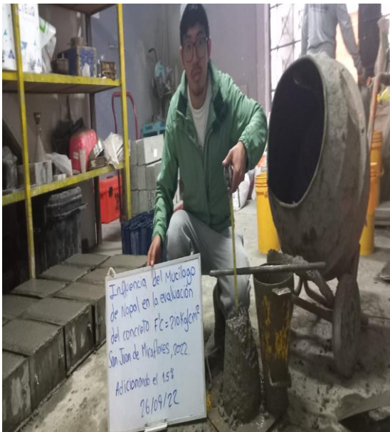
Figura 8: Slump adicionando 1.5% del biopolímero.
