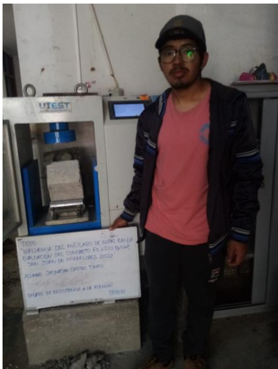
Figura 14: Rotura de viga patrón. Fuente: Elaboración propia.
