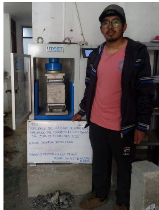
Figura 15: Rotura de viga adicionando el 4.5% del biopolímero. Fuente: Elaboración propia.
