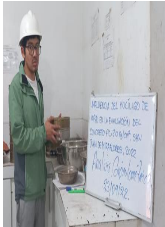
Realización del analisis granulometrico de los agregados.
