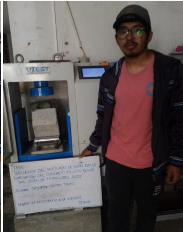
Realización del ensayo de Resistencia a la Flexión del concreto.
