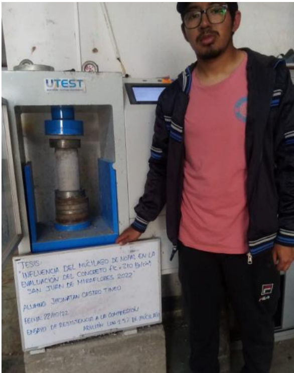
Realización del ensayo de Resistencia a la Compresión del concreto.
