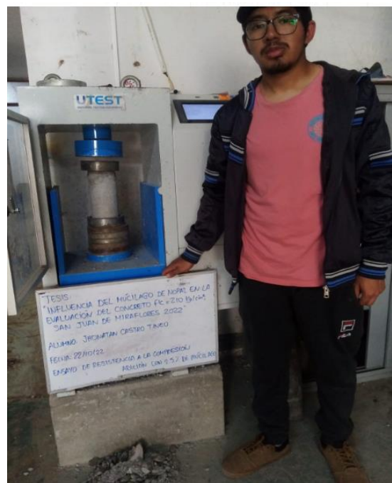
Figura 12: Rotura de probeta adicionando el 2.5% del biopolímero.
