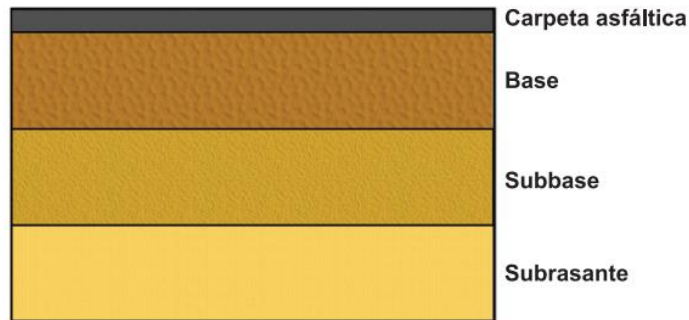
Figura 1. Estructura del pavimento flexible
