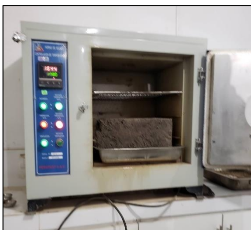
Figura 17. Ensayo de absorción en el Horno a 110 °C
