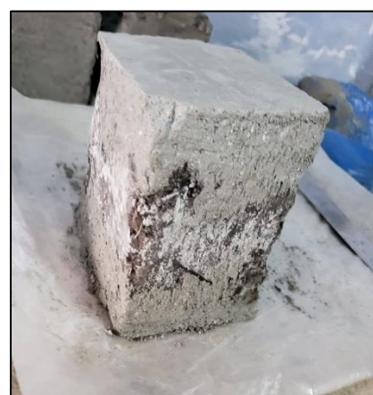
Figura 21. Moldes CBR con la adición de (1% y 2%) de paja de cebada y fibra de lana de oveja.
