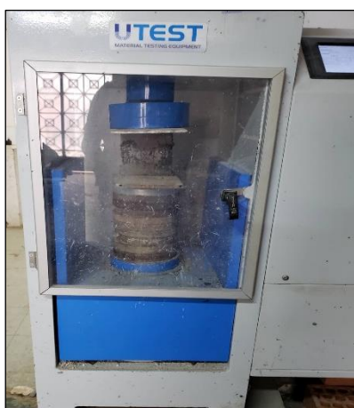
Figura 20. Ensayo de resistencia a compresión.
