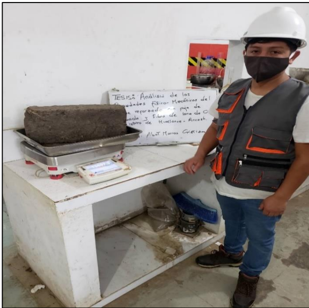
Figura 9: Pesando los bloques de adobe con la adición de (1% y 2%) de paja de cebada y fibra de lana de oveja.
