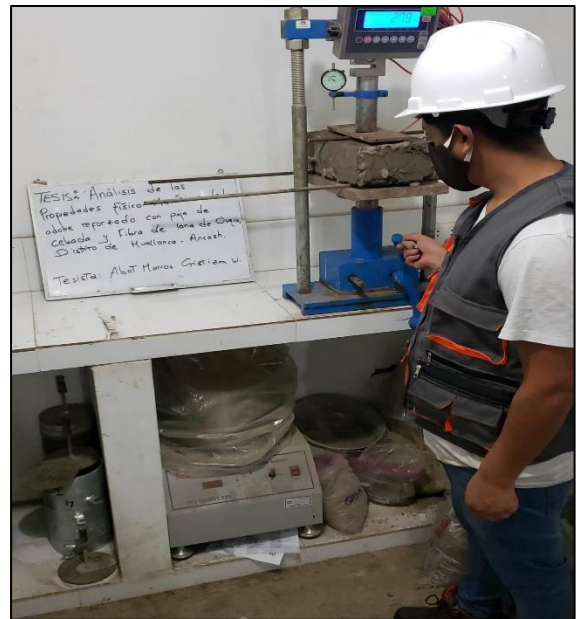
Figura 10 : Ensayo de absorción de Moldes con la adición de (1% y 2%) de paja de cebada y fibra de lana de oveja.
