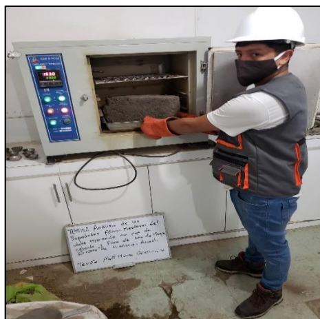
Figura 18 .Ensayo con los Moldes de CBR con la adición de (1% y 2%) de paja de cebada y fibra de lana de oveja.
