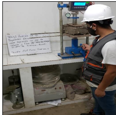
Figura 24. Ensayo de resistencia a flexión
