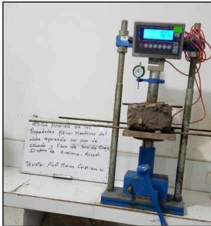
Figura 23. Ensayo de resistencia a flexión
