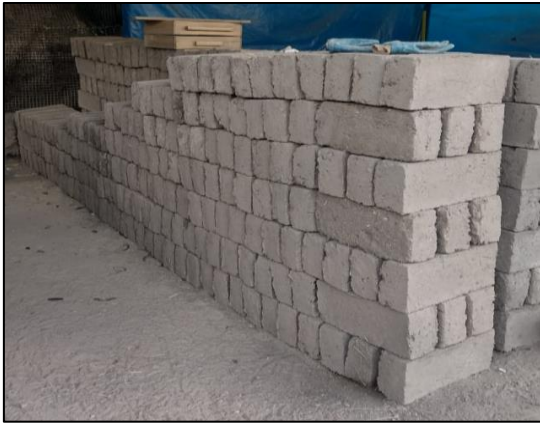
Figura 12. Almacenamiento de los adobes.
