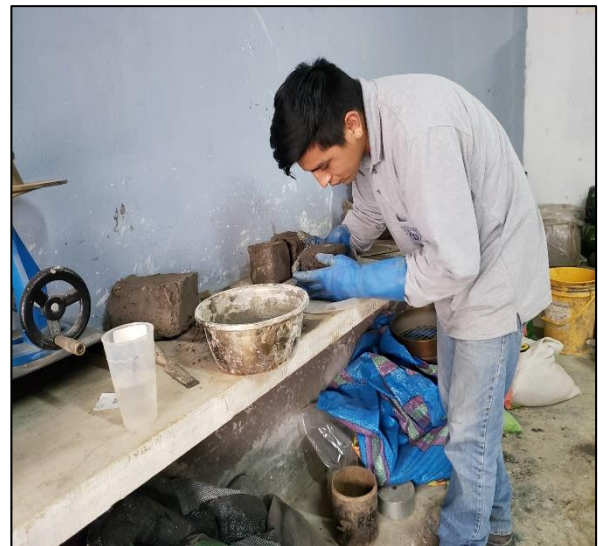
Figura 12. Preparando los Moldes con la adición de (1% y 2%) de paja de cebada y fibra de lana de oveja.
