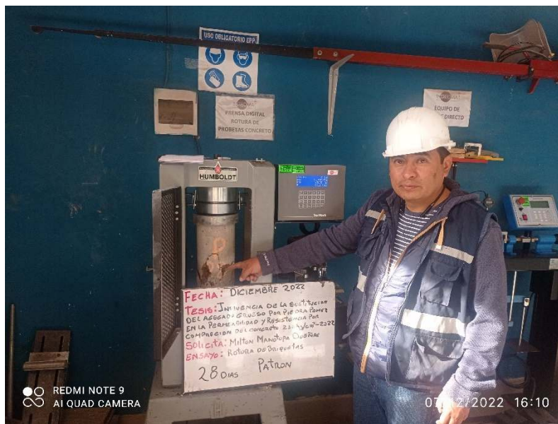
Figura 22 Fotografía de ensayo de compresión a los 28 días
