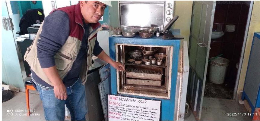
Figura 29 Colocando las muestras de los agregados en el horno para secado
