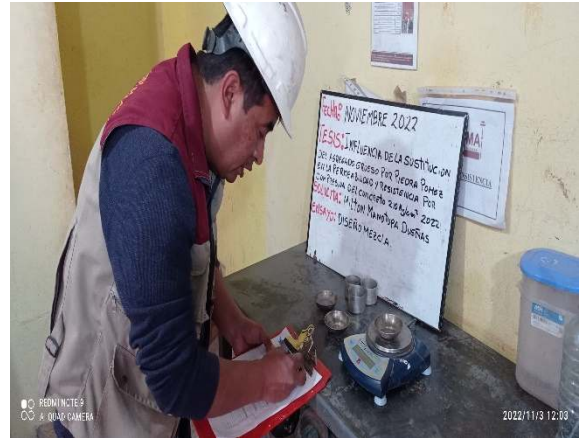
Figura 13 Fotografías del ensayo granulométrico para agregado fino
