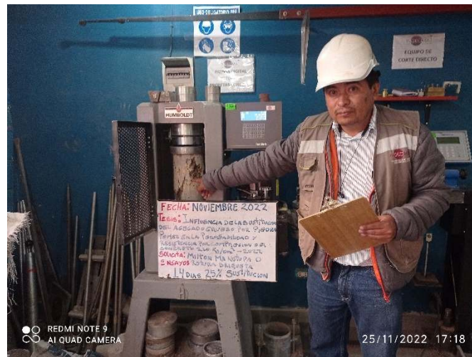
Figura 21 Fotografía de ensayo de compresión a los 14 días
