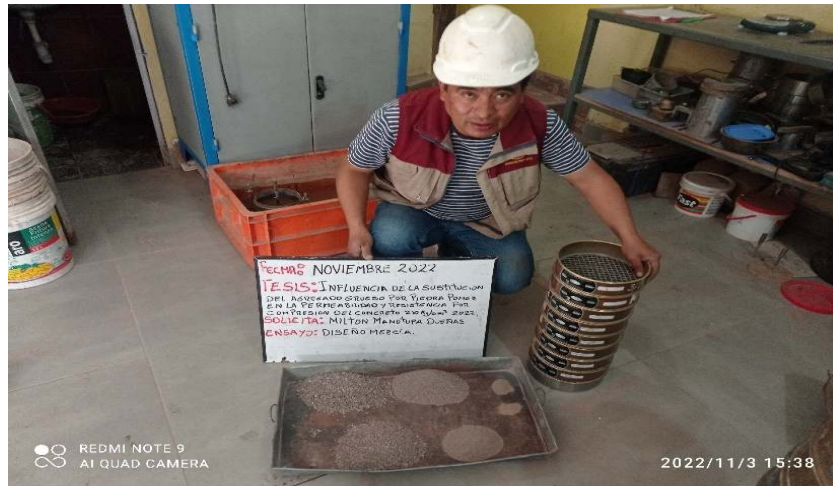
Figura 30 Tamizado de los agregados fino, grueso y piedra pomez
