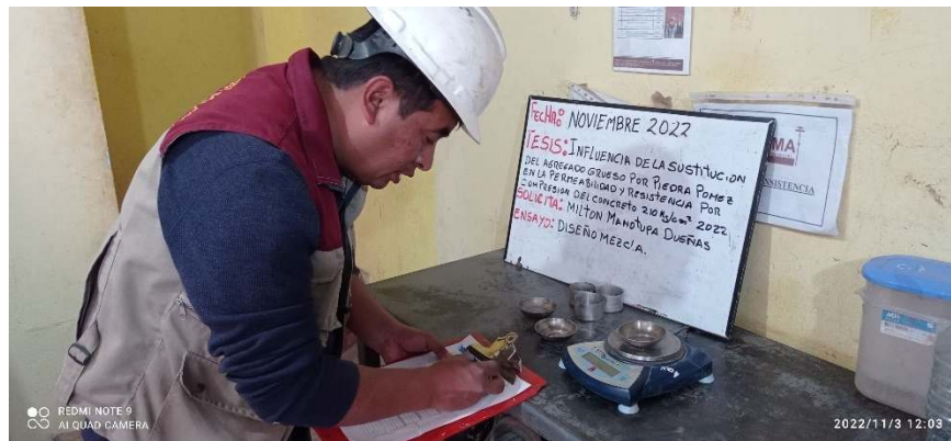
Figura 28 Ensayo para determinar contenido de humedad de los agregados
