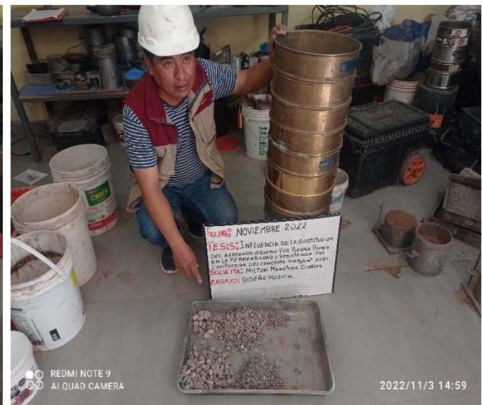
Figura 14 Fotografías de ensayo granulométrico para el agregado grueso y piedra pómez
