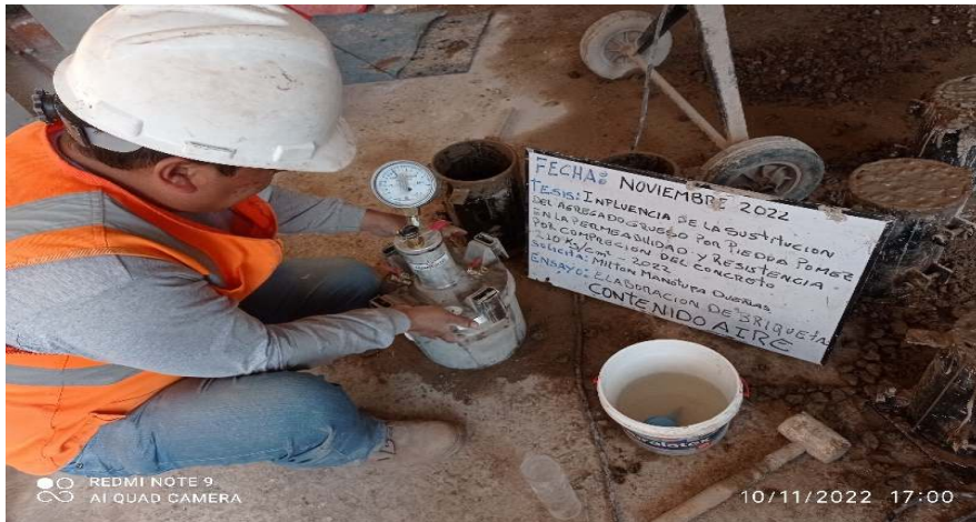
Figura 35 Ensayo para determinar el contenido de aire fresco
