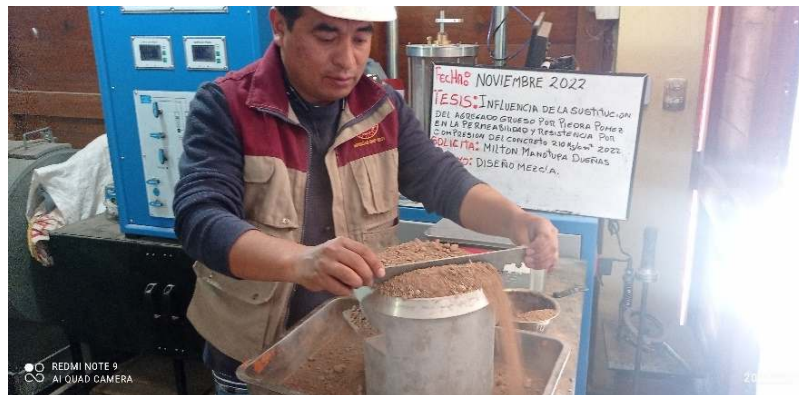
Figura 27 Determinación de peso suelto y compactado para diseño de mezcla
