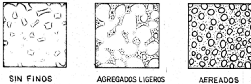
Figura 2 Tipo de concreto en base a los materiales utilizados y localización de aire
