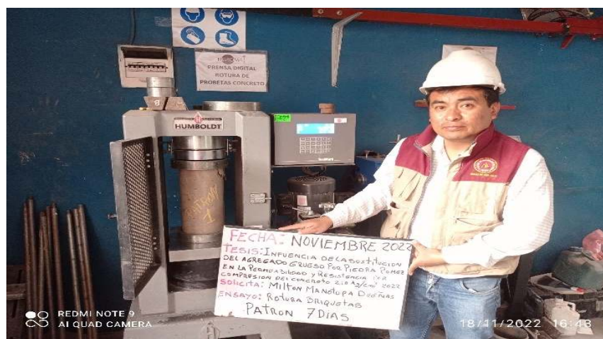
Figura 37 Ensayo de resistencia a la compresión a los 7 días
