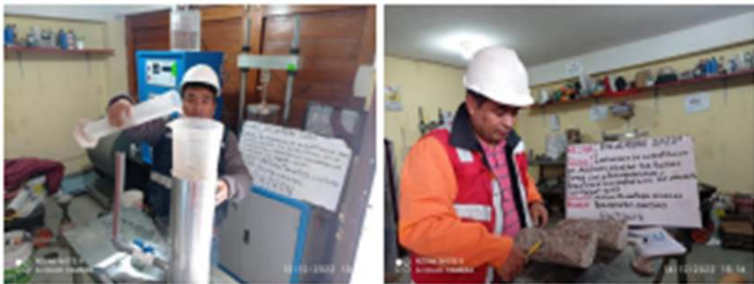
Fotografía 3 y Fotografía 4 Saturado de muestras y medición de longitud saturada.
