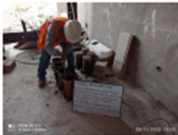
Fotografía 1 Y Fotografía 2 Elaboración de los especímenes de concreto.
