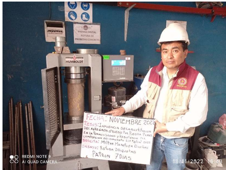
Figura 20 Fotografía de ensayo de compresión a los 7 días
