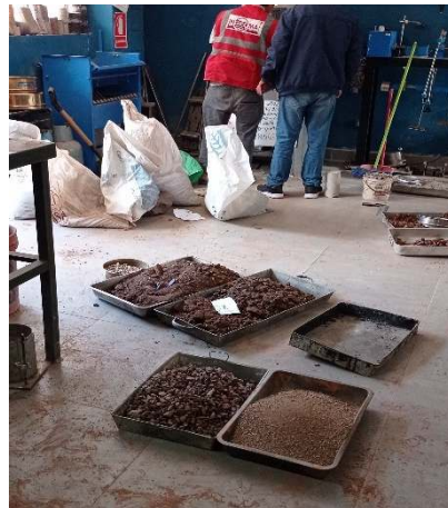
Figura 25 Muestras de los agregados para ensayos de caracterización y diseño de mezcla
