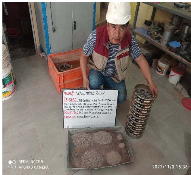
Figura 14 Fotografías de ensayo granulométrico para el agregado grueso y piedra pómez
