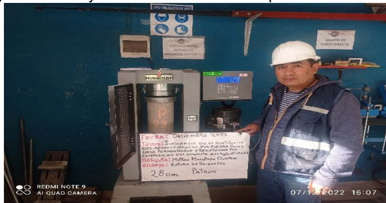
Figura 39 Ensayo de resistencia a la compresión a los 28 días
