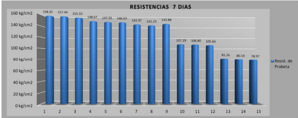
Gráfico 4 Resultados la Evolución de Ensayos de Compresión a los 7 días
