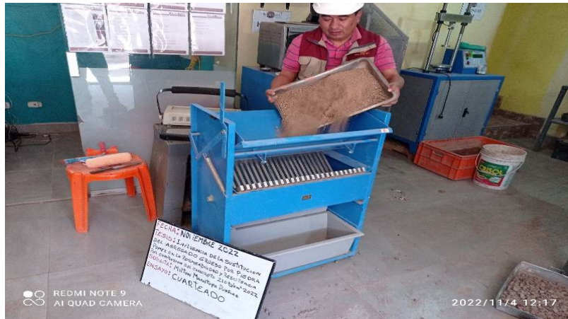
Figura 32 Cuarteado de los agregados finos , gruesos y piedra pómez
