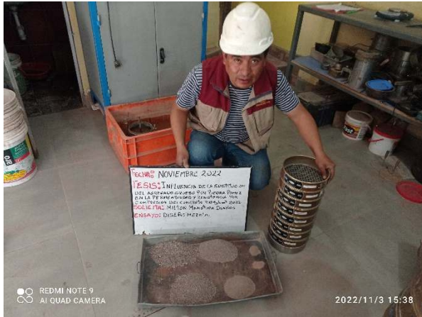
Figura 13 Fotografías del ensayo granulométrico para agregado fino
