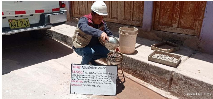
Figura 26 Lavado de material grueso para caracterización de materiales y diseño de mezcla
