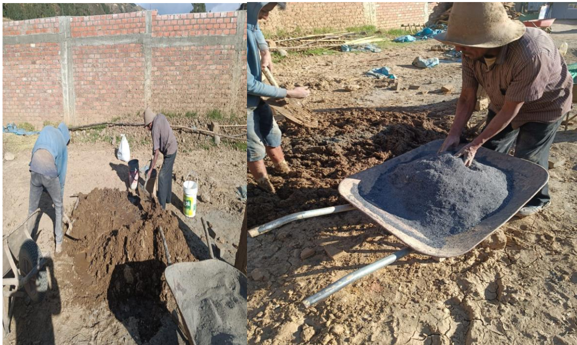
Foto N° 04: Mezclando la ceniza de paja de trigo con la masa de arcilla.
