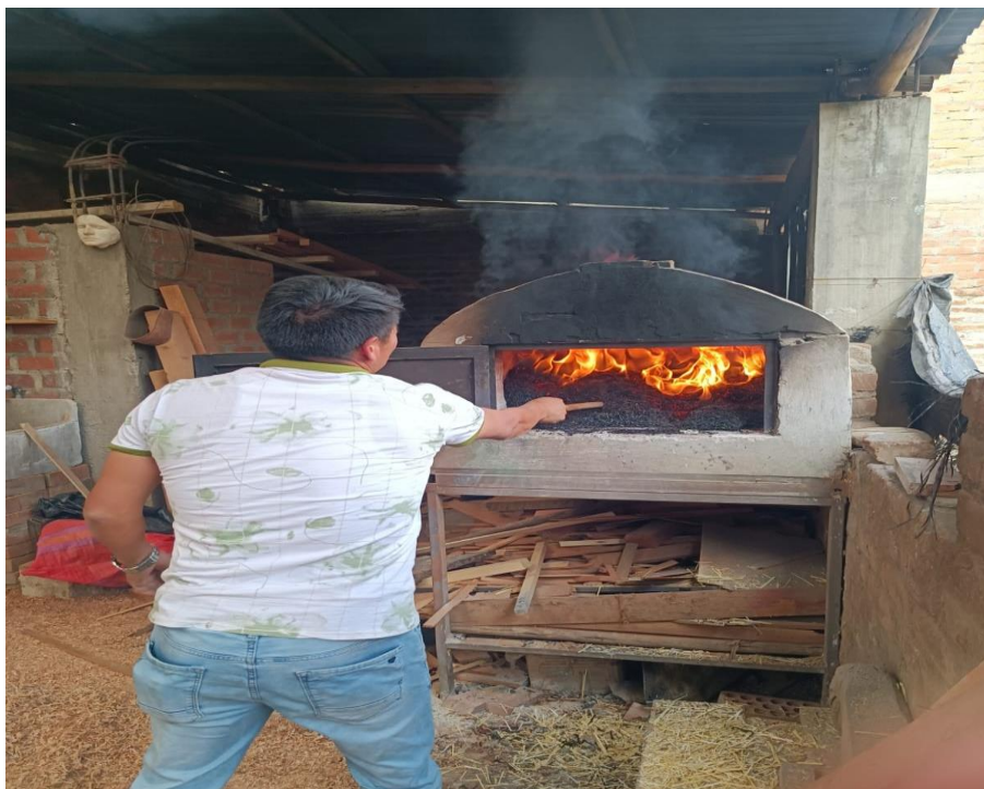
Foto N° 02 Instantes de la incineración de la paja de trigo en un horno.
