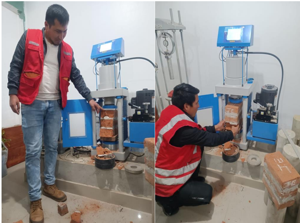
Foto N° 10: Prueba de resistencia a la presión axial de pilas.
