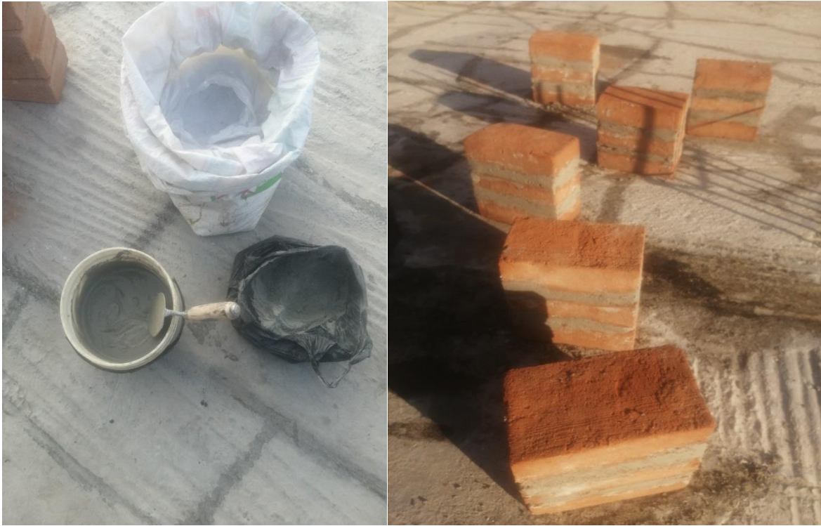
Foto N° 07: Elaboración de las pilas de ladrillo para la prueba de resistencia a presión axial de pilas
