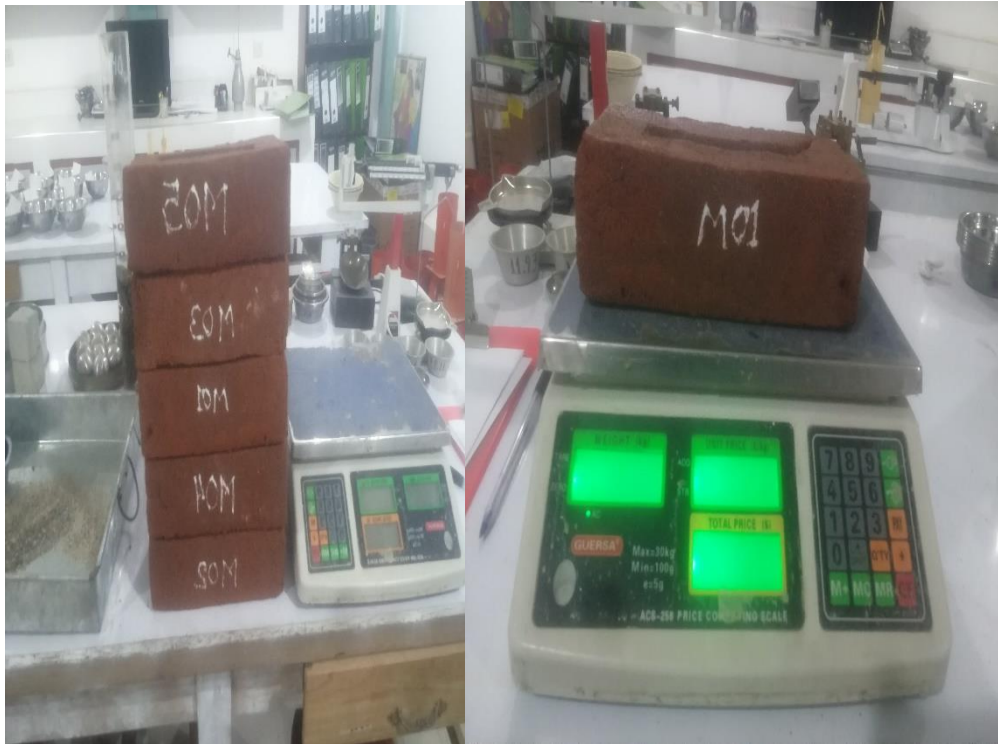
Foto N° 09: Prueba de absorción
