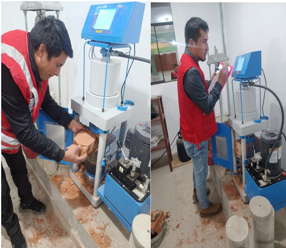
Foto N° 08: Prueba a resistencia a la compresión.
