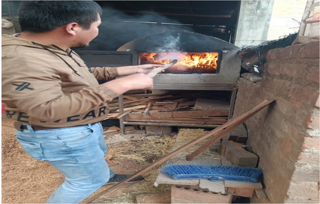
Foto N° 03 Instantes de la incineración de la paja de trigo en un horno.
