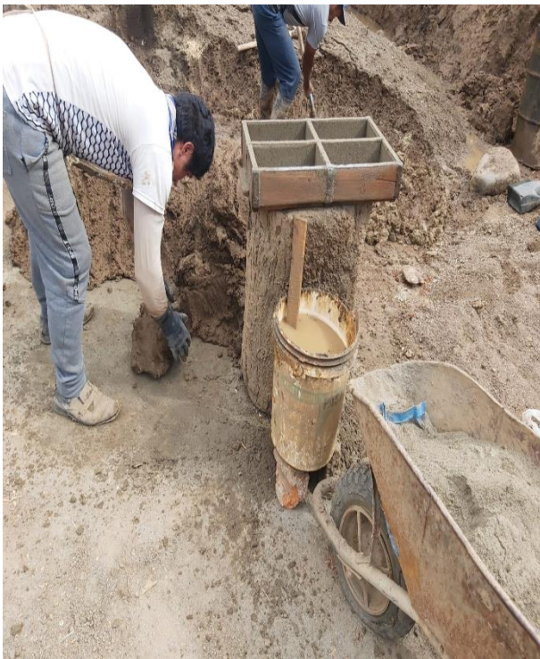
Fotografía 22 y 23: Elaborando los ladrillos artesanales al 5% de Ichu luego su aplica su moldeada.
