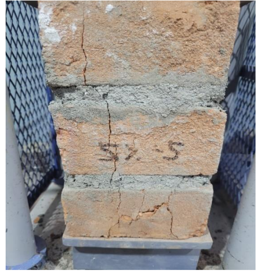
Fotografía 54: Ensayo de resistencia a compresión axial en pilas con la muestra número 5 con una sustitución al 5% de Ichu con una carga de rotura de 28,060kg.
