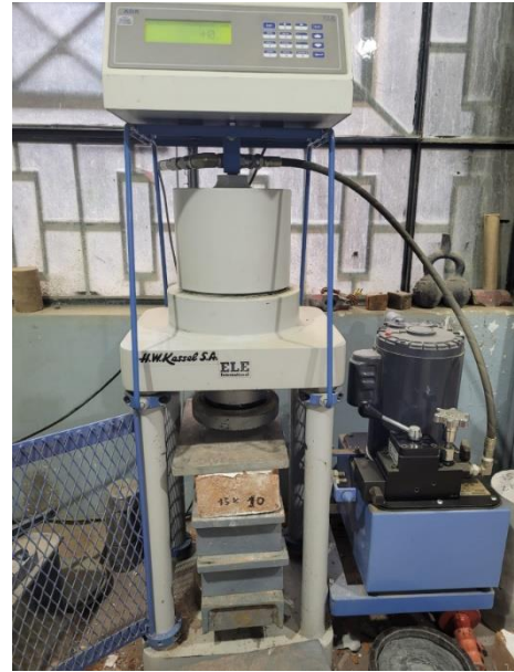
Fotografía 50: Ensayo de la resistencia a compresión con sustitución al 15% de Ichu de la muestra número 10 con carga 0.
