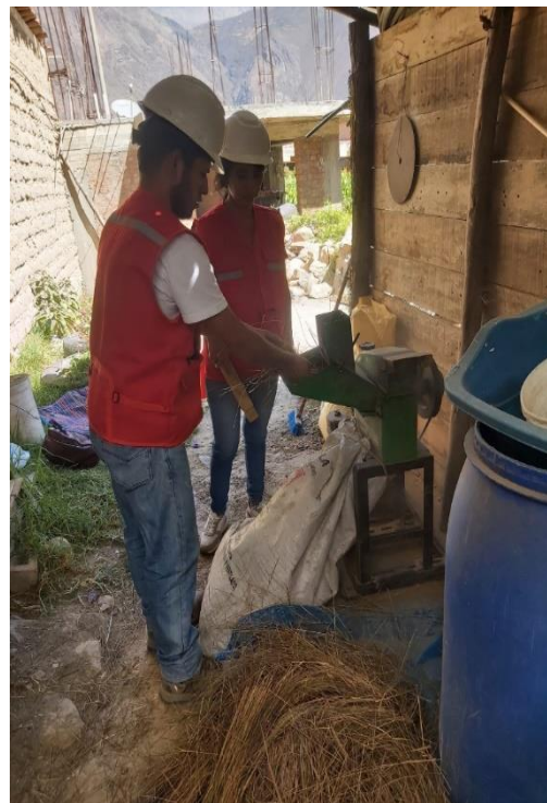
Fotografía 6 y 7: Introduciendo el Ichu en la maquina moledora para obtener nuestro Ichu molido
