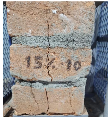
Fotografía 56: Ensayo de resistencia a compresión axial en pilas con la muestra número 10 con una sustitución al 15% de Ichu con una carga de rotura de 30,560kg.
