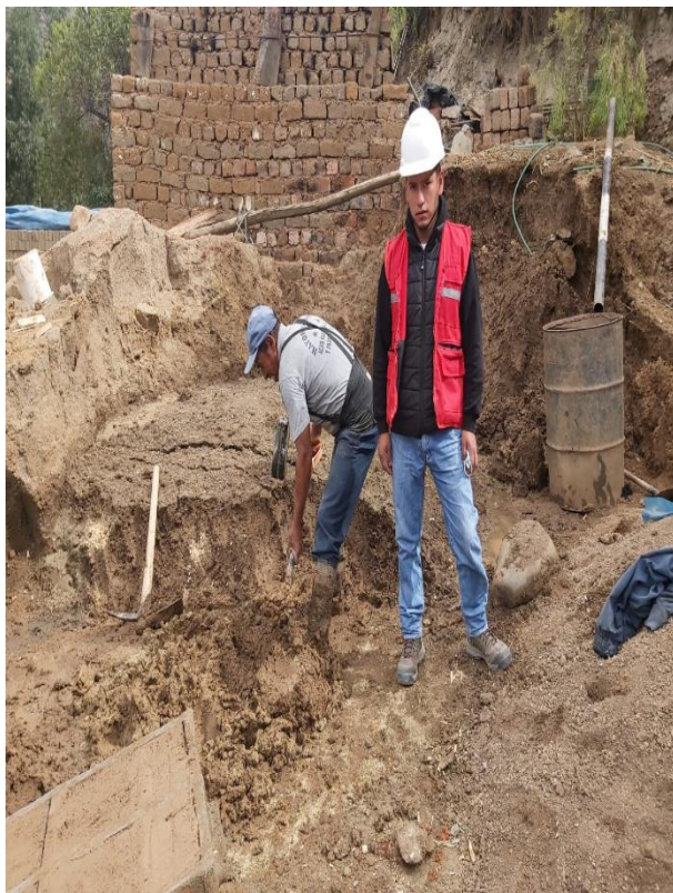
Fotografía 26 y 27: Elaborando el ladrillo artesanal con adición al 15% de Ichu
