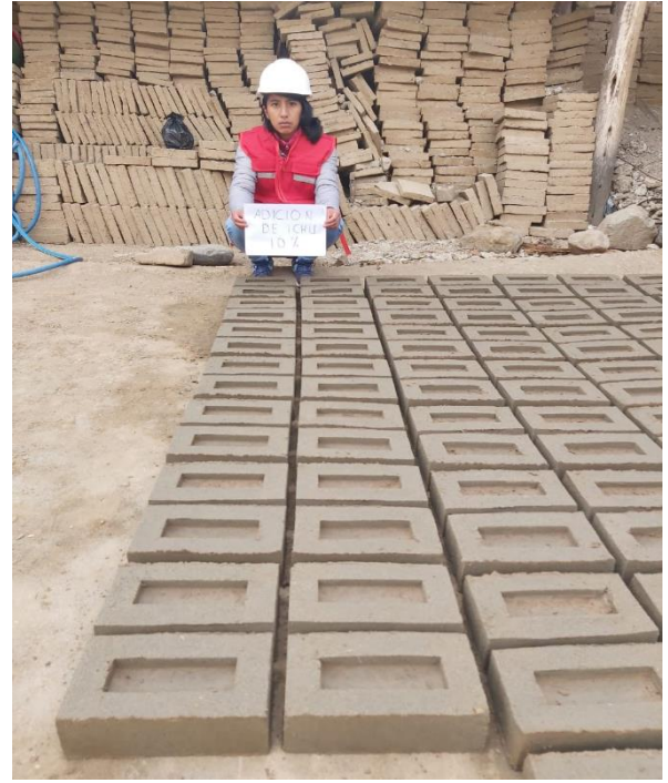
Fotografía 31 y 32: Secado del ladrillo artesanal con adición al 5% y 10% Ichu
