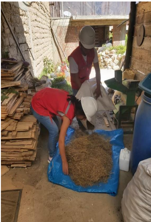
Fotografía 6 y 7: Introduciendo el Ichu en la maquina moledora para obtener nuestro Ichu molido
