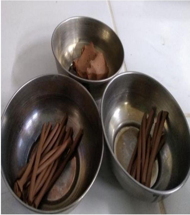
Fotografía 39 y 40: Determinar el límite plástico se elaboran rollos de suelo 3 mm.
