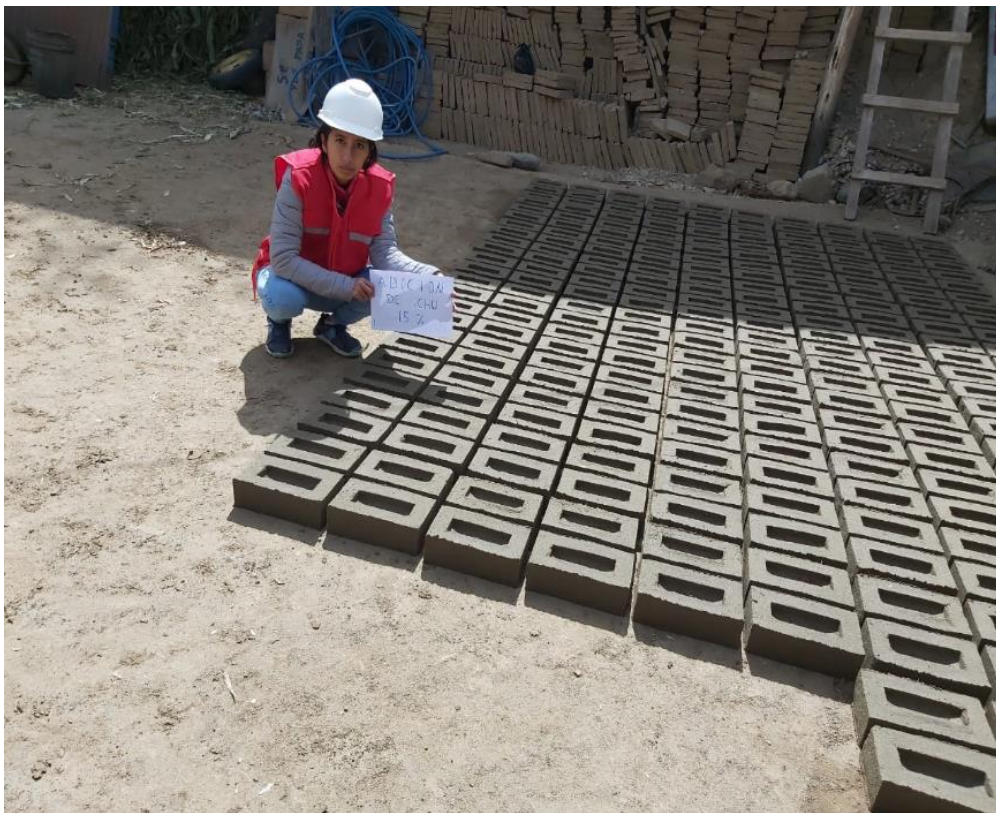
Fotografía 33: Secado del ladrillo artesanal con adición al 15% Ichu
