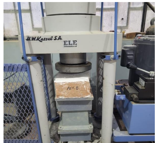
Fotografía 48: Ensayo de la resistencia a compresión con sustitución al 10% de Ichu en la muestra número 8.
