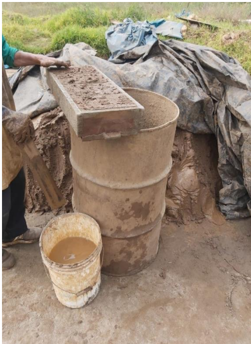
Fotografía 14 y 15: Elaboración, moldeado y secado del ladrillo patrón
