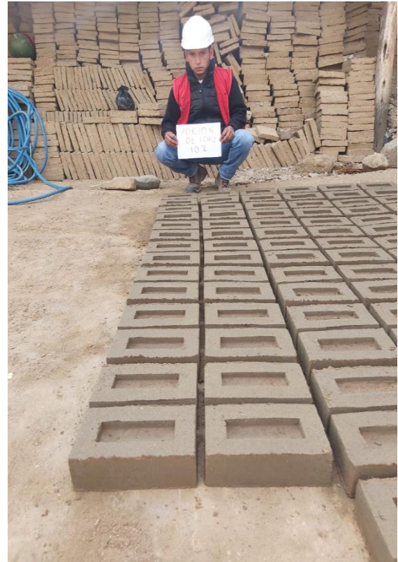
Fotografía 28 y 29: Secado del ladrillo artesanal con adición al 5% y 10% Ichu
