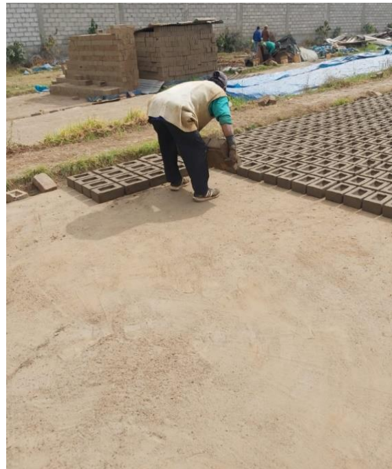
Fotografía 14 y 15: Elaboración, moldeado y secado del ladrillo patrón
