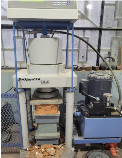
Fotografía 49: Ensayo de la resistencia a compresión con sustitución al 10% de Ichu en la muestra número 8 con una carga de rotura 22,810kg.
