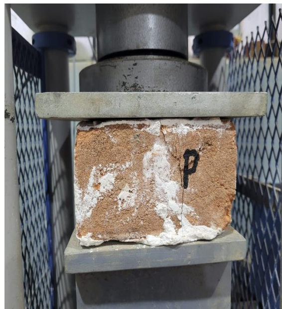
Fotografía 43 y 44: Ensayo resistencia a compresión del ladrillo artesanal (Patrón)
