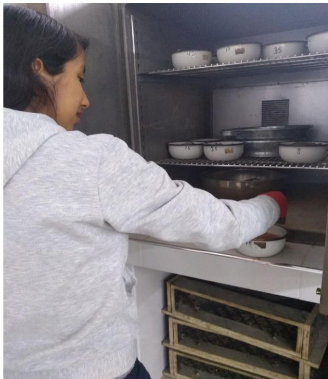
Fotografía 41: Poniendo al horno los especímenes.
