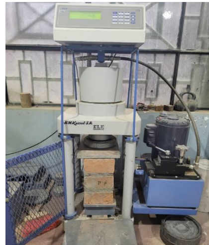
Fotografía 52: Ensayo de resistencia a compresión axial en pilas con la muestra número 7 del patrón con una carga de rotura de 0.
