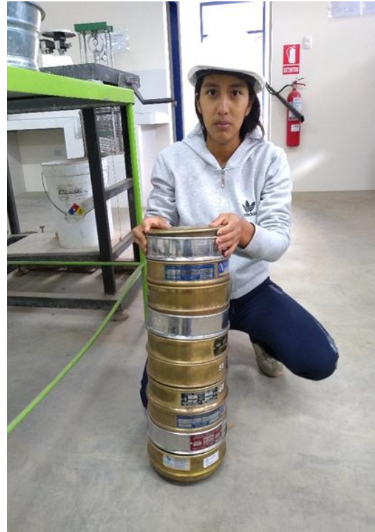
Fotografía 36 y 37: Determinan los porcentajes retenidos parciales y se expresa la granulometría en función de dichos porcentajes.
