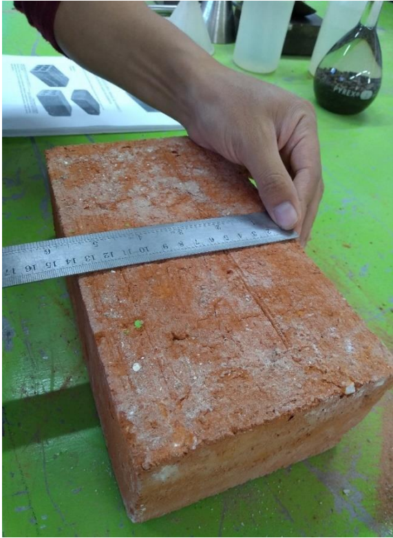
Fotografía 42: Determinar las medidas de largo ancho y alto para los ensayos de resistencia a compresión del ladrillo artesanal.
