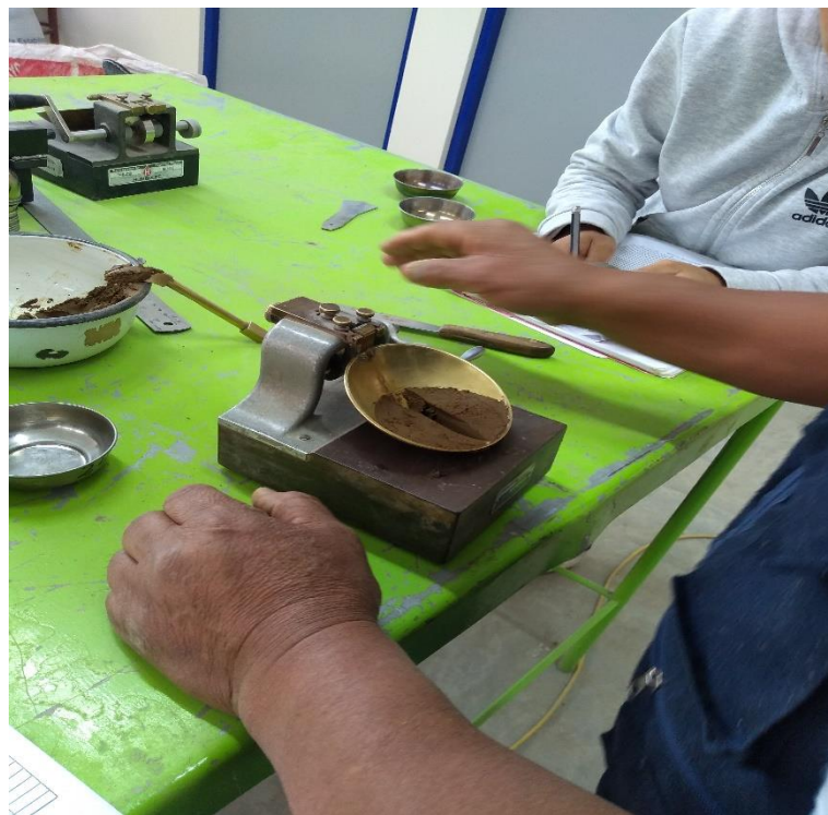
Fotografía 38: Ensayo para determinar los límites líquidos según el método de cono de penetración
