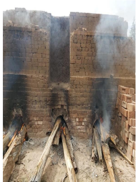
Fotografía 16 y 17: Secado del ladrillo patrón y quemado del ladrillo Artesanal
