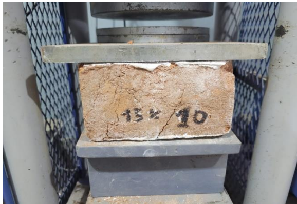
Fotografía 51: Ensayo de la resistencia a compresión con sustitución al 15% de Ichu de la muestra número 10 con carga de rotura 25,160kg.
