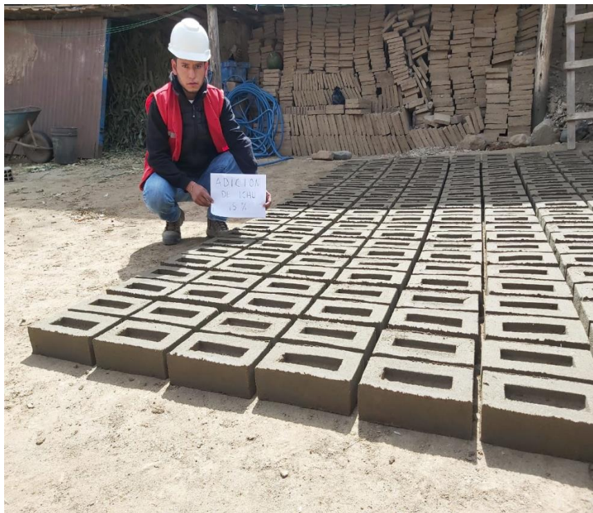
Fotografía 30: Secado del ladrillo artesanal con adición al 15% Ichu
