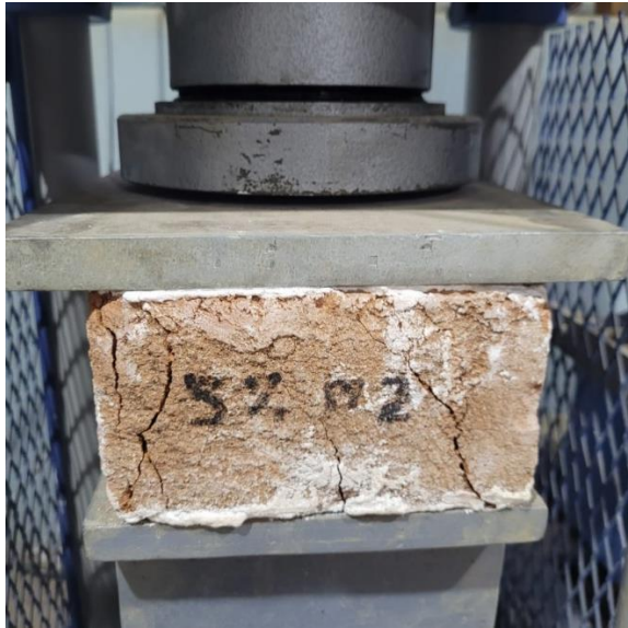
Fotografía 45: Ensayo resistencia a la compresión con la sustitución al 5% de Ichu
