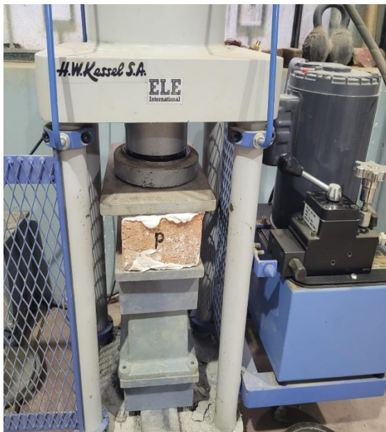
Fotografía 43 y 44: Ensayo resistencia a compresión del ladrillo artesanal (Patrón)
