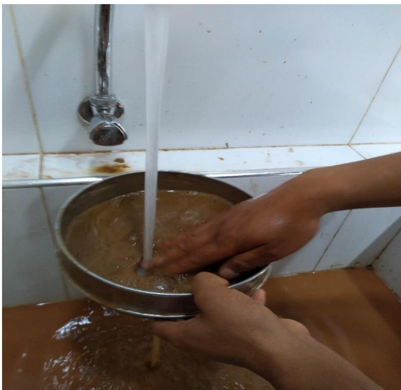
Fotografía 35: Se realiza con la prueba de lavado en malla No. 200.
