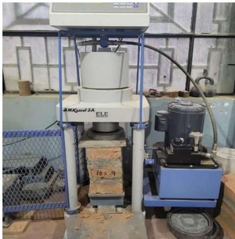
Fotografía 55: Ensayo de resistencia a compresión axial en pilas con la muestra número 9 con una sustitución al 10% de Ichu con una carga de rotura de 29,050kg.
