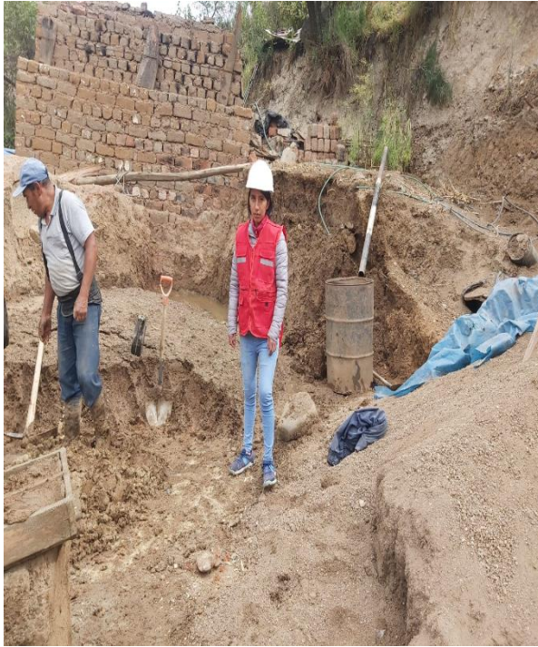
Fotografía 24 y 25 Elaborando el ladrillo artesanal con adición de 10% de Ichu.
