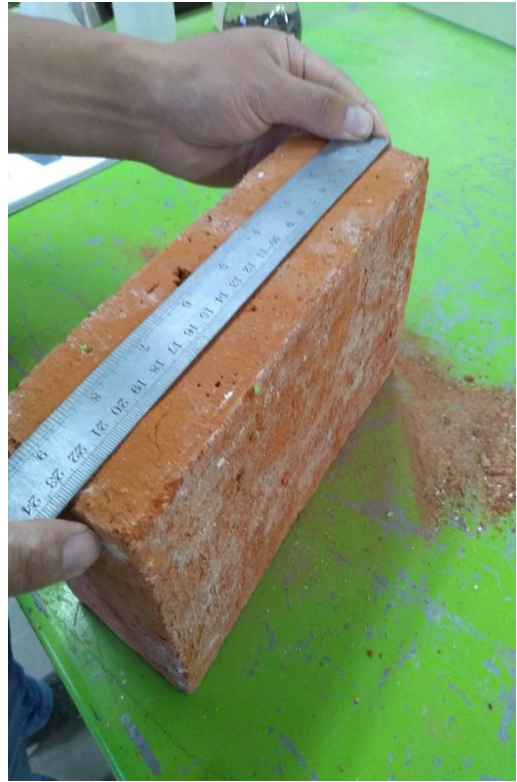
Fotografía 42: Determinar las medidas de largo ancho y alto para los ensayos de resistencia a compresión del ladrillo artesanal.
