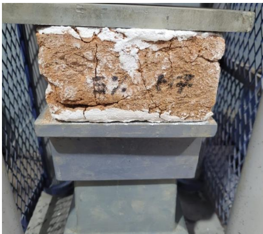
Fotografía 47: Ensayo de resistencia a la compresión en la muestra 7 con adición al 5% de Ichu se rompe a una carga de rotura 22,890 kg.
