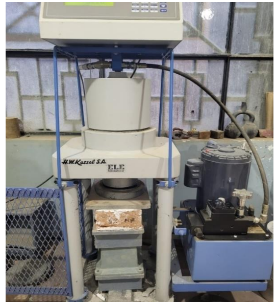
Fotografía 46: Ensayo de la muestra número 7 con la sustitución del 5% de Ichu.
