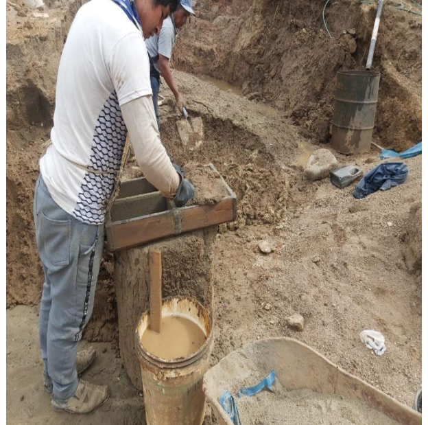
Fotografía 20 y 21: Elaborando los ladrillos artesanales Patrón.
