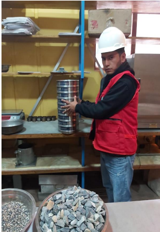
Fotografía 36 y 37: Determinan los porcentajes retenidos parciales y se expresa la granulometría en función de dichos porcentajes.
