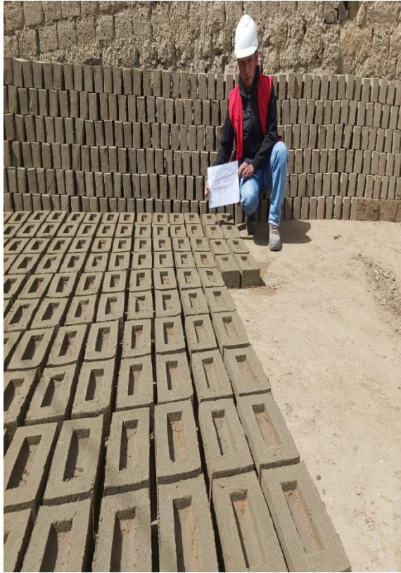
Fotografía 28 y 29: Secado del ladrillo artesanal con adición al 5% y 10% Ichu
