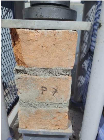
Fotografía 53: Ensayo de resistencia a compresión axial en pilas con la muestra número 7 del patrón con una carga de rotura de 26,740kg.
