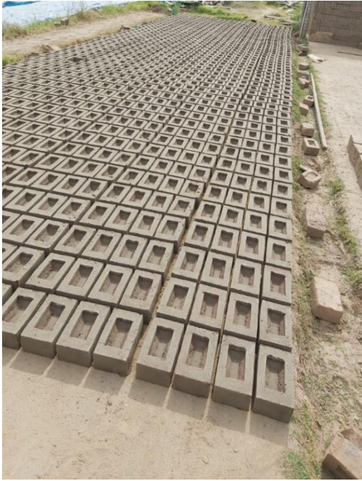
Fotografía 16 y 17: Secado del ladrillo patrón y quemado del ladrillo Artesanal
