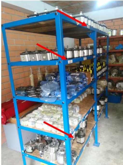
Figura 47. Se observa tarjetas de identificación de componentes por ubicación
