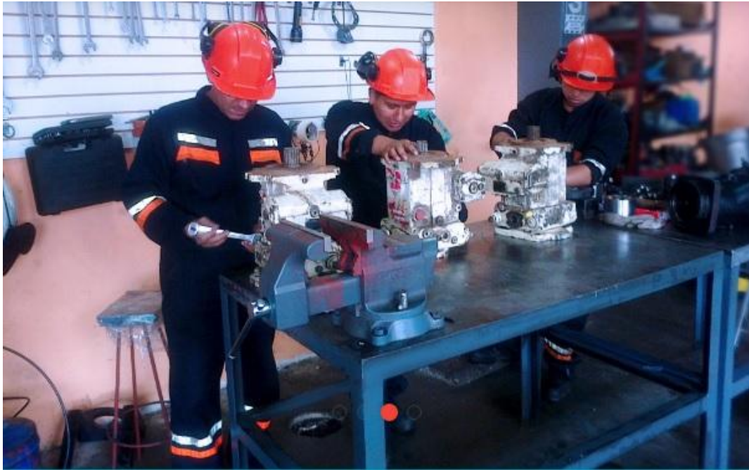
Figura 10. Área de Mantenimiento - Proceso para desarmar las bombas o motores, retirando pieza por pieza para luego analizar los problemas en la bomba o motor, y proceder a solicitar en área de almacén el registro de componentes para ser llenado por el técnico
