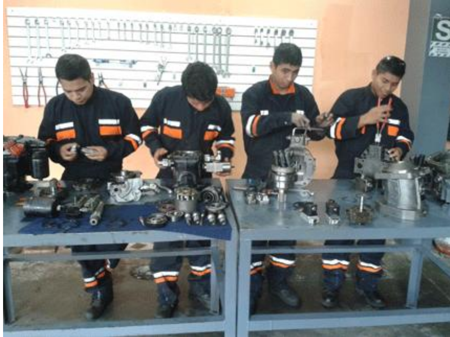
Figura 23. Los técnicos desarmando Bombas /motores para luego solicitar el registro de componentes en el área de almacén
