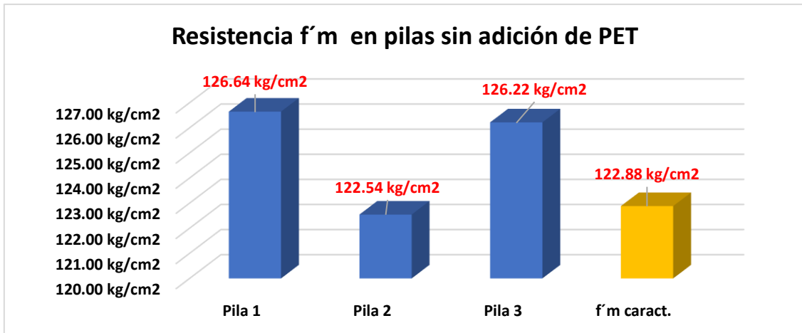
Figura 23. Comparación de f'm sin adición de PET en el mortero
