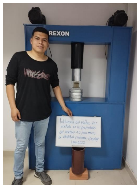
Figura 15. Rotura de dados de mortero Fuente: Elaboración propia
