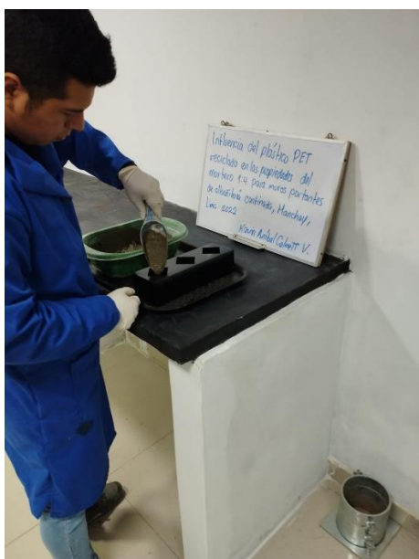
Figura 14. Elaboración de dados Fuente: Elaboración propia
