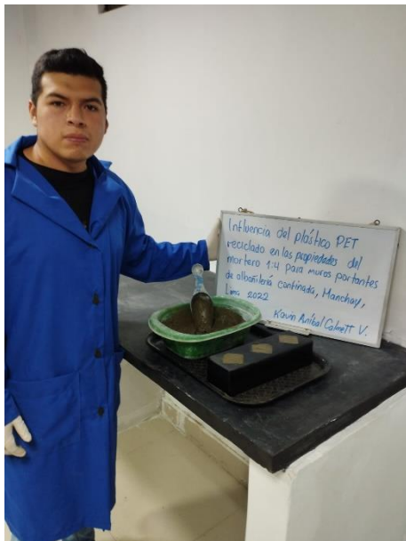
Elaboración de cubos de mortero
