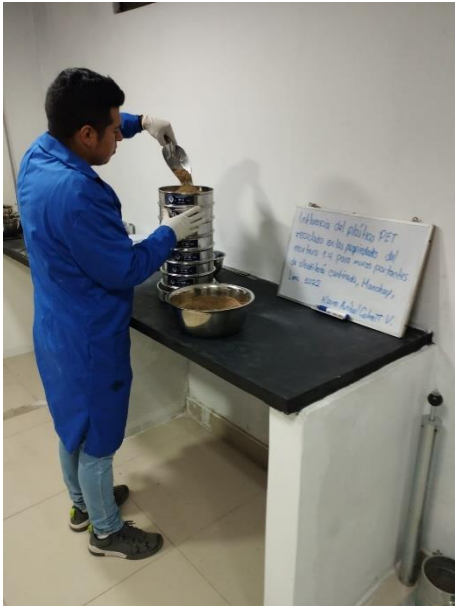
Tamizado del agregado
