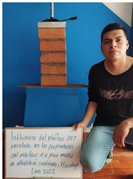
Figura 22. Prueba de f'm Fuente: Elaboración propia
