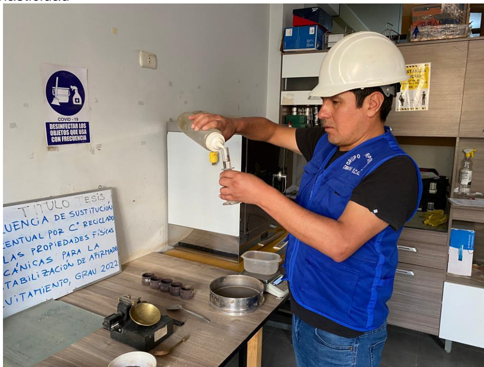
Fotografía 10. De la muestra obtenida se le agrega agua para determinar la plasticidad
