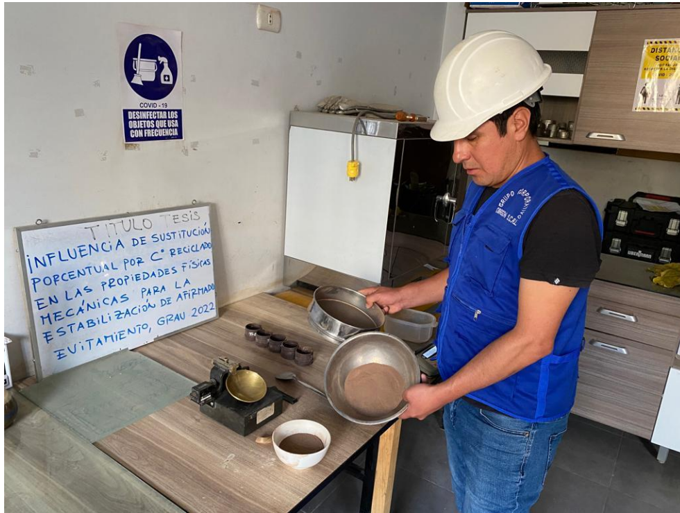
Fotografía 10. De la muestra obtenida se le agrega agua para determinar la plasticidad
