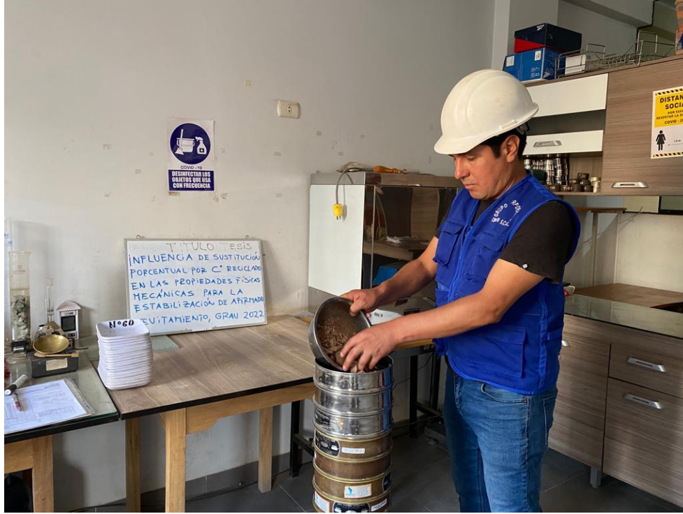
Fotografía 5. La muestra de la cantera es seleccionada en los tamizes
