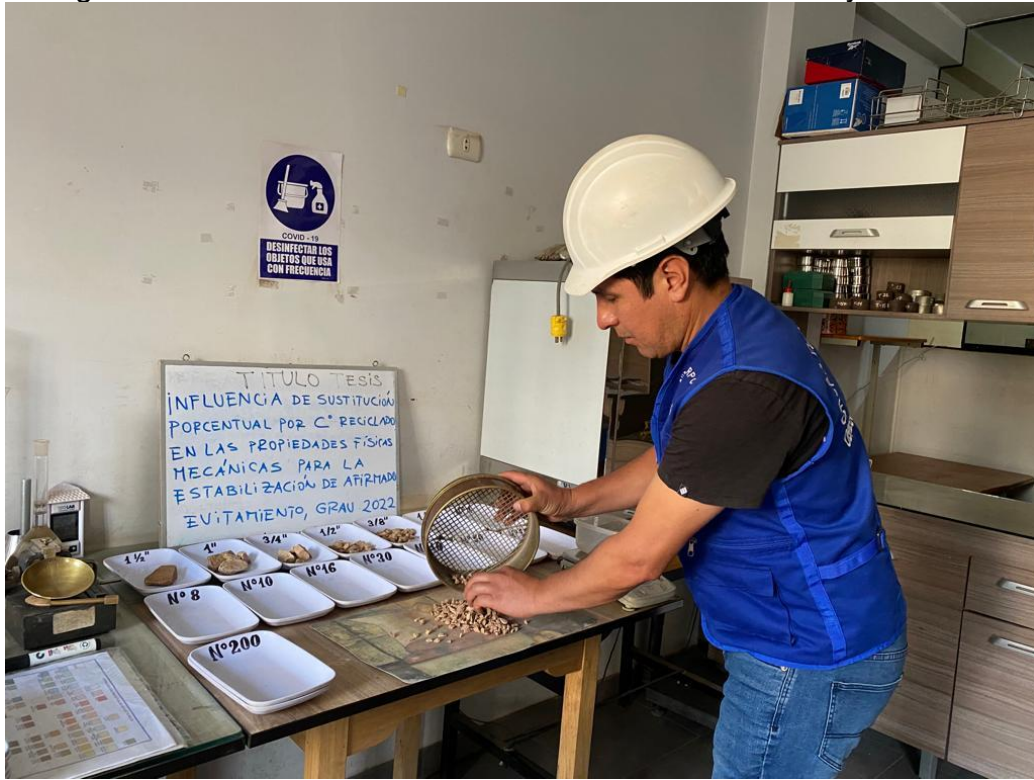
Fotografía 7. Una vez seleccionado la muestra se distribuye en sus números
