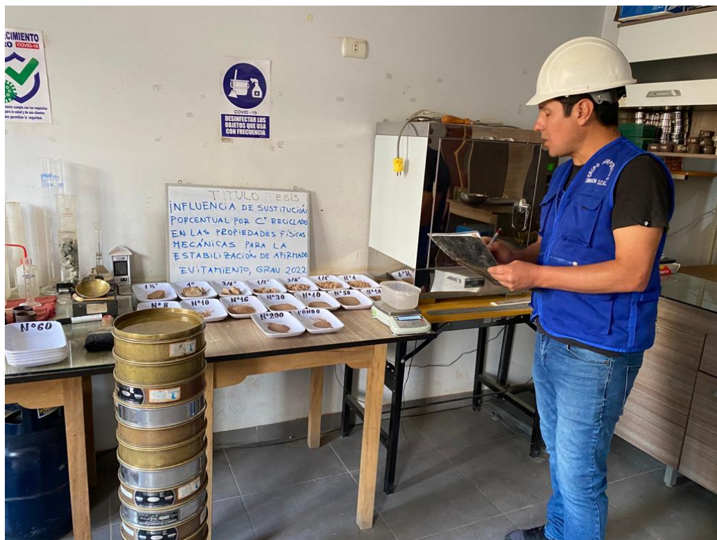
Fotografía 8. Se selecciona la muestra que pasa el tamiz # 40
