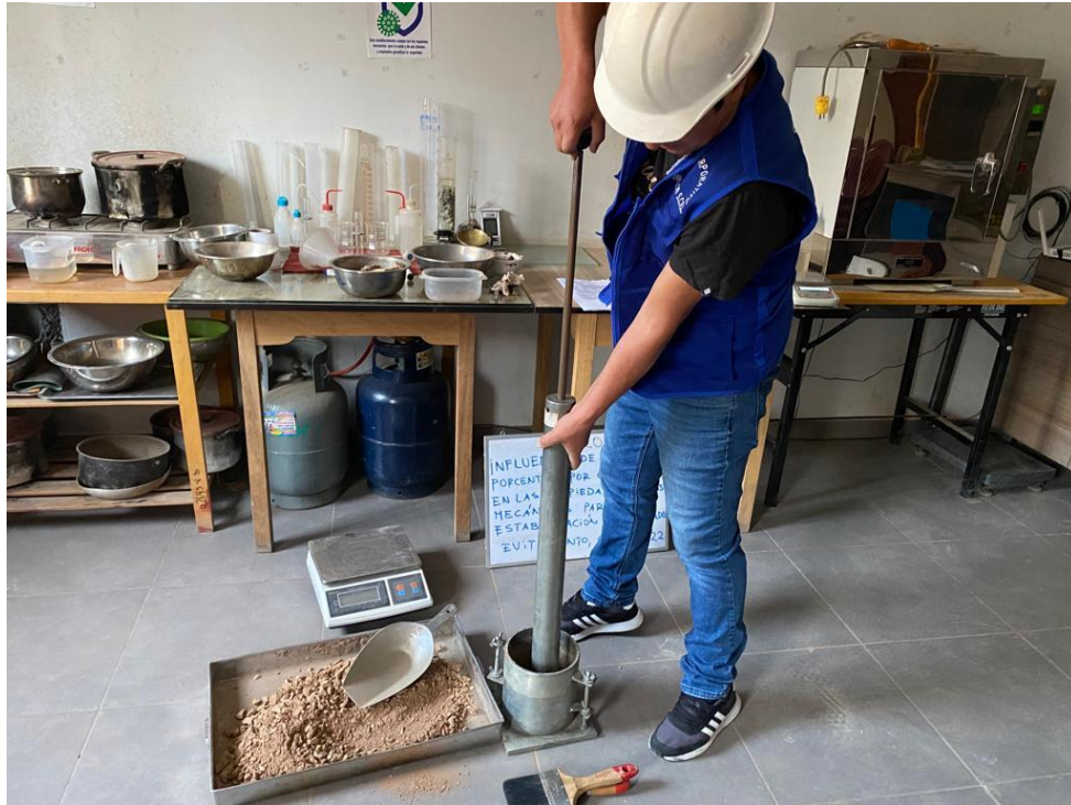
Fotografía 16. Con los respectivos golpes con el piezómetro para continuar con los ensayos del CBR en la prensa hidráulica
