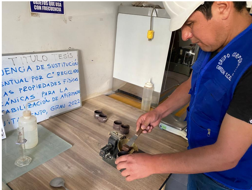
Fotografía 14. Se obtiene el ensayo del índice de plasticidad
