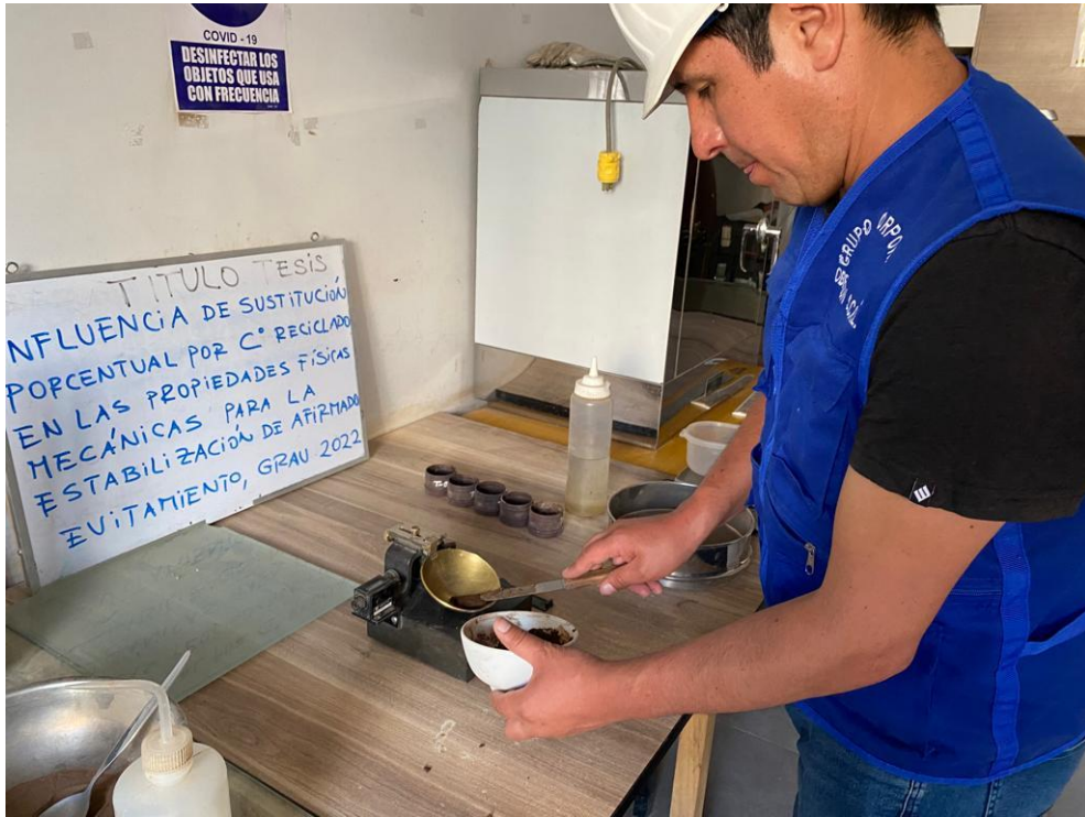
Fotografía 11. Se realiza la determinación del ensayo de la plasticidad de la muestra
