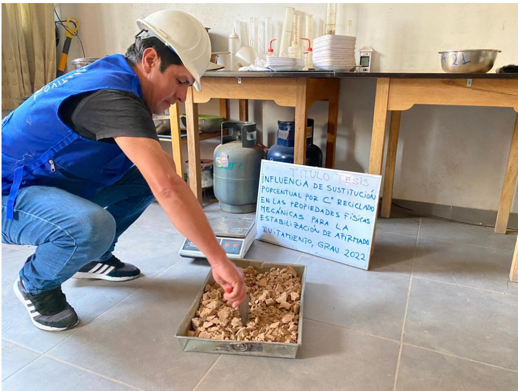
Fotografía 4. División de la muestra de la cantera
