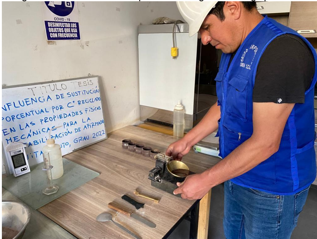
Fotografía 12. Se determina la plasticidad según al # de golpes de la muestra
