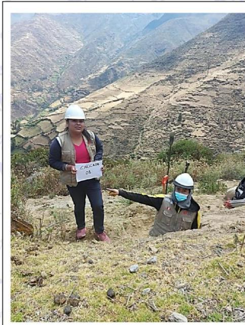
**Foto N°01:** Vista de ubicación de la C-01, presencia de Arena Limosa (SM) de consistencia compacta, húmeda y de color beige claro de 0.00 a 1.50m.
