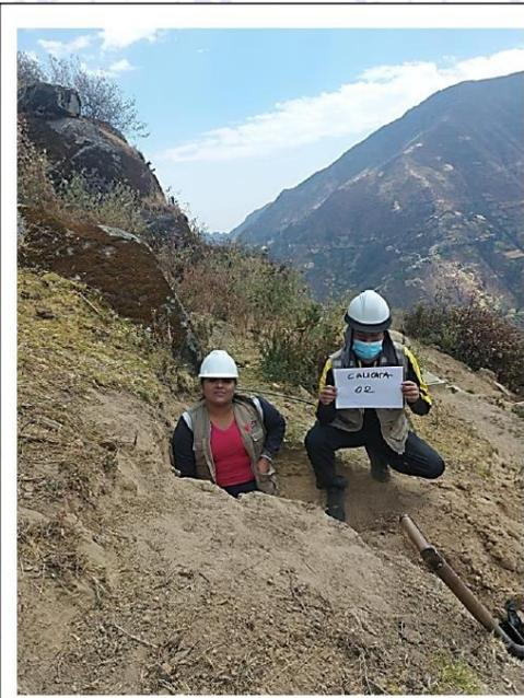
**Foto N°02:** Vista de ubicación de la C-02, presencia de Arena Limosa (SM) de consistencia compacta, húmeda a saturada y de color beige claro de 0.00 a 1.50m.
