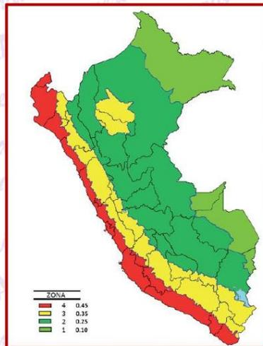
Figura N° 04: Zonificación Sísmica del Perú Según el Reglamento Nacional de Edificaciones.
