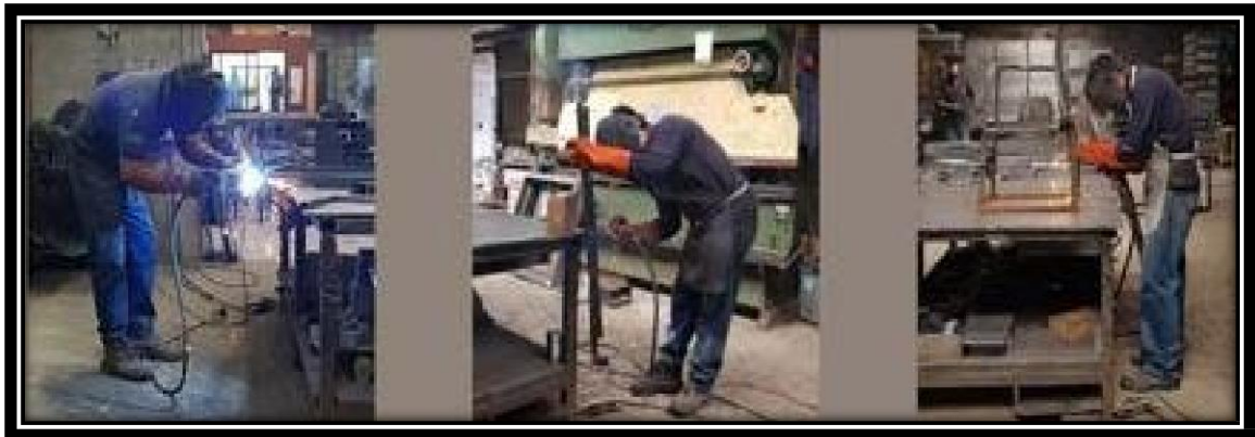
Figura 6. Evidencia de carencia de mesas elevadoras
