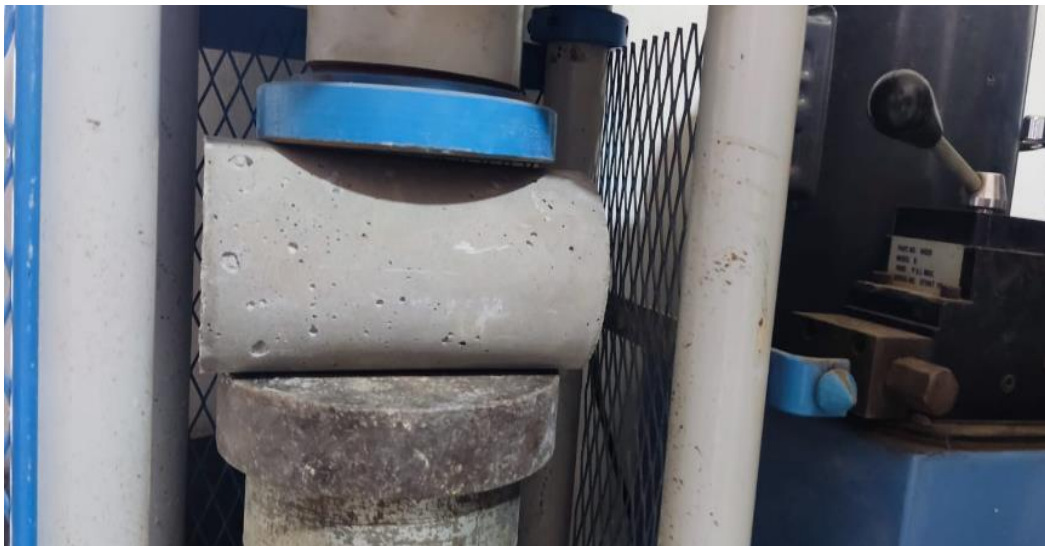
Figura 6. Ensayo a tracción del concreto patrón.
