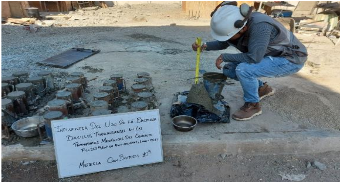
Figura 7. Uso del Cono de Abrams para determinar el slump.
