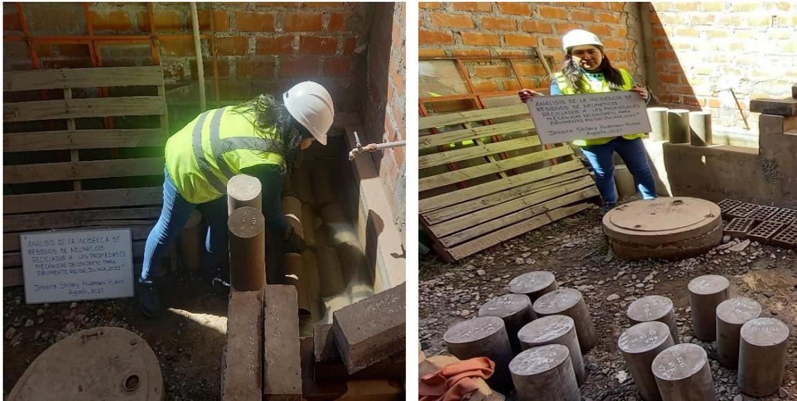
Figura 8: Curado de briquetas y viguetas.
