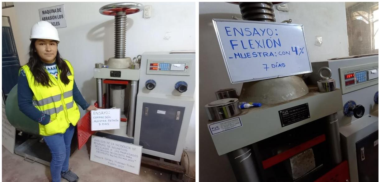
Figura 9: Ensayo de resistencia a la compresión y ensayo de resistencia a la flexión con 7 días de curado.
