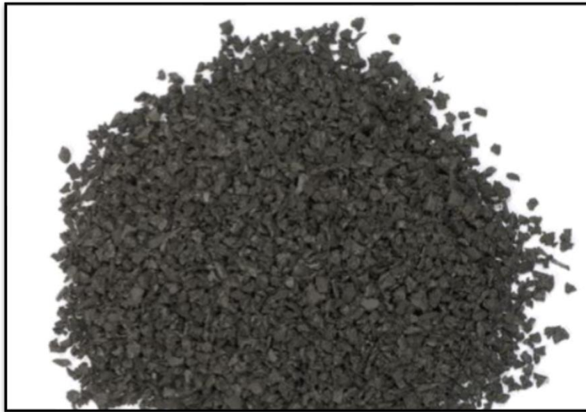
Figura 2. Viruta de neumático reciclado (4mm a 6mm).
