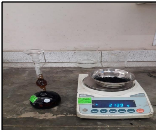
Figura 14. Peso específico del neumático reciclado.
