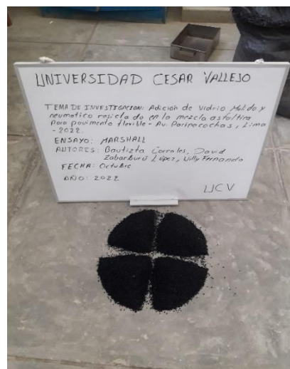
Neumáticos reciclados granular seleccionado para ser llevado a ensayos laboratorio.
