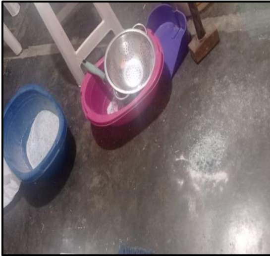
Figura 8. Trituración del vidrio molido manualmente.
