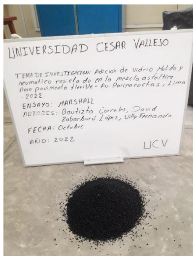
Neumático reciclado granulado puesto en laboratorio.
