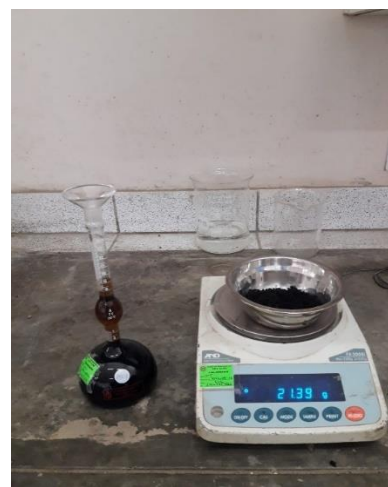
Ensayo de Gravedad específica en frasco Lechatelier
