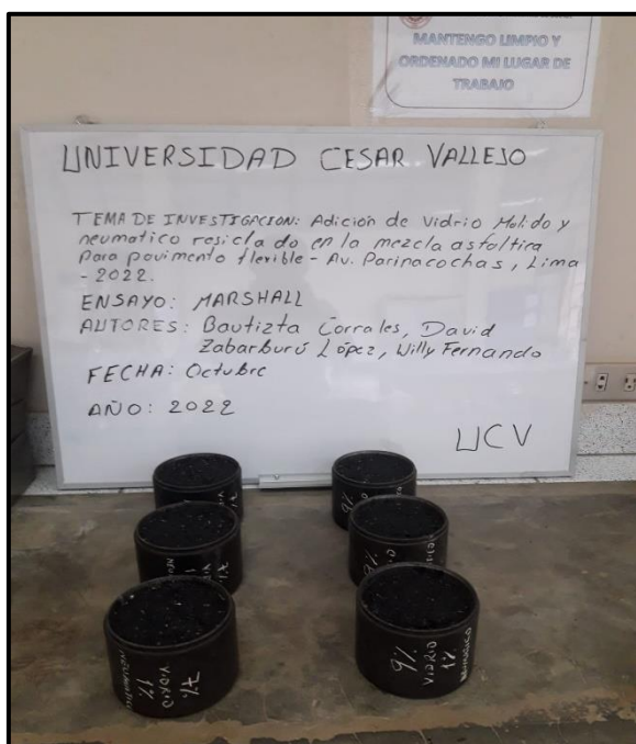
Figura 22. Briquetas con adición de vidrio molido y neumáticos reciclados.
