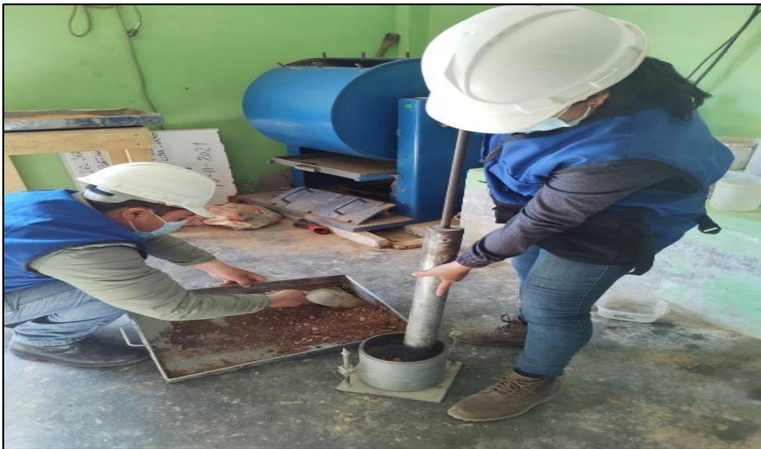
**Figura 20: Ensayo CBR.**
