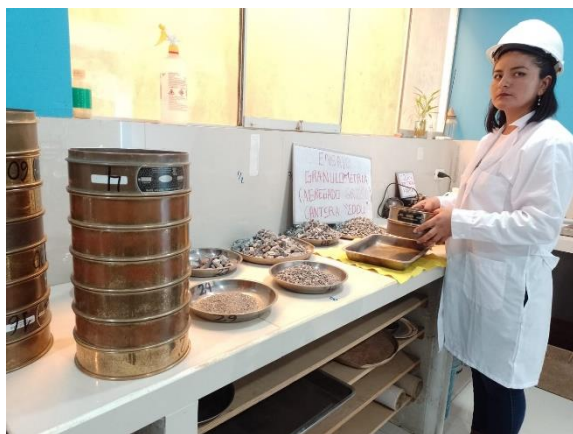
FOTO 03: realización de trabajos de granulometría del agregado grueso
