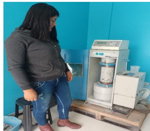
FOTO 24: desarrollo de rotura de briquetas a los 28 días y 14 días respectivamente de concreto con 0 % de fibras
