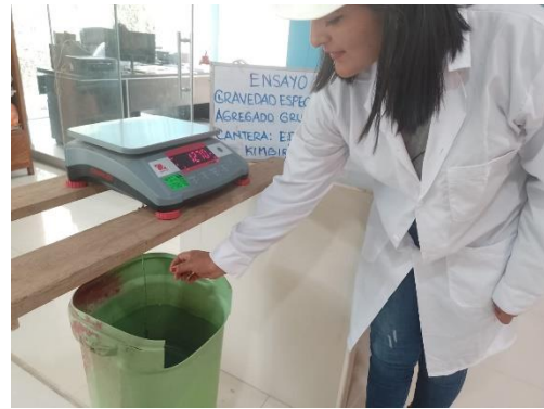
FOTO 10: desarrollo del peso específico del agregado grueso de la cantera “EDDU”.
