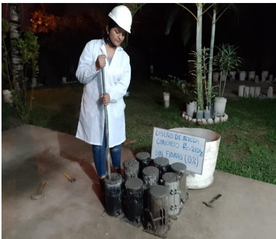
FOTO 17: desarrollo del moldeo y perfilado de las briquetas con concreto con 0% de fibras de botellas de plástico
