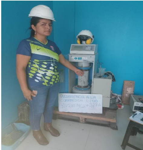
FOTO 28: desarrollo de rotura de briquetas a los 14 y 28 días de concreto con 3% de fibras de botellas de plástico.
