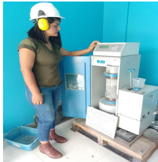
FOTO 23: desarrollo de rotura de briqueta a los 7 días con 0 % de fibra de botellas de plástico reciclado
