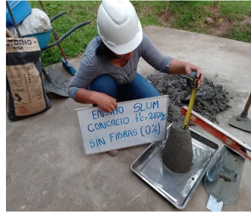
FOTO 16: desarrollo de la prueba slum en concreto f'c=280 \text{ Kg/cm}^2 con 0% de fibras de botellas de plástico.
