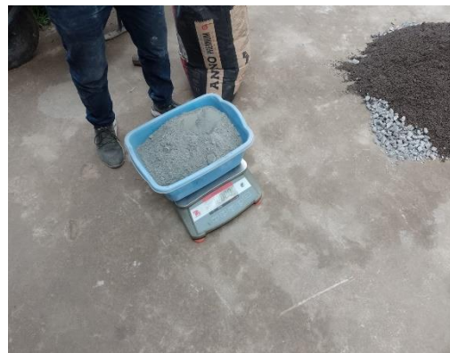
FOTO 14: Se utilizó cemento andino, agregado fino y grueso, se pesó de acuerdo a las cantidades requeridas.
