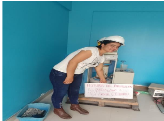
FOTO 27: desarrollo de rotura de briquetas a los 7 de concreto con 3% de fibras de botellas de plástico.
