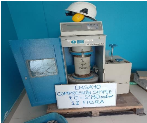
FOTO 25: desarrollo de rotura de briquetas a los 28 días de edad de concreto con 1% de fibras de botellas de plástico.
