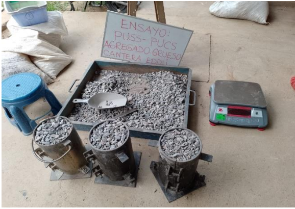
FOTO 07: Desarrollo de ensayo de peso unitario seco compactado agregados gruesos de la cantera "EDDU".
