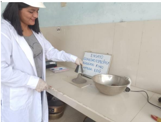
FOTO 11: desarrollo del peso específico en agregados fino de la cantera “EDDU”.
