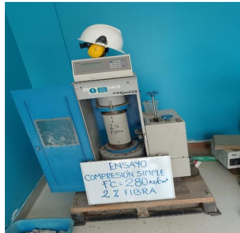
FOTO 26: desarrollo de rotura de briquetas a los 28 días de edad de concreto con 2% de fibras de botellas de plástico.
