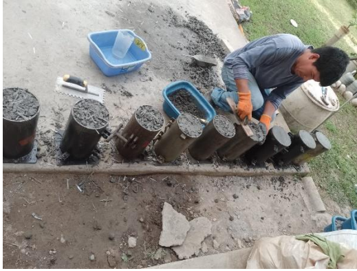
FOTO 22: curado de briquetas de f'c=280 Kg/cm 2 + incorporación de fibras de botellas de plástico reciclado.
