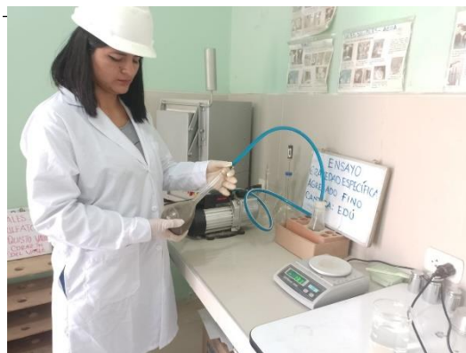
FOTO 11: desarrollo del peso específico en agregados fino de la cantera “EDDU”.
