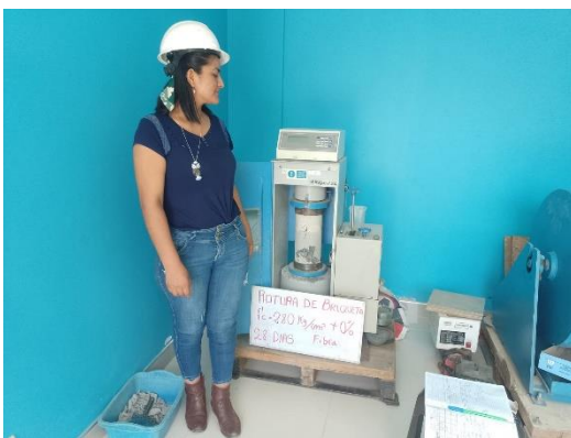
FOTO 24: desarrollo de rotura de briquetas a los 28 días y 14 días respectivamente de concreto con 0 % de fibras
