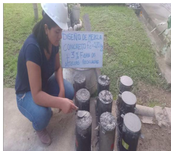
FOTO 21: desarrollo de colocación y perfilado de las briquetas con f'c=280 \text{ Kg/cm}^2 + 3% \text{Kg/cm}^2 .
