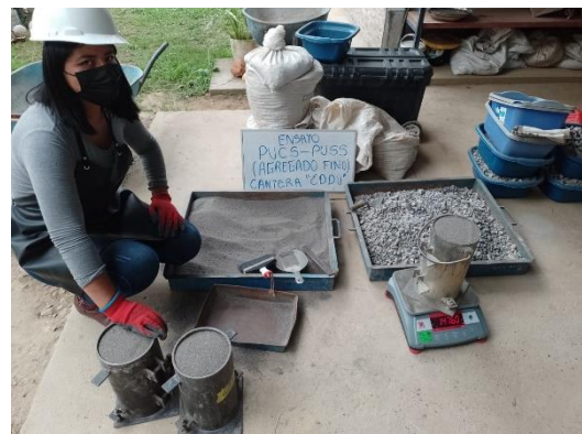
FOTO 09: desarrollo de ensayo de peso unitario seco suelto agregados finos de la cantera "EDDU".
