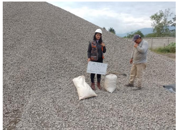
FOTO 01: Recolección de material del agregado grueso de la cantera "EDDU".
