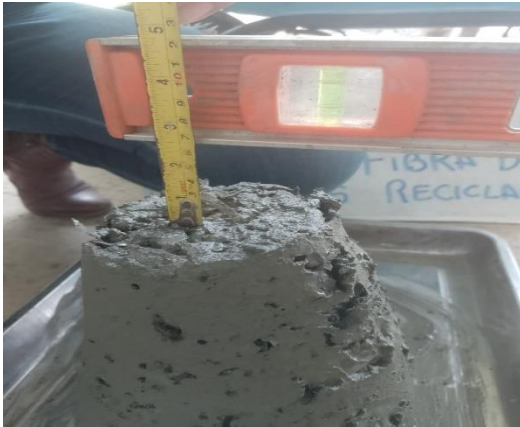
FOTO 19: Prueba de asentamiento del concreto f'c=280 \text{ Kg/cm}^2 + 1% de fibras de botellas de plástico reciclado.
