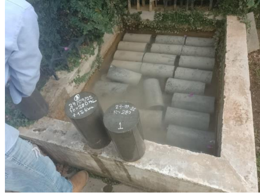
FOTO 22: curado de briquetas de f'c=280 Kg/cm 2 + incorporación de fibras de botellas de plástico reciclado.
