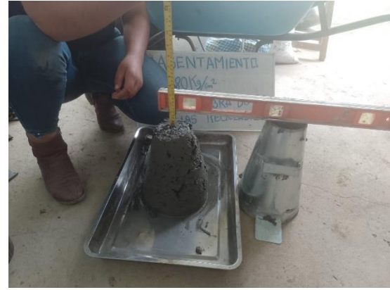
FOTO 19: Prueba de asentamiento del concreto f'c=280 \text{ Kg/cm}^2 + 1% de fibras de botellas de plástico reciclado.
