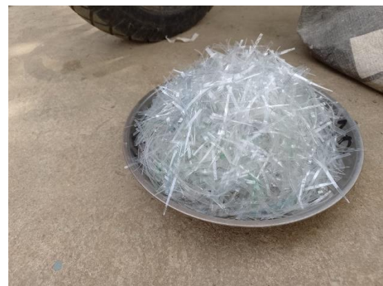
FOTO 20: mezcla del concreto f'c=280 \text{ Kg/cm}^2 + 2% de fibras de botellas de plástico reciclado.
