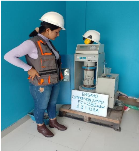
FOTO 26: desarrollo de rotura de briquetas a los 28 días de edad de concreto con 2% de fibras de botellas de plástico.
