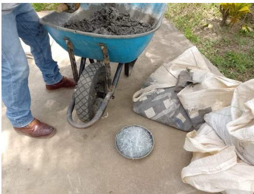
FOTO 20: mezcla del concreto f'c=280 \text{ Kg/cm}^2 + 2% de fibras de botellas de plástico reciclado.
