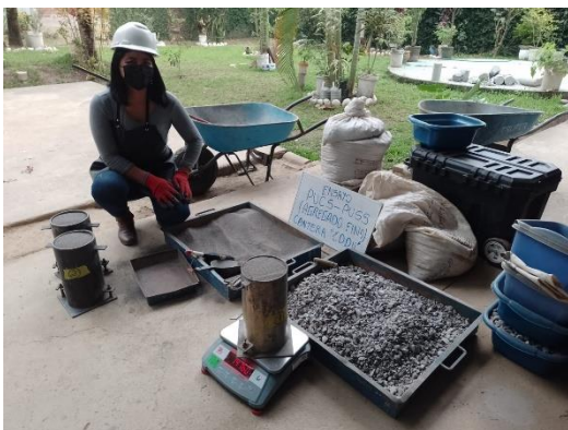
FOTO 09: desarrollo de ensayo de peso unitario seco suelto agregados finos de la cantera "EDDU".
