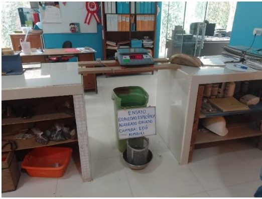
FOTO 10: desarrollo del peso específico del agregado grueso de la cantera “EDDU”.
