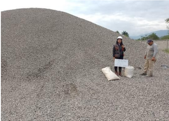
FOTO 01: Recolección de material del agregado grueso de la cantera "EDDU".
