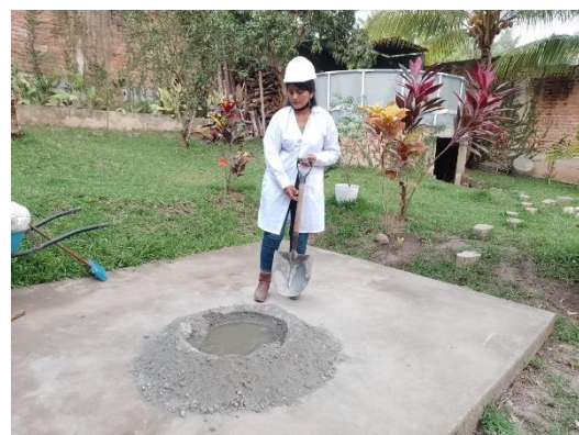
FOTO 15: Preparado del concreto con 0% de fibras de botellas de plástico.
