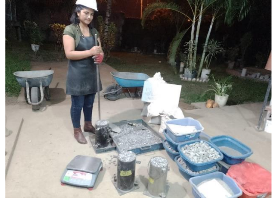
FOTO 07: Desarrollo de ensayo de peso unitario seco compactado agregados gruesos de la cantera "EDDU".
