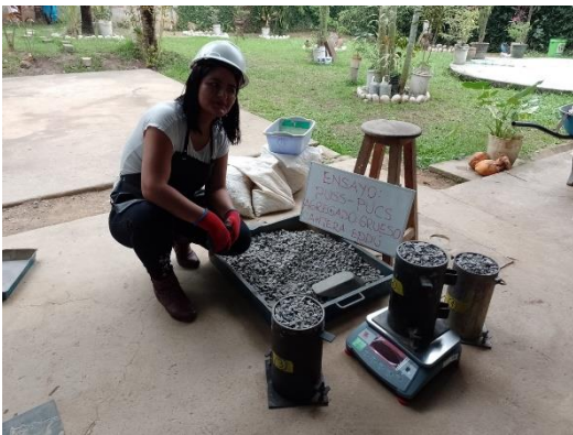
FOTO 08: Desarrollo de ensayo de peso unitario seco suelto agregados gruesos de la cantera "EDDU".
