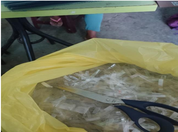
FOTO 13: Las fibras después de haber sido cortadas la parte superior e inferior fueron cortadas en las dimensiones requeridas.
