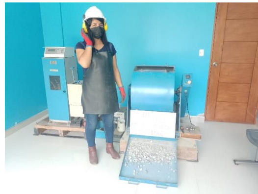
FOTO 05: desarrollo de la abrasión de los agregados grueso de la cantera "EDDU".
