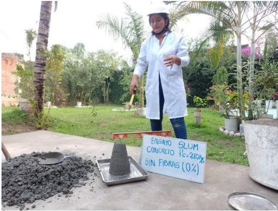
FOTO 16: desarrollo de la prueba slum en concreto f'c=280 \text{ Kg/cm}^2 con 0% de fibras de botellas de plástico.
