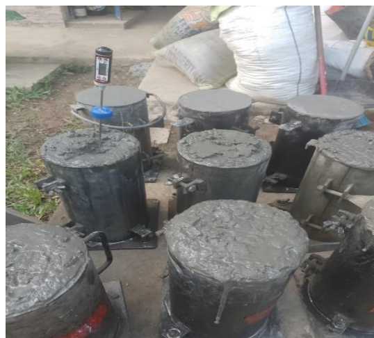
FOTO 21: desarrollo de colocación y perfilado de las briquetas con f'c=280 \text{ Kg/cm}^2 + 3% \text{Kg/cm}^2 .
