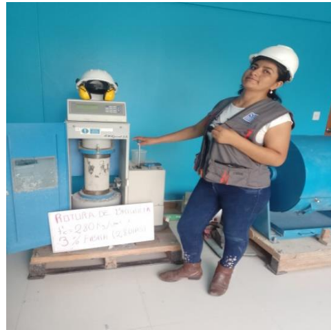
FOTO 28: desarrollo de rotura de briquetas a los 14 y 28 días de concreto con 3% de fibras de botellas de plástico.
