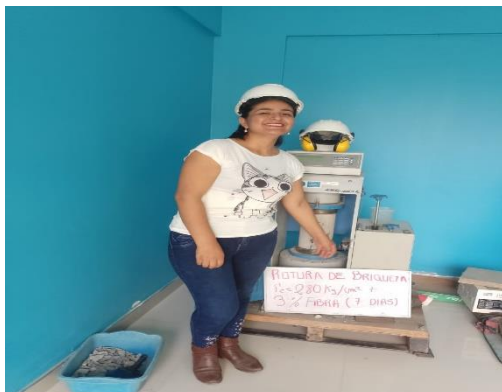
FOTO 27: desarrollo de rotura de briquetas a los 7 de concreto con 3% de fibras de botellas de plástico.
