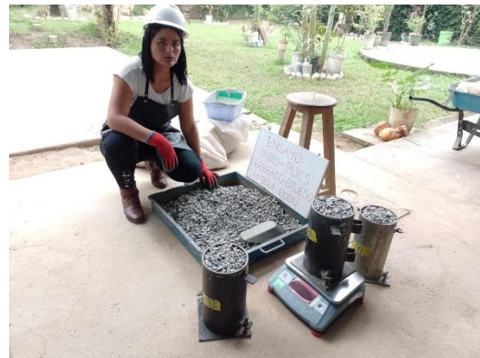
FOTO 08: Desarrollo de ensayo de peso unitario seco suelto agregados gruesos de la cantera "EDDU".
