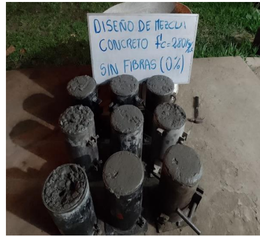
FOTO 17: desarrollo del moldeo y perfilado de las briquetas con concreto con 0% de fibras de botellas de plástico
