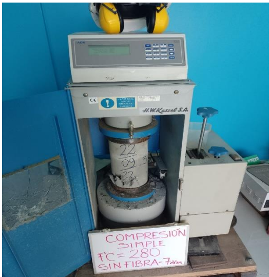
FOTO 23: desarrollo de rotura de briqueta a los 7 días con 0 % de fibra de botellas de plástico reciclado
