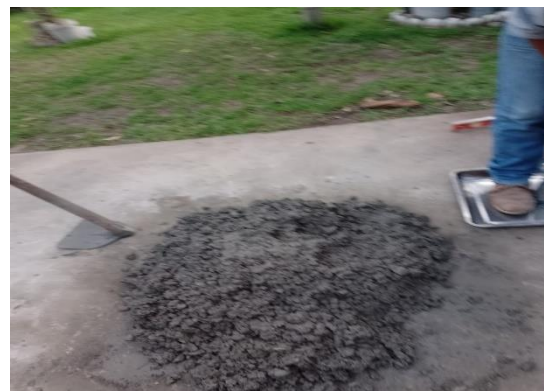
FOTO 18: Preparado de mezcla de concreto de f'c=280 \text{ Kg/cm}^2 con 1% de fibras de botellas de plástico.
