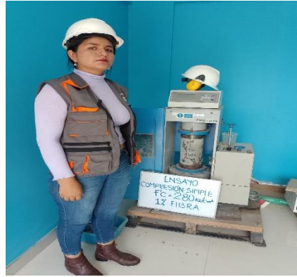
FOTO 25: desarrollo de rotura de briquetas a los 28 días de edad de concreto con 1% de fibras de botellas de plástico.
