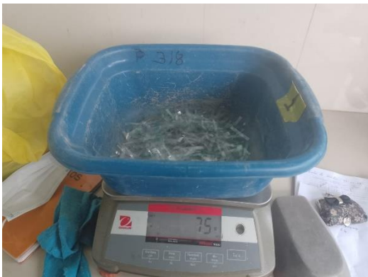
FOTO 18: Preparado de mezcla de concreto de f'c=280 \text{ Kg/cm}^2 con 1% de fibras de botellas de plástico.
