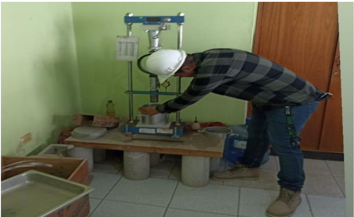
Ensayo de CBR
