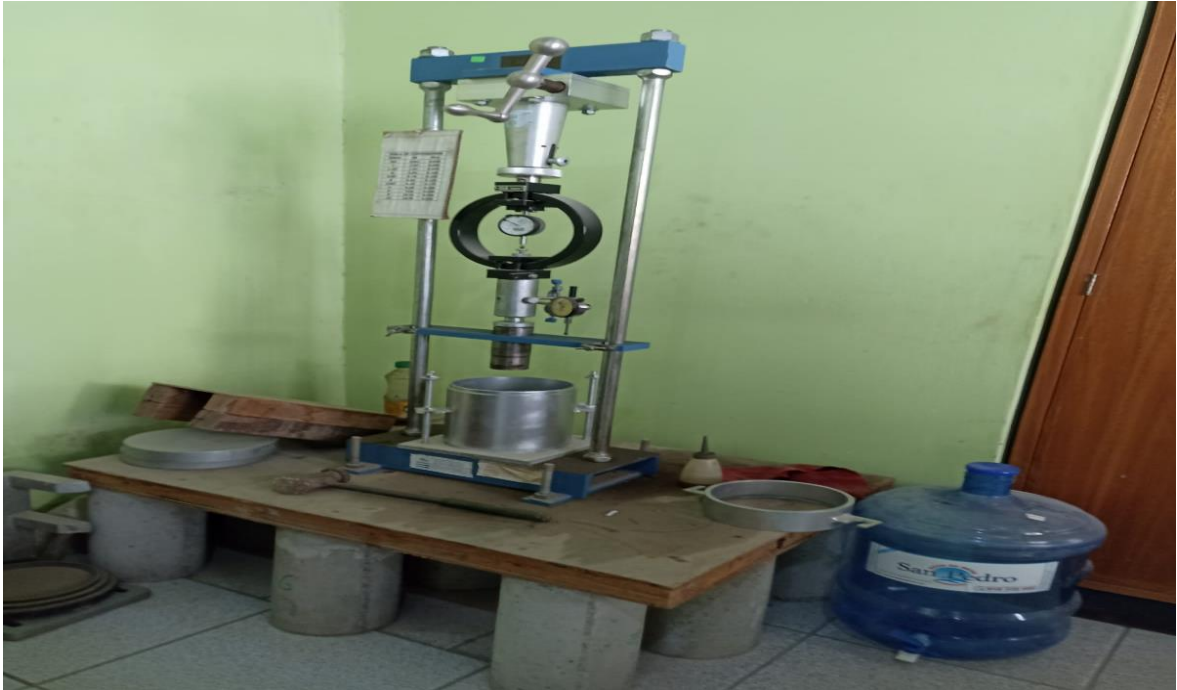
Ensayo de CBR
