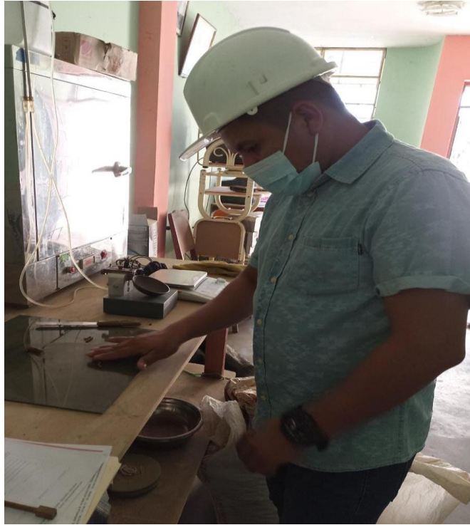
Ensayos de límite de plasticidad
