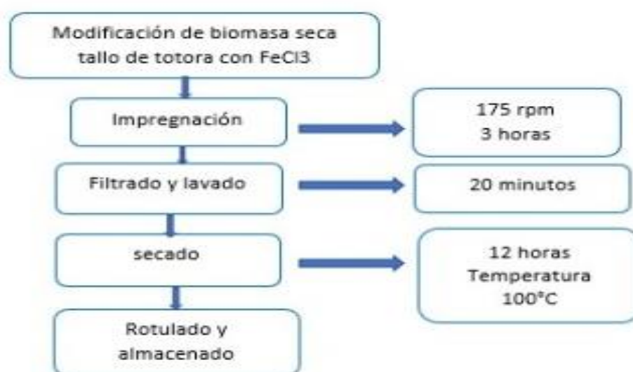
Figura 5. Modificación con \text{FeCl}_3 de biomasa seca de tallo de totora
