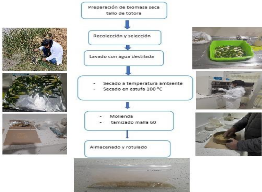
Figura 4. Preparación de polvo de biomasa seca de tallo de totora.
