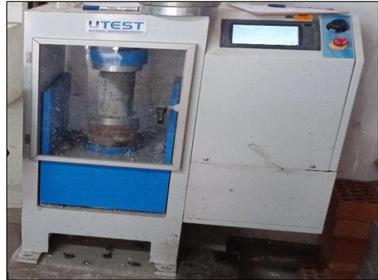
Figura 15. Prensa de compresión
