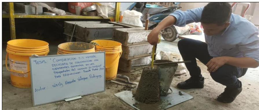
Figura 21. Slump del concreto
