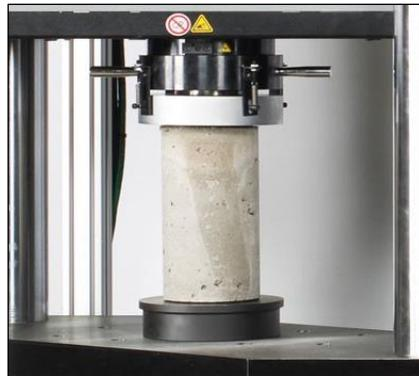
*Figura 3. Rotura del concreto.*
