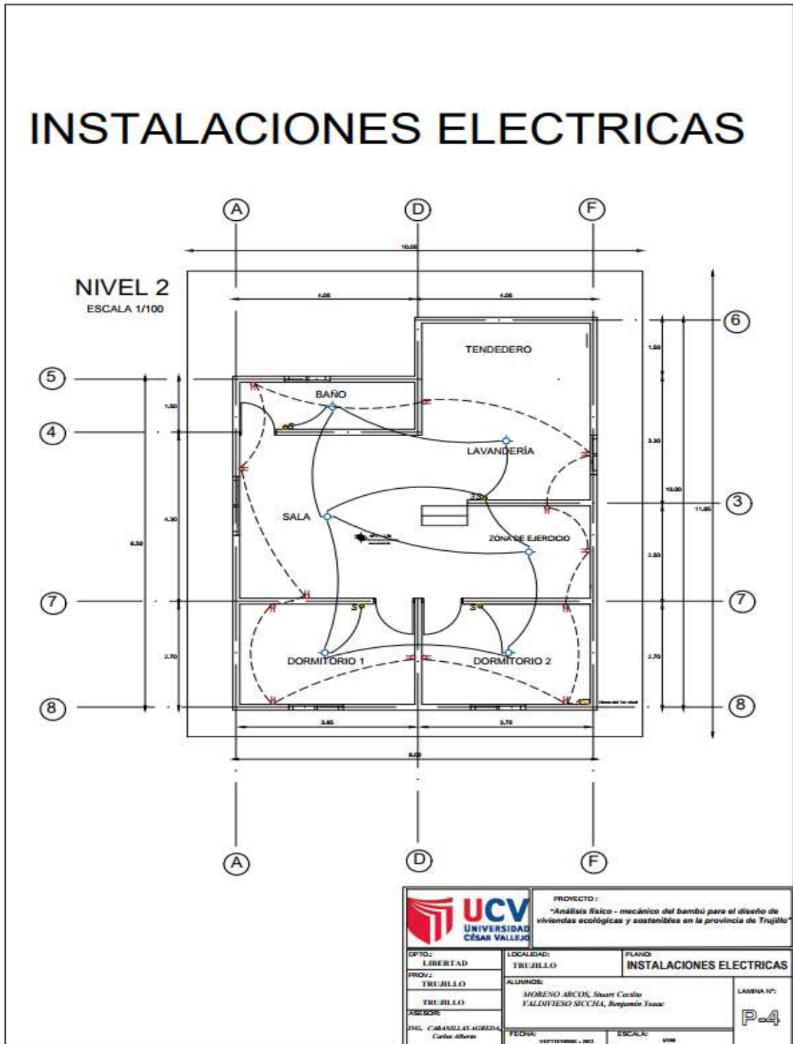
Plano 4: Plano de Instalaciones eléctricas – Nivel 2
