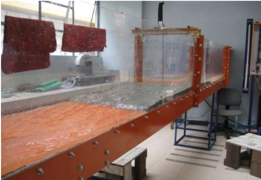
Gráfico 15. Superficie interior de piedra pegada funcionando
