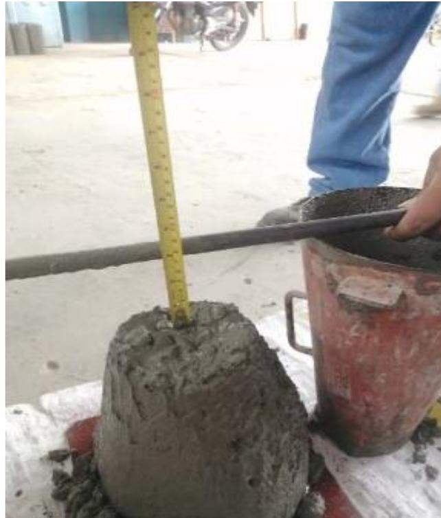
**Anexo 28.** Panel fotográfico N° 12 – Compactación con la varilla de acero para la elaboración de probetas
