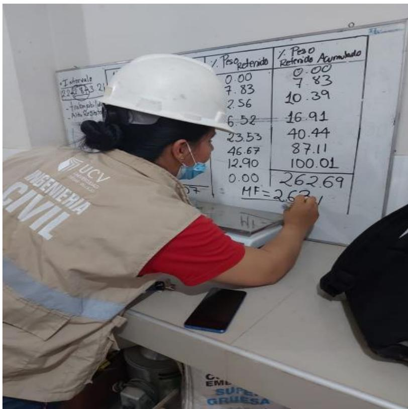
**Anexo 20.** Panel fotográfico N° 04 –Cálculo para el peso específico del agregado grueso
