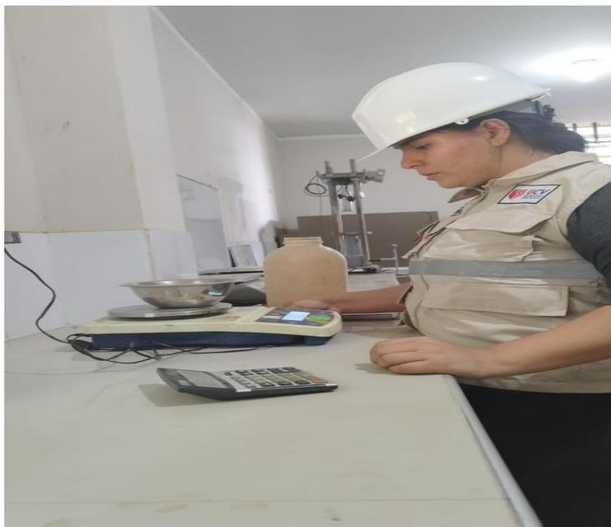
**Anexo 23.** Panel fotográfico N° 07 – Adición del agregado fino para el molde cilíndrico del peso unitario suelto.
