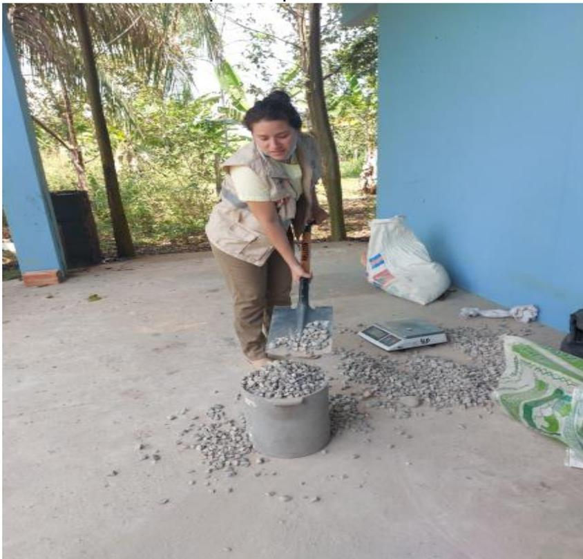
**Anexo 22.** Panel fotográfico N° 06 – Cálculo para el peso superficialmente seco del agregado grueso
