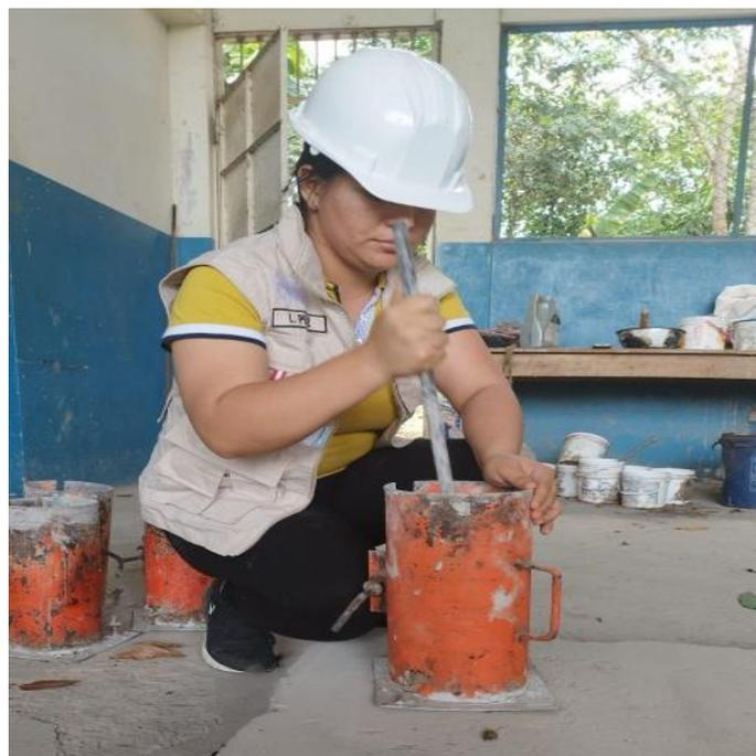
**Anexo 29.** Panel fotográfico N° 13 – Golpes con el martillo de goma para la elaboración de las probetas de concreto.
