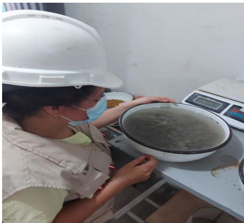
**Anexo 21.** Panel fotográfico N° 05 – Llenado del agregado grueso hasta la superficie del molde cilíndrico para el peso unitario suelto.
