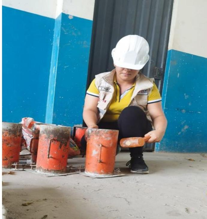
**Anexo 30.** Panel fotográfico N° 14 – Realización de testigos de concreto del diseño  $f'c = 280 \text{ kg/cm}^2$
