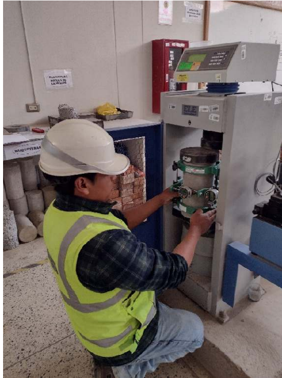
Fotografía 21. Ensayo de módulo de elasticidad (ASTM C469).
