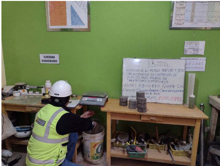
Fotografía 27. Ensayo de porosidad abierta, densidad volumétrica, absorción al agua (ASTM C462).
