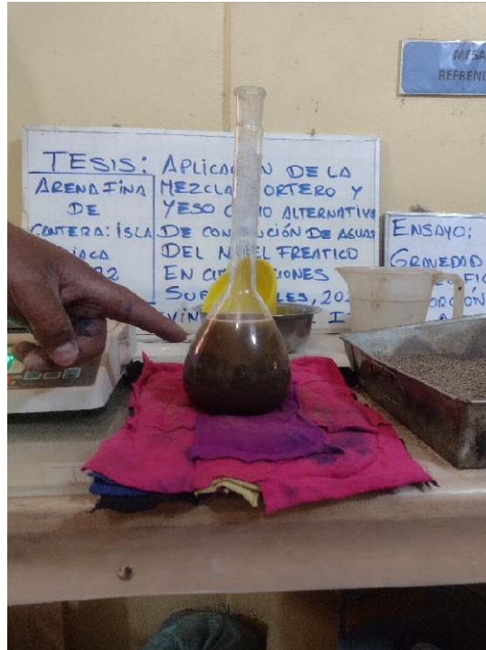
Fotografía 11. Peso material + agua en el frasco (ASTM C128)
