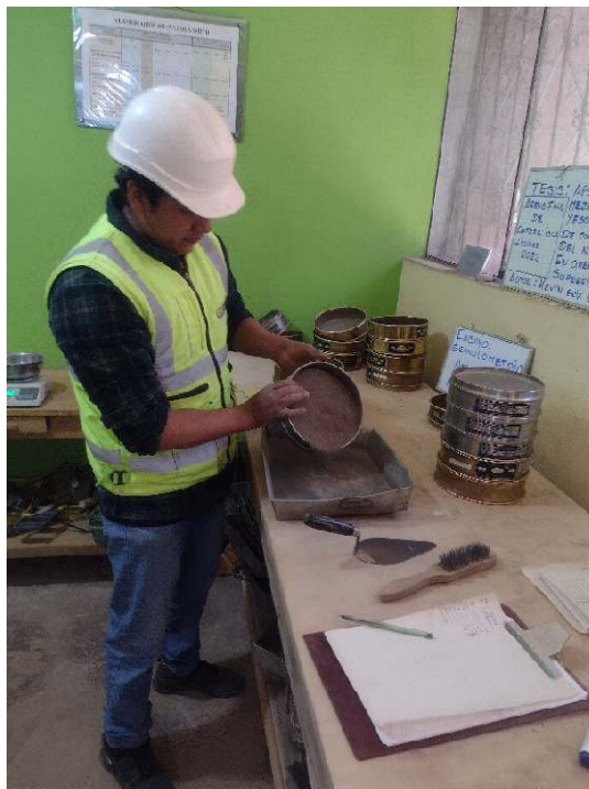
Fotografía 4. Ensayo de análisis granulométrico de árido fino (ASTM D422).
