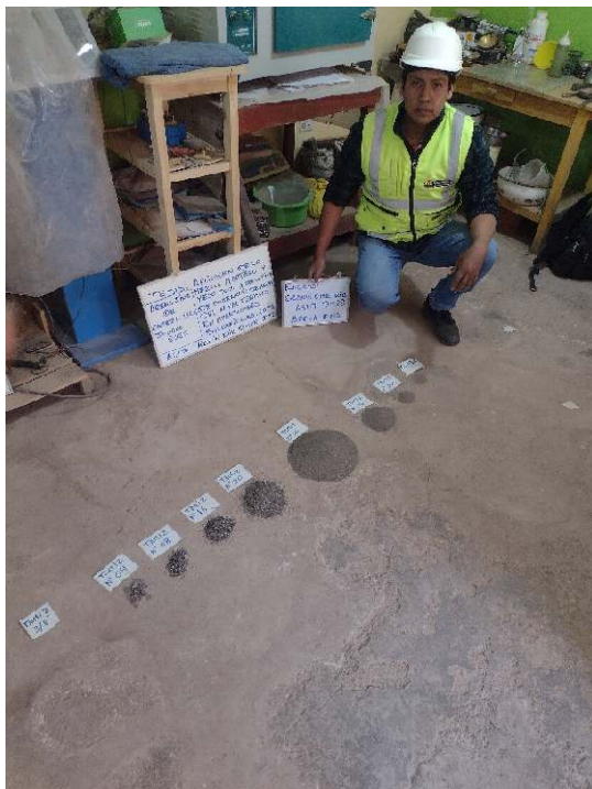
Fotografía 6. Ensayo de análisis granulométrico de árido fino - final (ASTM D422).
