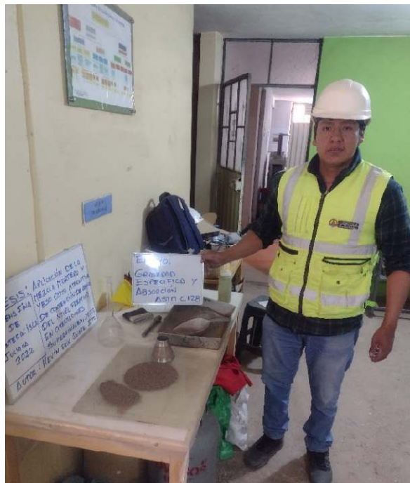
Fotografía 8. Ensayo de gravedad específica y absorción de árido fino - consistencia (ASTM C128).
