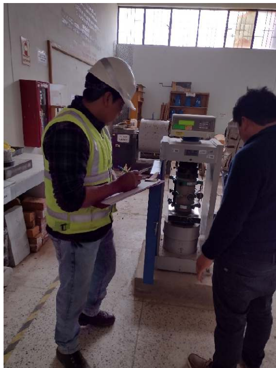
Fotografía 22. Ensayo de módulo de elasticidad (ASTM C469).
