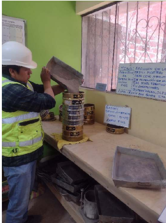
Fotografía 3. Ensayo de análisis granulométrico de árido fino (ASTM D422).
