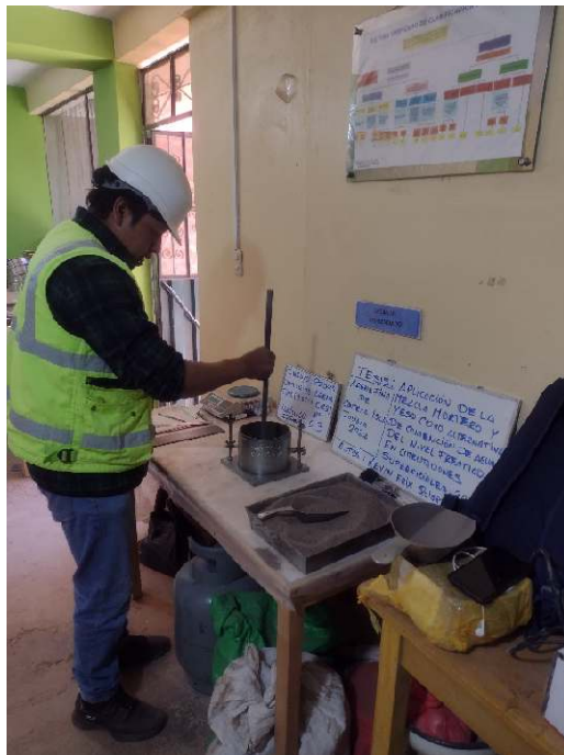
Fotografía 2. Ensayo de pesos unitarios varillado de árido fino (ASTM C128).
