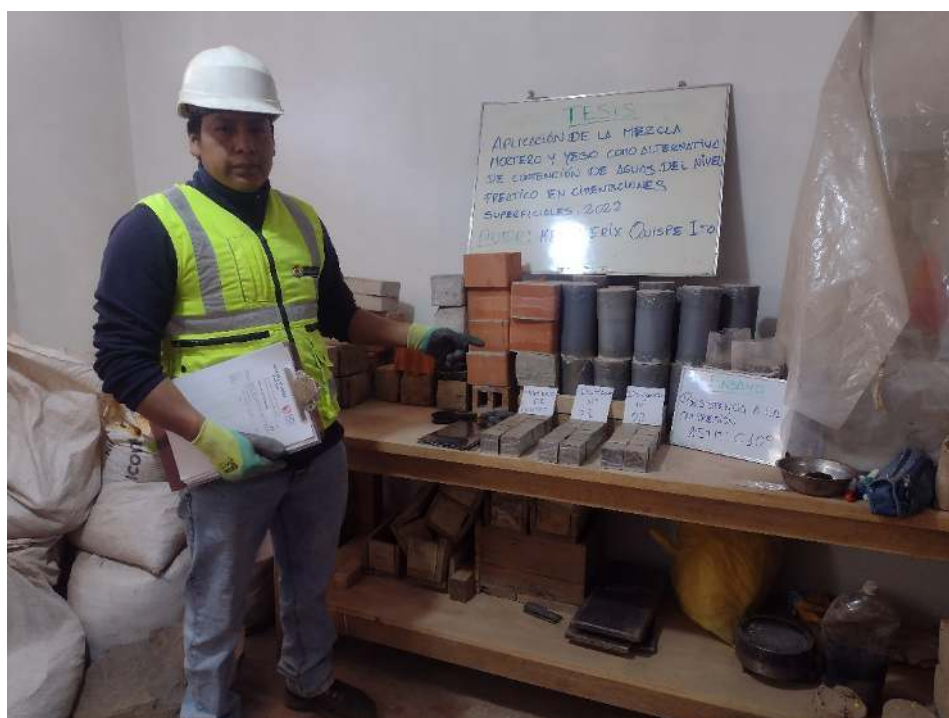
Fotografía 14. Especímenes para prueba resistencia a la compresión (ASTM C109).
