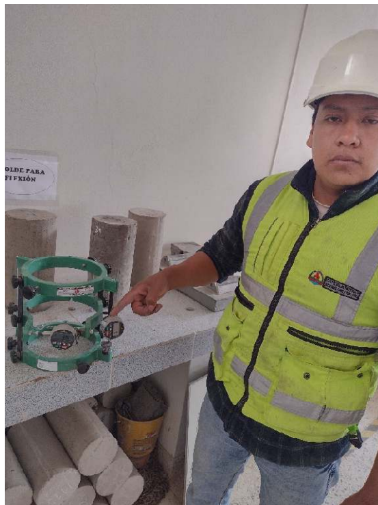
Fotografía 20. Ensayo de módulo de elasticidad (ASTM C469).
