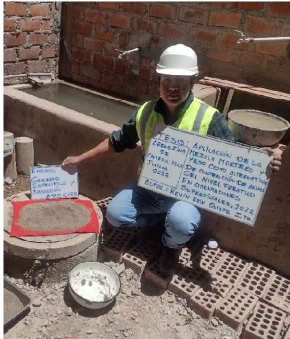
Fotografía 7. Ensayo de gravedad específica y absorción de árido fino - SSS (ASTM C128).
