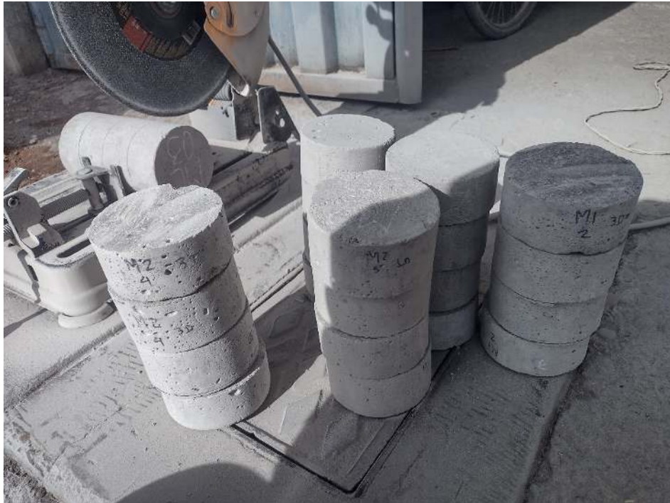
Fotografía 25. Especímenes terminados para ensayo de porosidad abierta, densidad volumétrica, absorción al agua (ASTM C462).
