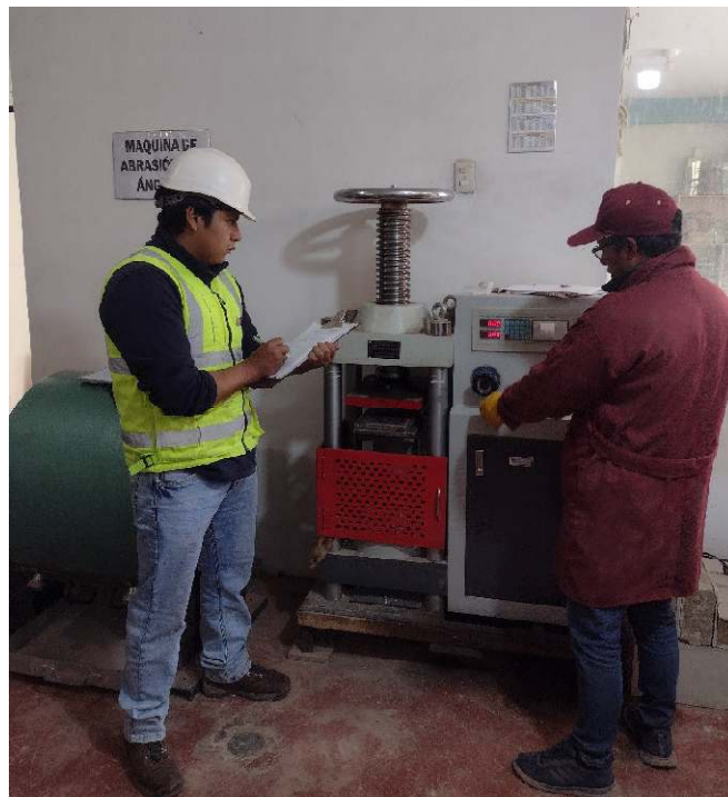
Fotografía 16. Ensayo de resistencia a la compresión (ASTM C109).
