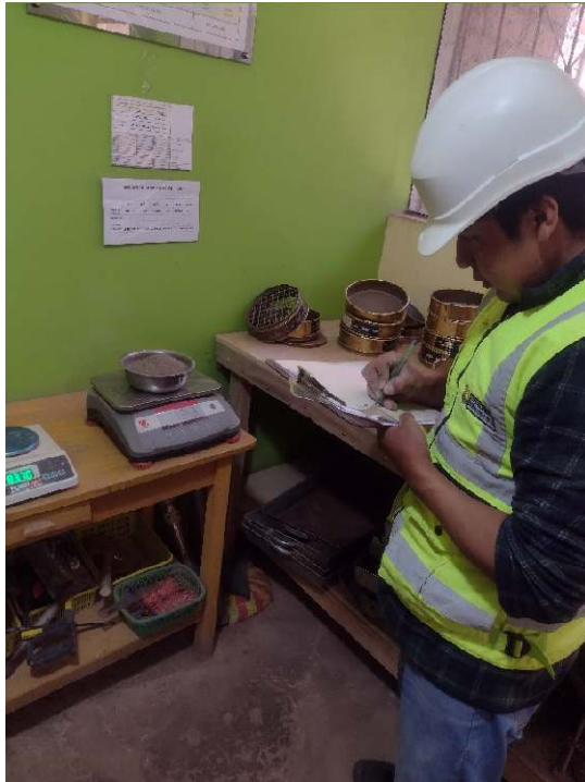
Fotografía 5. Ensayo de análisis granulométrico de árido fino - pesaje (ASTM D422).
