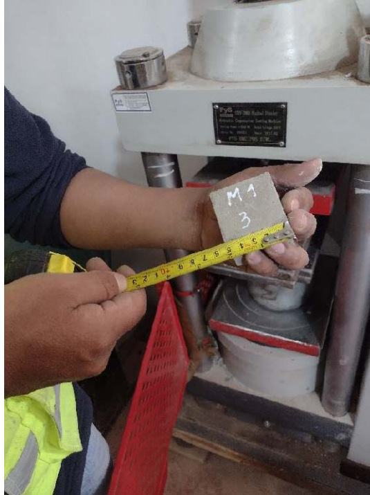
Fotografía 17. Ensayo de resistencia a la compresión (ASTM C109).
