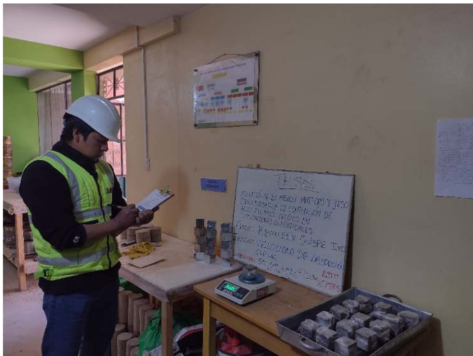
Fotografía 30. Ensayo de absorción capilar (ASTM C1585).
