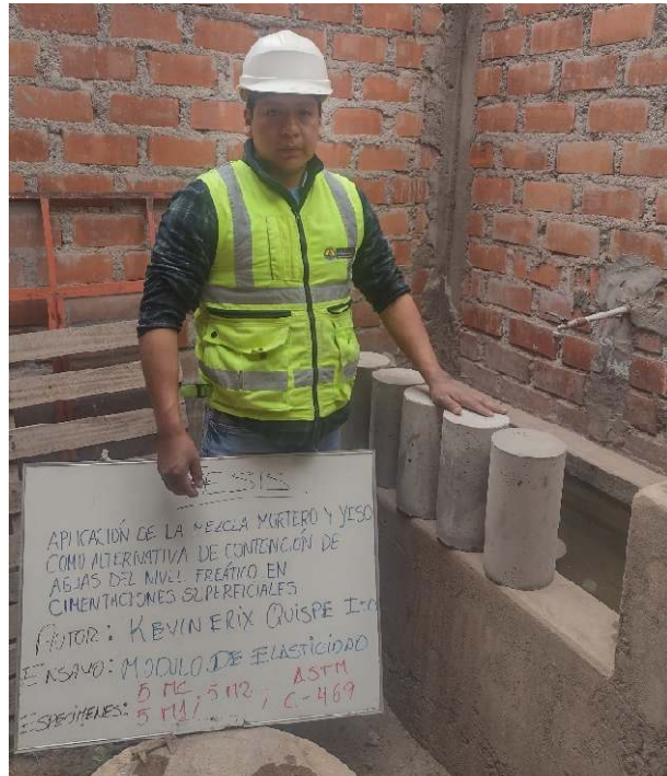
Fotografía 19. Especímenes para ensayo de módulo de elasticidad (ASTM C469).
