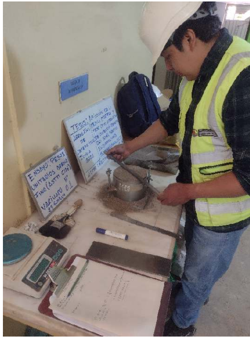
Fotografía 1. Ensayo de pesos unitarios suelto de árido fino (ASTM C128).
