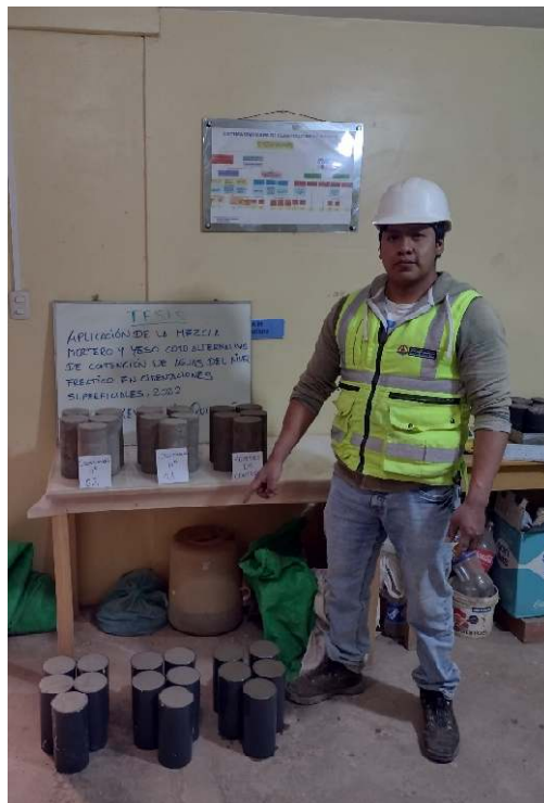
Fotografía 24. Especímenes para ensayo de porosidad abierta, densidad volumétrica, absorción al agua (ASTM C462).
