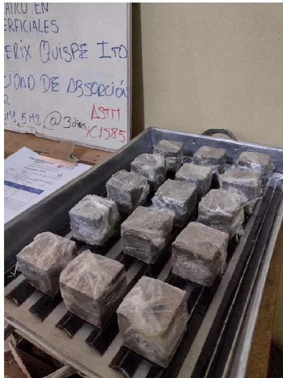
Fotografía 29. Ensayo de absorción capilar (ASTM C1585).
