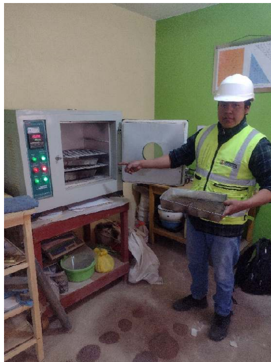
Fotografía 12. Secado del material (ASTM C128)
