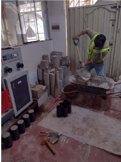
Fotografía 23. Elaboración de especímenes para ensayo de porosidad abierta, densidad volumétrica, absorción al agua (ASTM C462).
