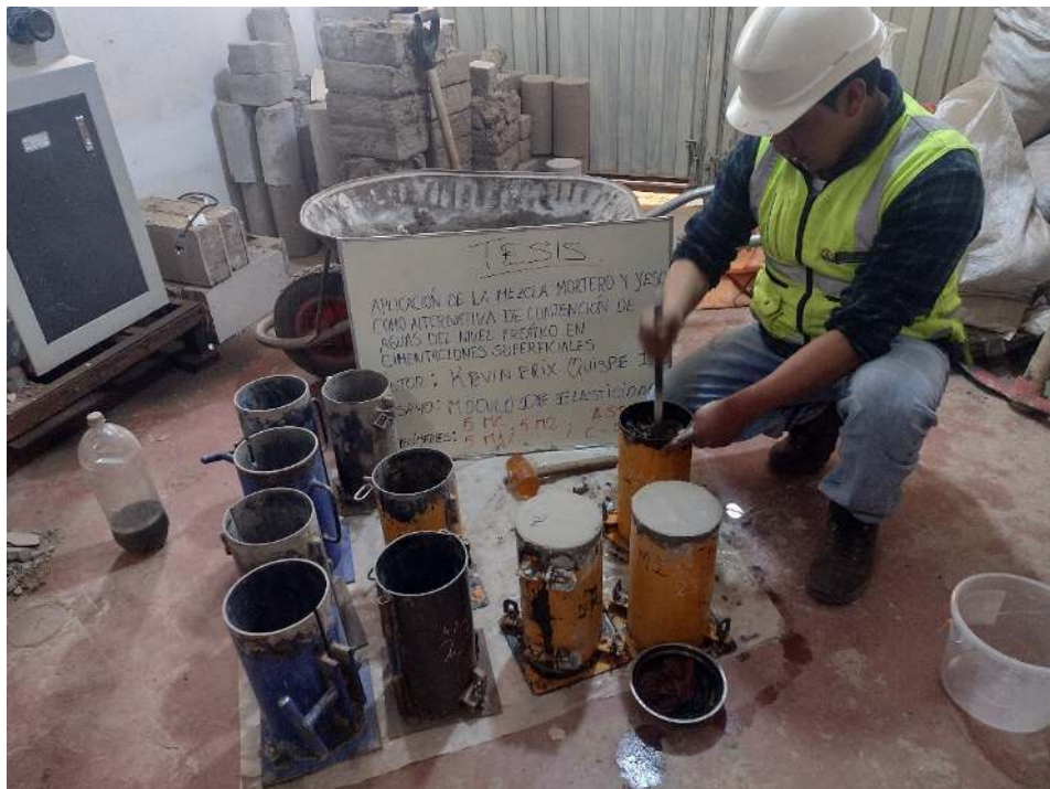
Fotografía 18. Elaboración de muestras, prueba módulo de elasticidad (ASTM C469).
