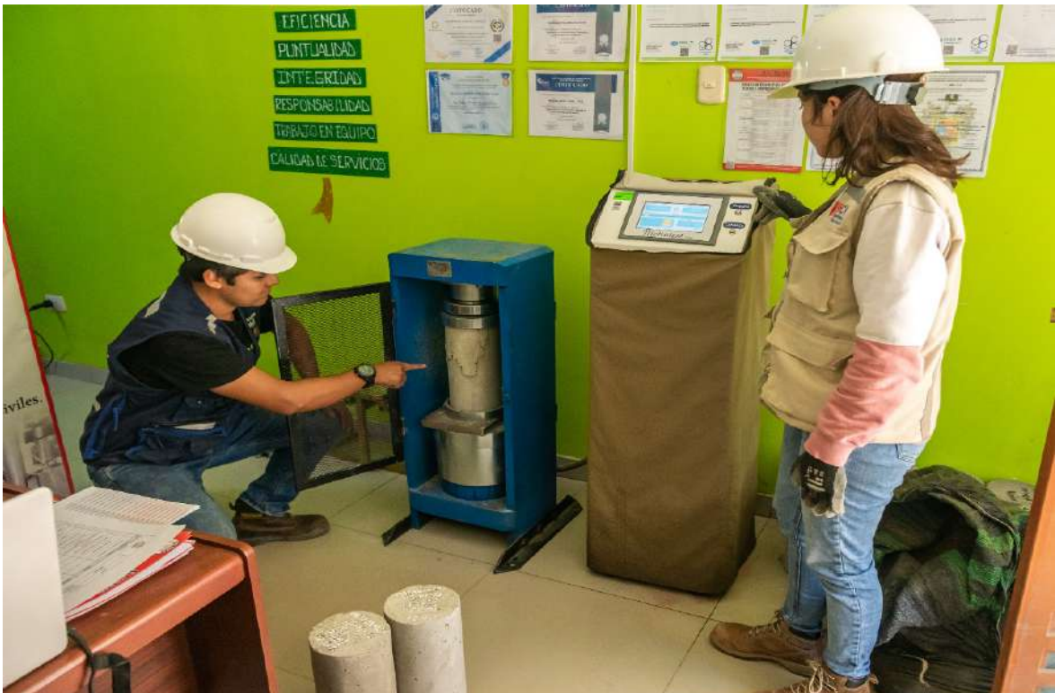
Imagen 20. Rotura de las probetas de concreto para medir su esfuerzo a la compresión (fractura de tipo 5).
