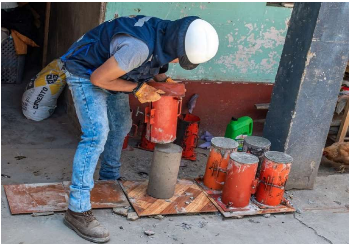
Imagen 16. Retiro de los moldes de las probetas.
