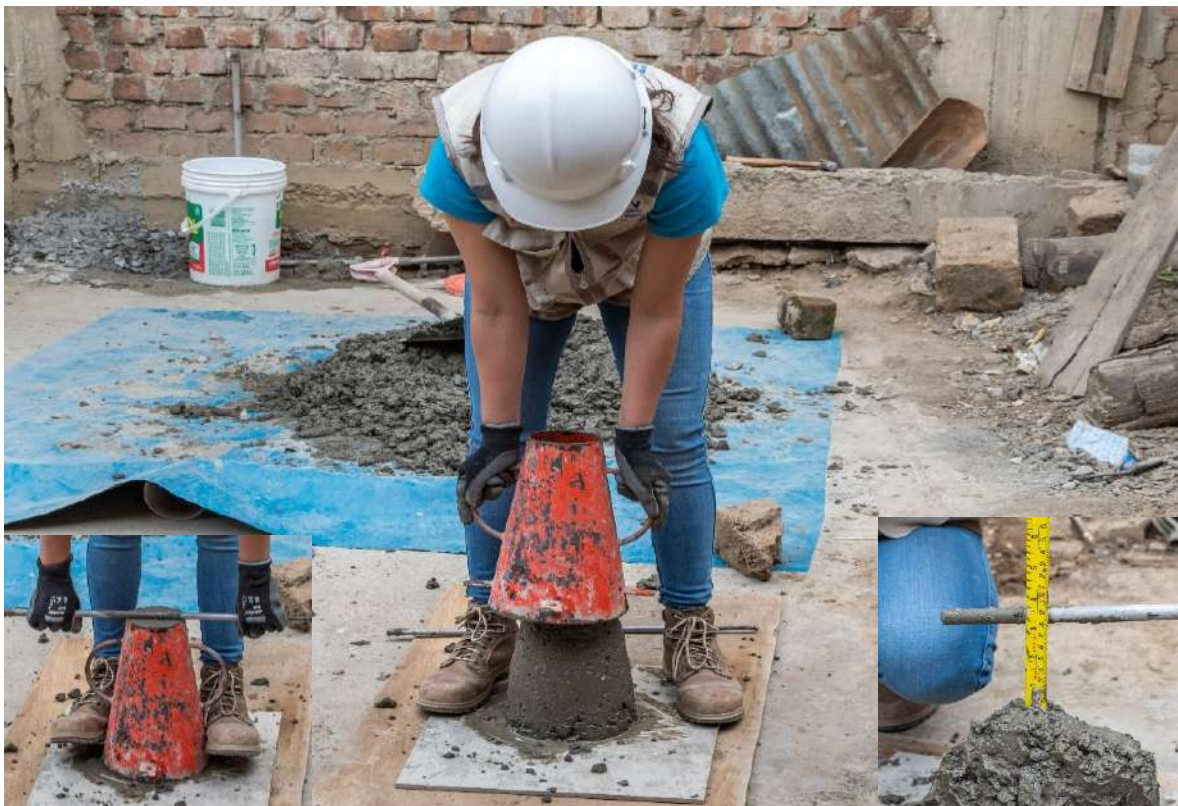
Imagen 12. Prueba de Slump para medir la consistencia del concreto fresco (asentamiento del concreto fue de 3")
