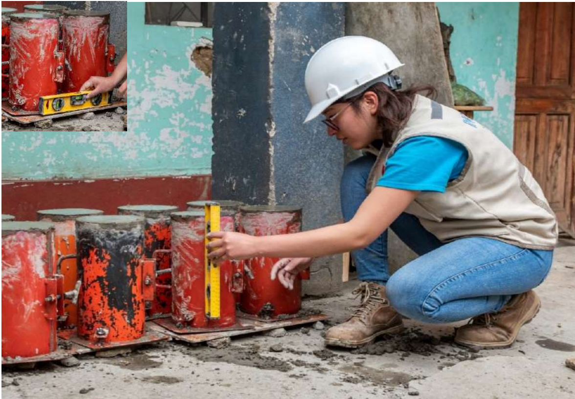
Imagen 15. Nivelación de los moldes de las probetas.
