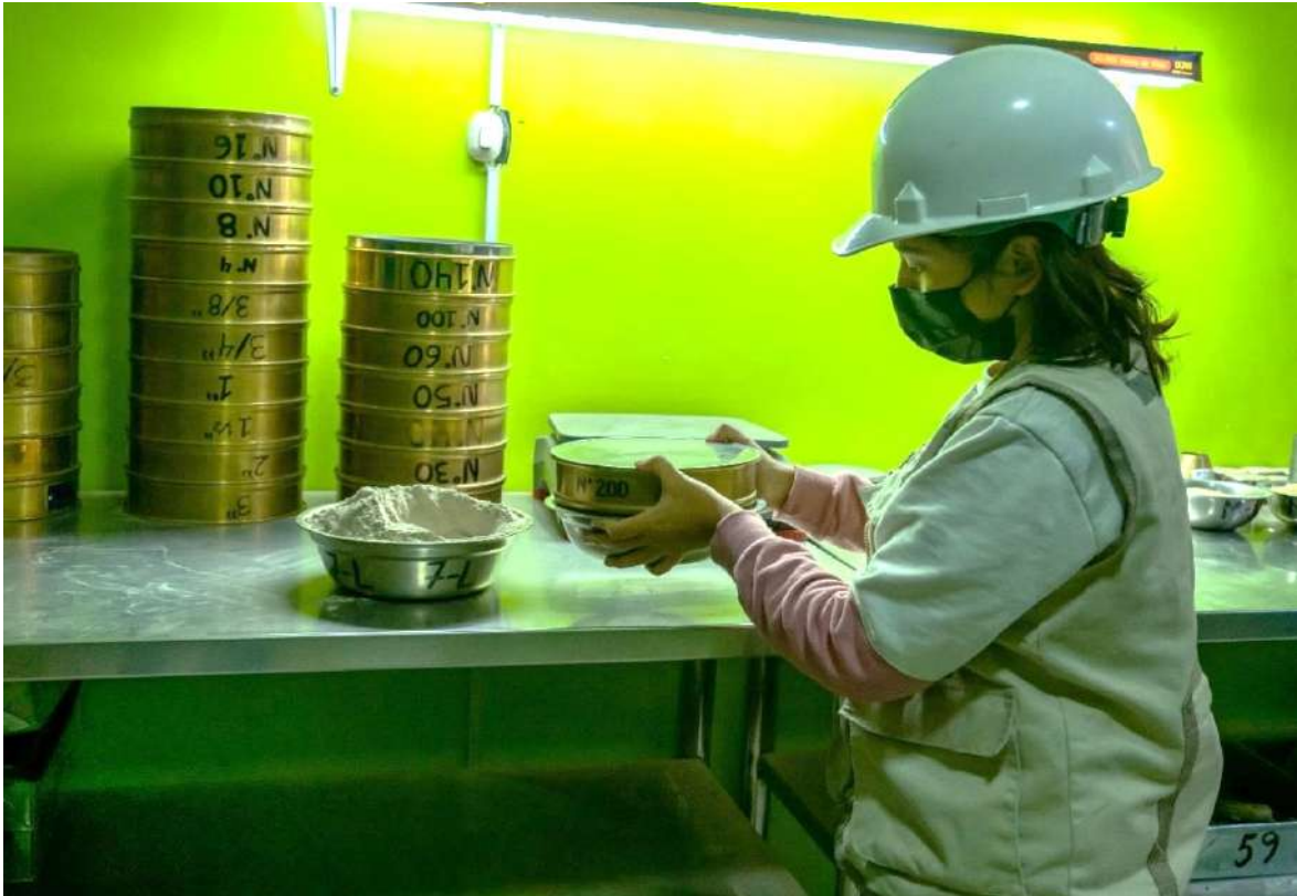
Imagen 5. Tamizado de la ceniza de madera de pino por la malla N°200.
