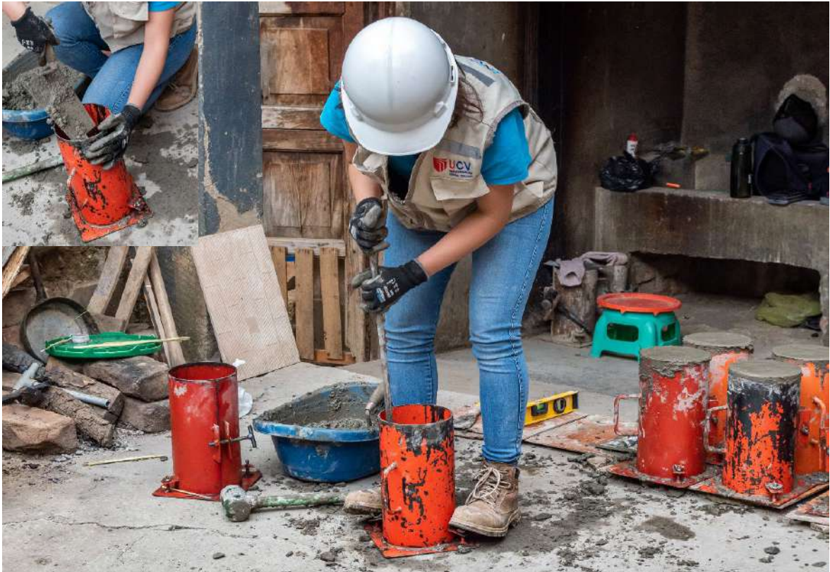
Imagen 13. Chuzeada del concreto con una varilla lisa de acero.
