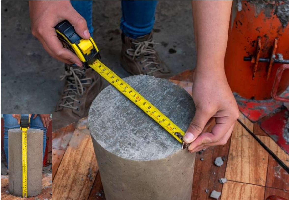
Imagen 17. Control de las dimensiones de las probetas de concreto.
