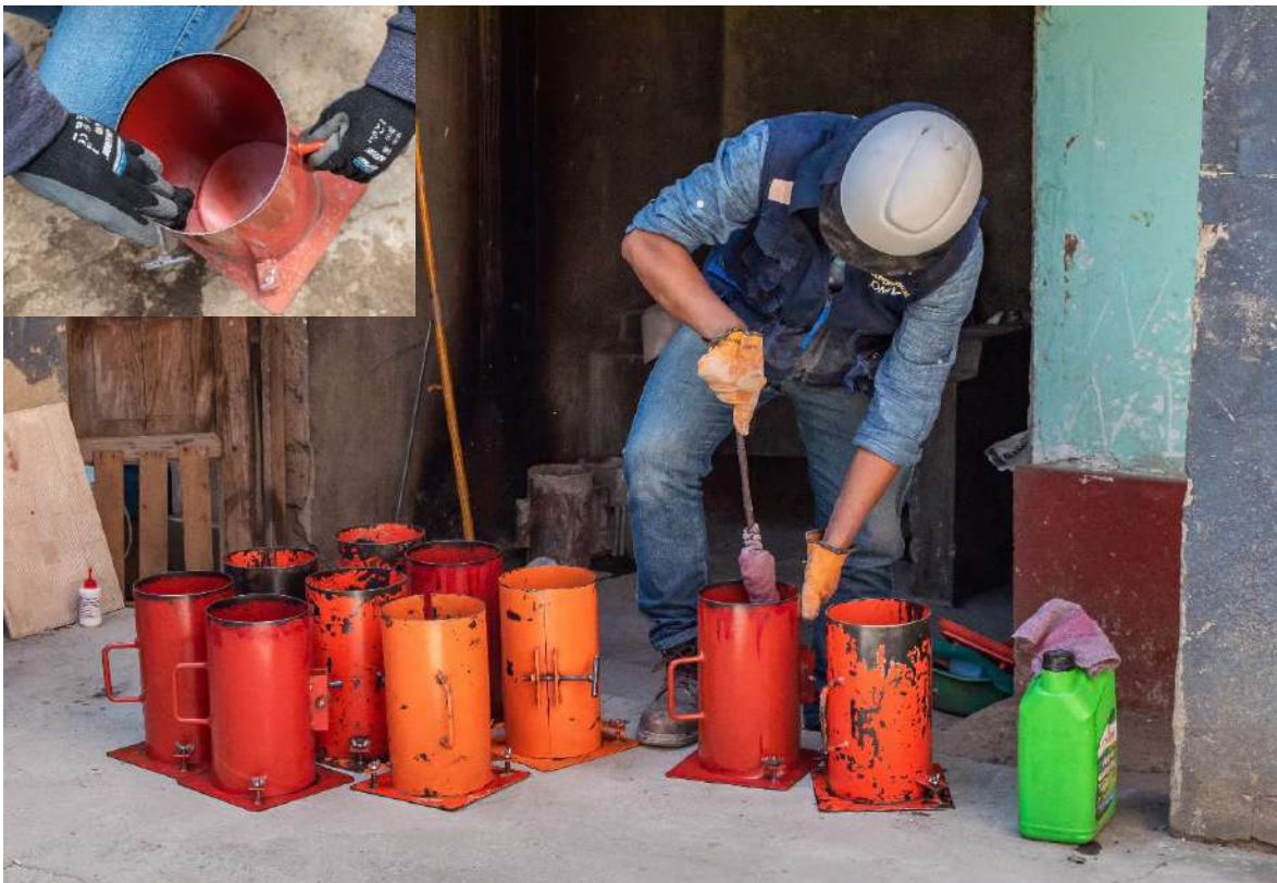
Imagen 6. Limpieza de los moldes para la elaboración de las probetas de concreto.
