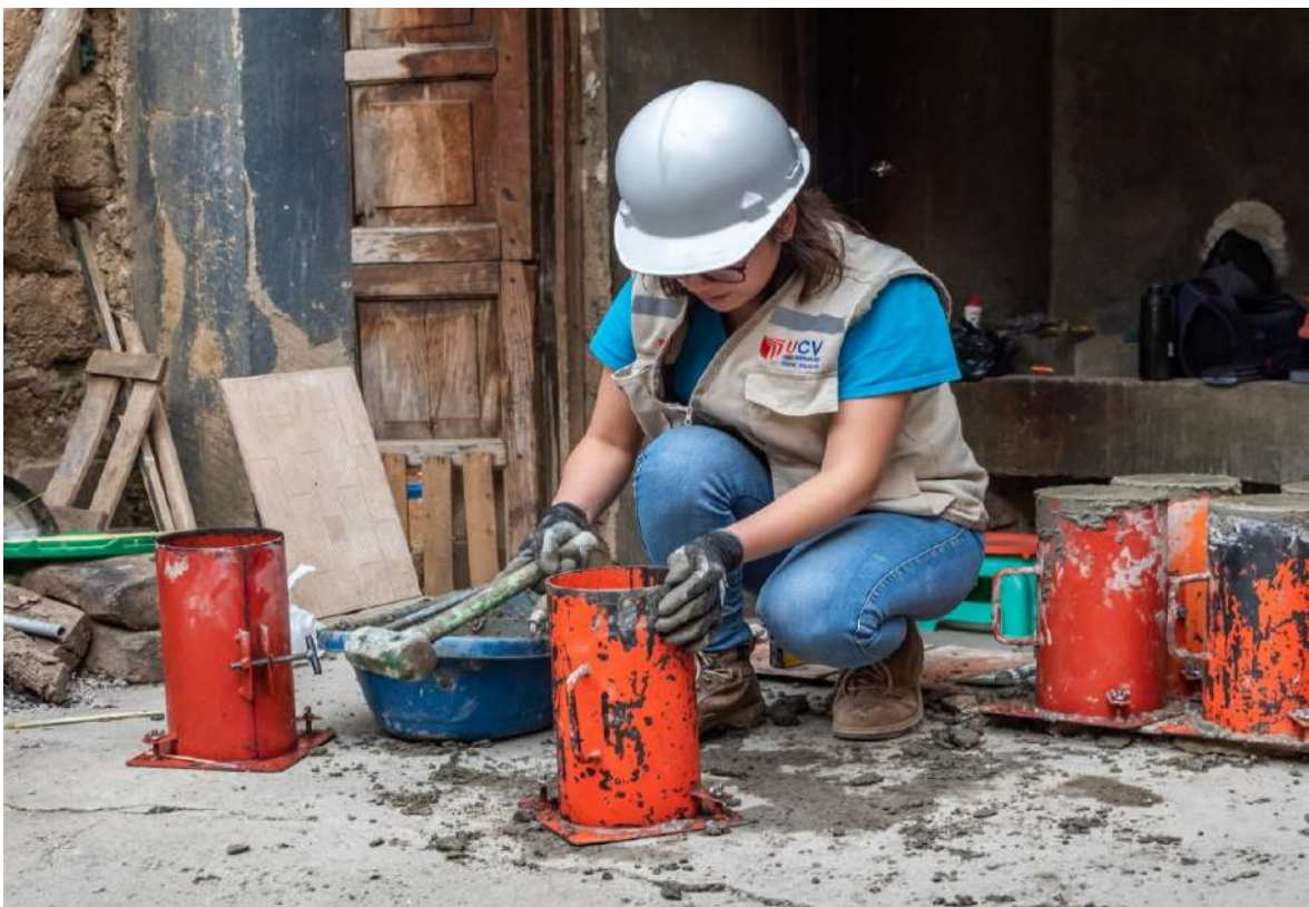
Imagen 14. Golpes alrededor del molde de la probeta con un martillo de goma.
