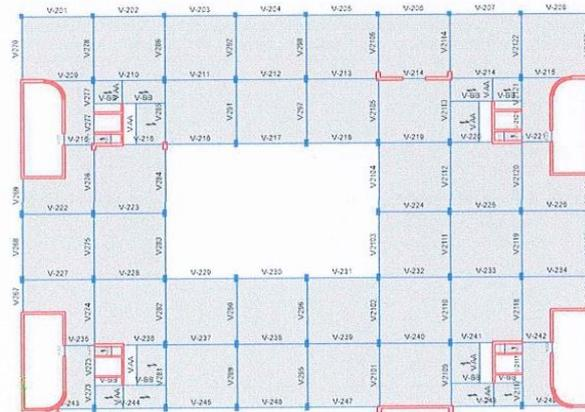
Figura 64. Distribución de elementos estructurales, Hospital 2 – II Tarapoto
