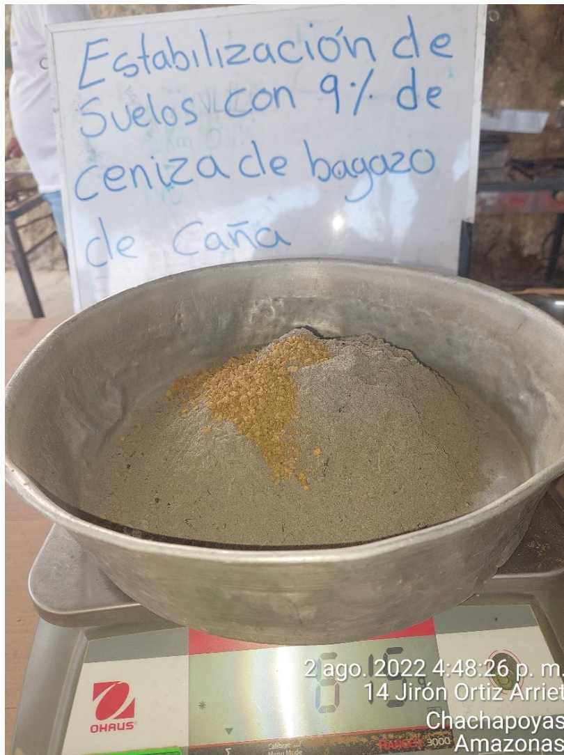
Figura N° 18. Combinación de ejemplar de la calicata 2, adicionando el 9% de CBCA para la ejecución de proctor modificado, antes de agregar agua para su mezcla y poder ser puesta en el molde.
