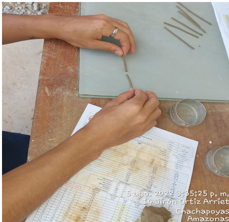
Figura N° 17. Con la ayuda de nuestros dedos se realizaron cilindros de 3,2mm con los ejemplares de la calicata 1 con la incorporación de CBCA al 6%
