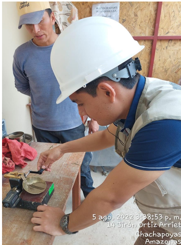
Figura N° 16. Accionando la copa de Casagrande con el ejemplar de la calicata 1 hasta que las mitades hagan contacto en el fondo.
