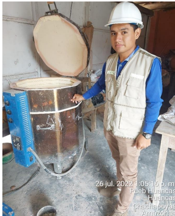
Figura N° 12. Quemado del bagazo en horno eléctrico, controlando la temperatura de 500°C a 600°C
