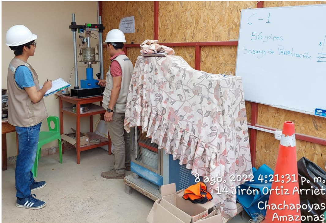
Figura N° 23. Tomando apuntes de la carga de penetración con cada uno de los ejemplares de suelo natural y sus combinaciones de las tres calicatas
