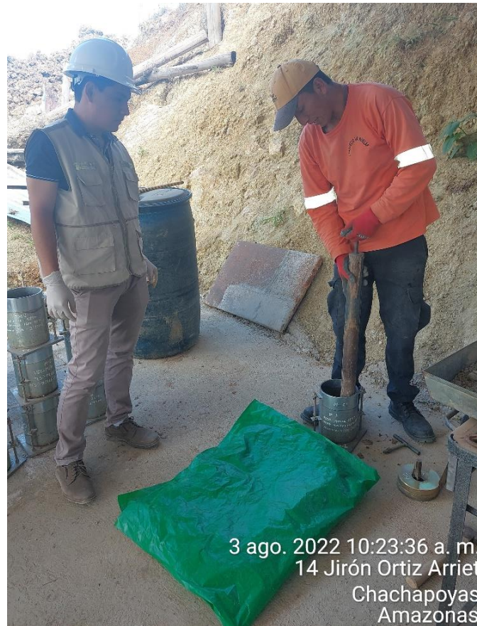
Figura N° 19. Compactación con ayuda del técnico de laboratorio para el Ensayo de Proctor.
