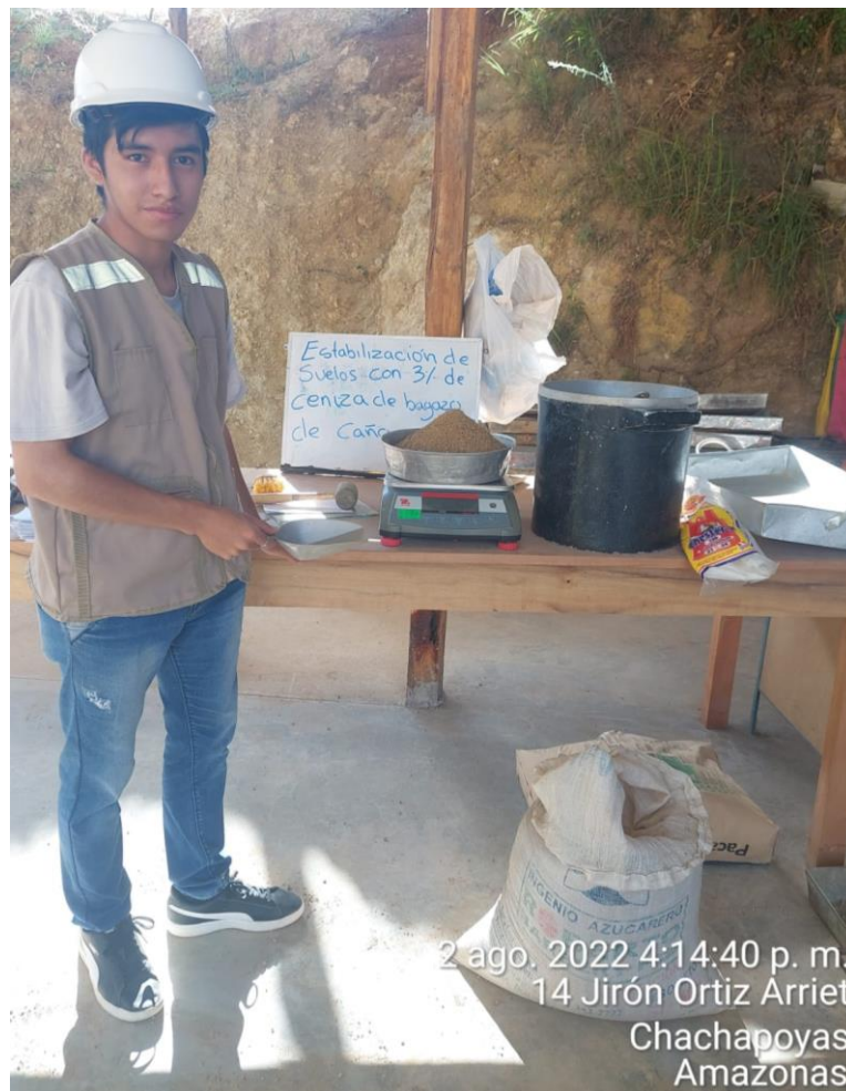
Figura N° 20. Pesado de la combinación del 3% de CBCA con nuestro ejemplar de la calicata 1, para luego ser mezclado con agua y ponerlos en los moldes de CBR.
