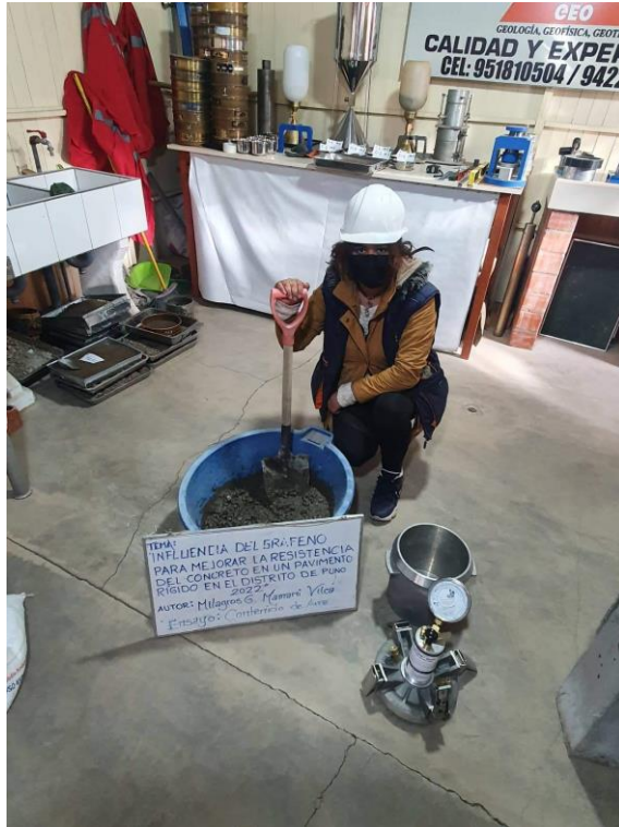
Fotografía 9. Mezclado de concreto.
