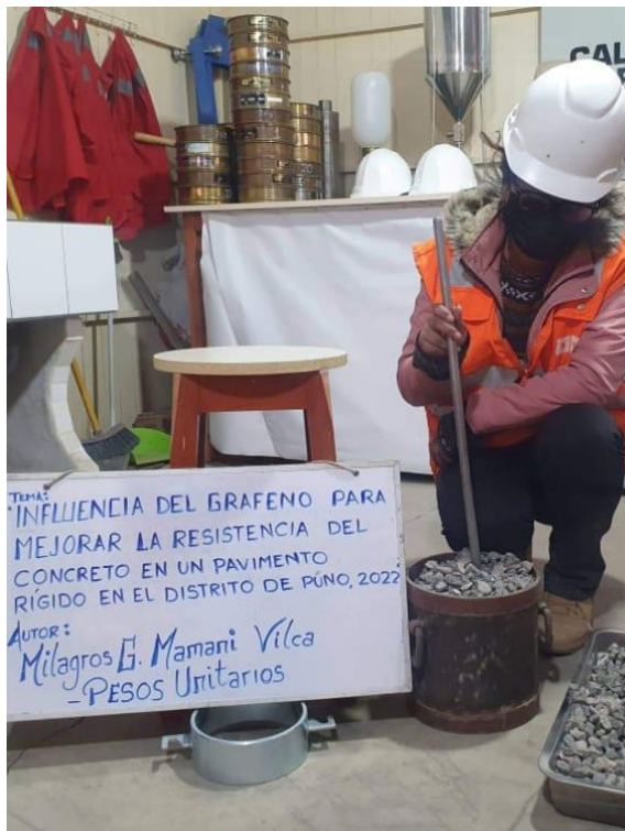
Fotografía 7. Ensayo de densidad de agregado grueso.
