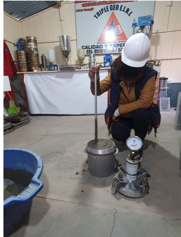
Fotografía 10. Ensayo de densidad
