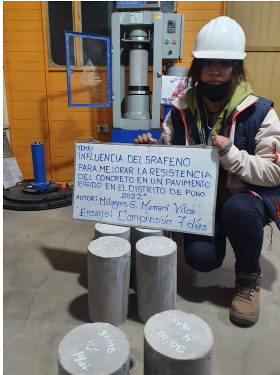
Fotografía 18. Preparación para ensayo de rotura de briquetas.
