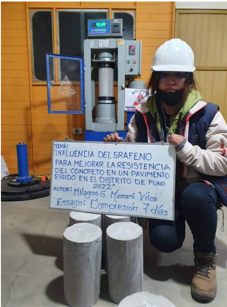
Figura 6. Rotura de briquetas de concreto.
