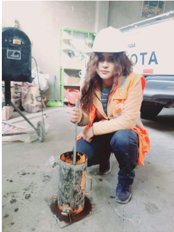
Fotografía 13. Elaboración de briquetas de concreto.
