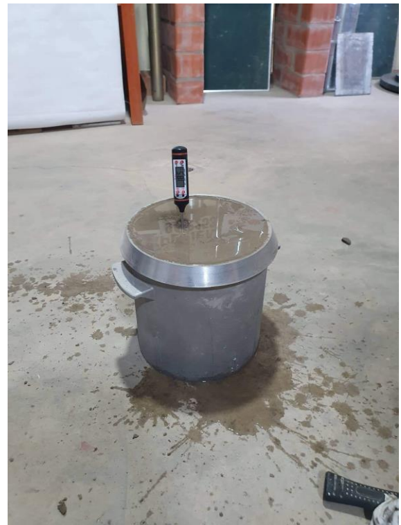
Fotografía 12. Toma de temperatura en el concreto.
