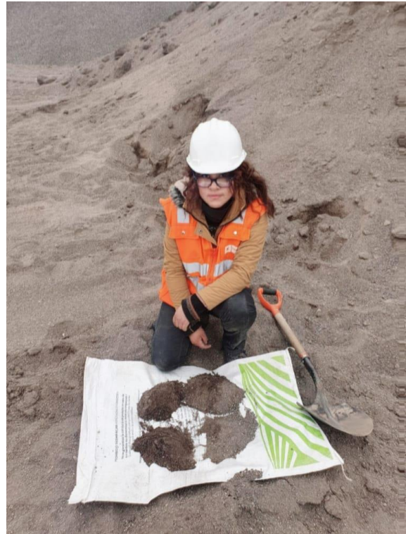
Fotografía 6. Recolección de agregado fino.
