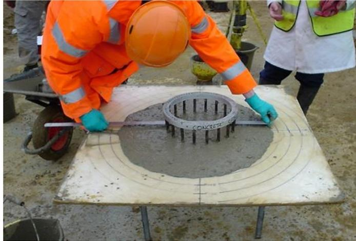
**Figura 2.** *Determinando trabajabilidad. Tomado de “Propiedades del concreto”, por (GEOSEISMIC, 2017)*
