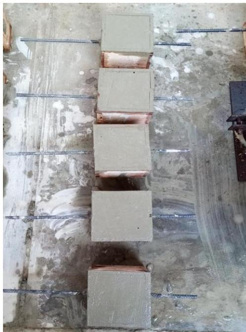
**Figura 14.** Muestras para ensayo de adherencia concreto-acero
