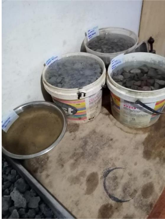
**Figura 31.** *Absorción de los agregados*
