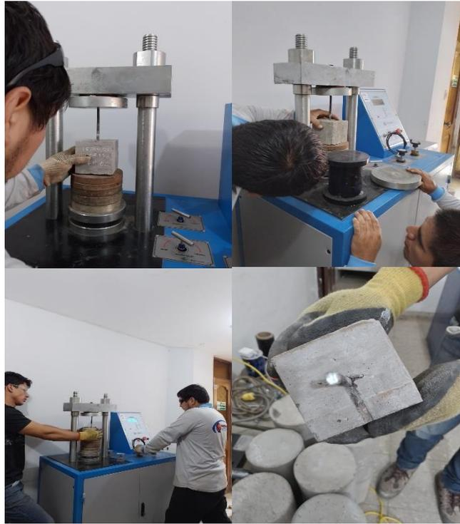
**Figura 83.** *Ensayo de adherencia concreto-acero a los 7 días*
