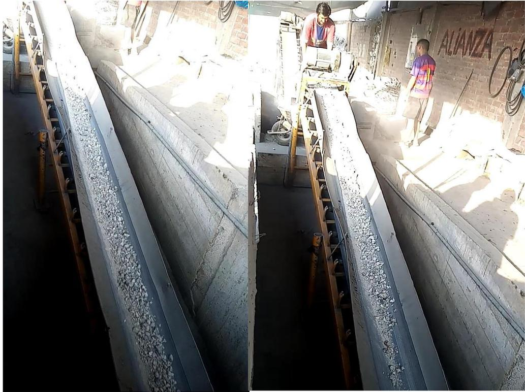
**Figura 27.** *Material triturado transportado en faja*
