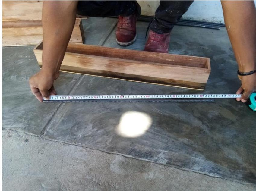
**Figura 37.** *Dimensión de acero de refuerzo de 8mm*
