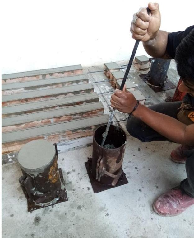
**Figura 60.** Chuzado de primera capa de molde para dado de ensayo de compresión y tracción
