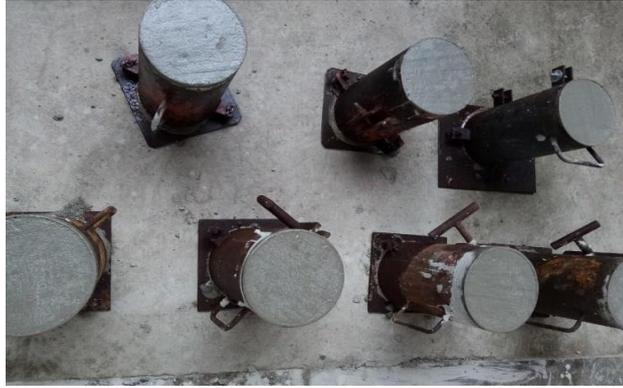
**Figura 11.** *Muestras para ensayo de resistencia a tracción del concreto*
