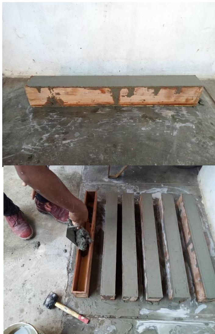
**Figura 46.** *Algunas probetas culminadas para ensayo de flexión*
