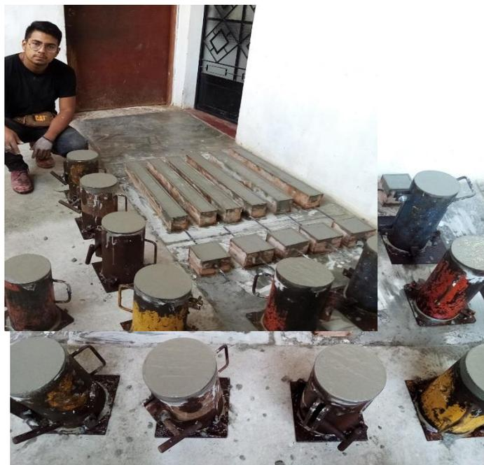
**Figura 66.** Algunas probetas cilíndricas culminadas para ensayo de compresión y tracción
