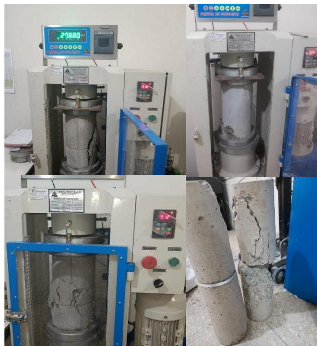
**Figura 95.** Falla de probetas a los 28 días para ensayos de compresión
