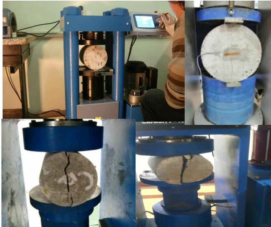
**Figura 99.** *Ensayo de Resistencia a tracción*
