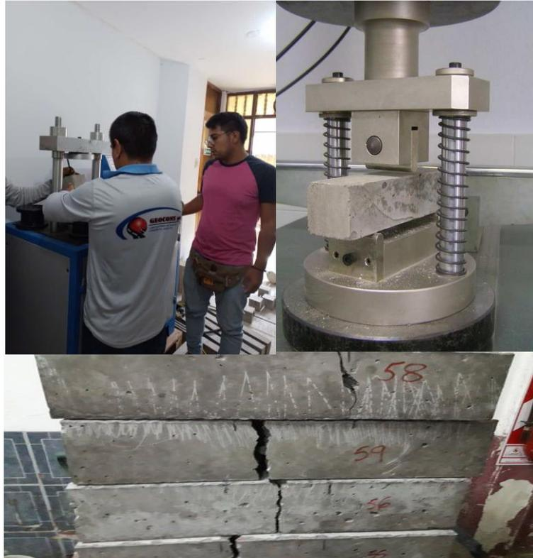
**Figura 78.** *Ensayo de adherencia concreto-acero a los 21 días*
