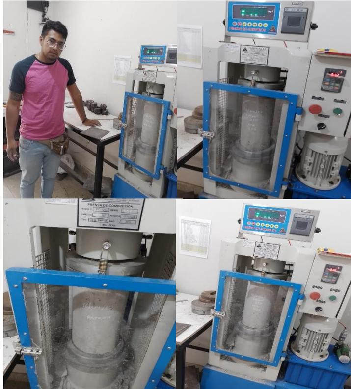
**Figura 92.** Ruptura de probetas a los 21 días para ensayos de compresión
