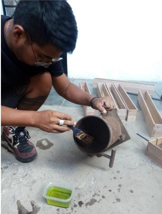
**Figura 59.** Preparando molde para vaciado de muestra
