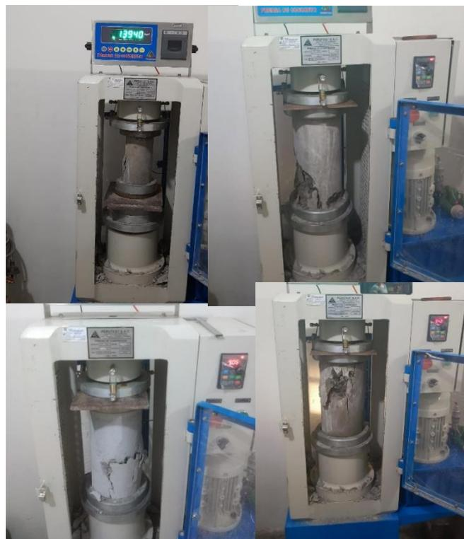
**Figura 91.** Falla de probetas a los 7 días para ensayos de compresión
