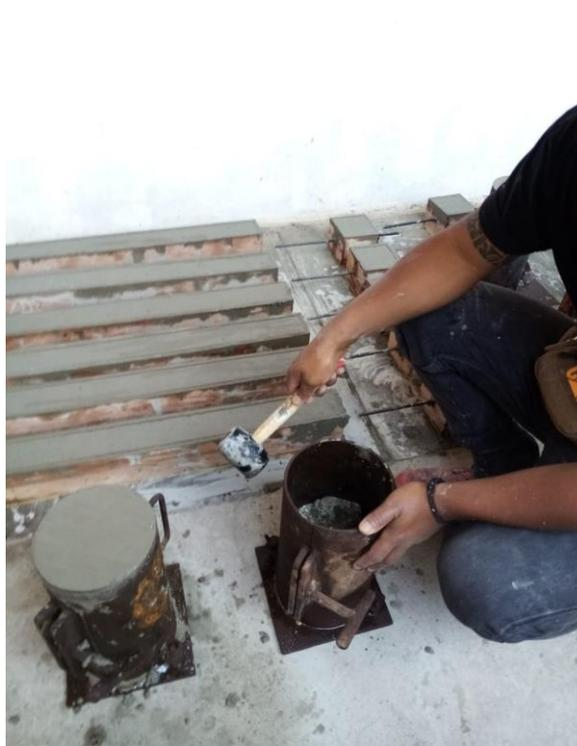
**Figura 61.** Golpeo con combo de goma de primera capa de concreto
