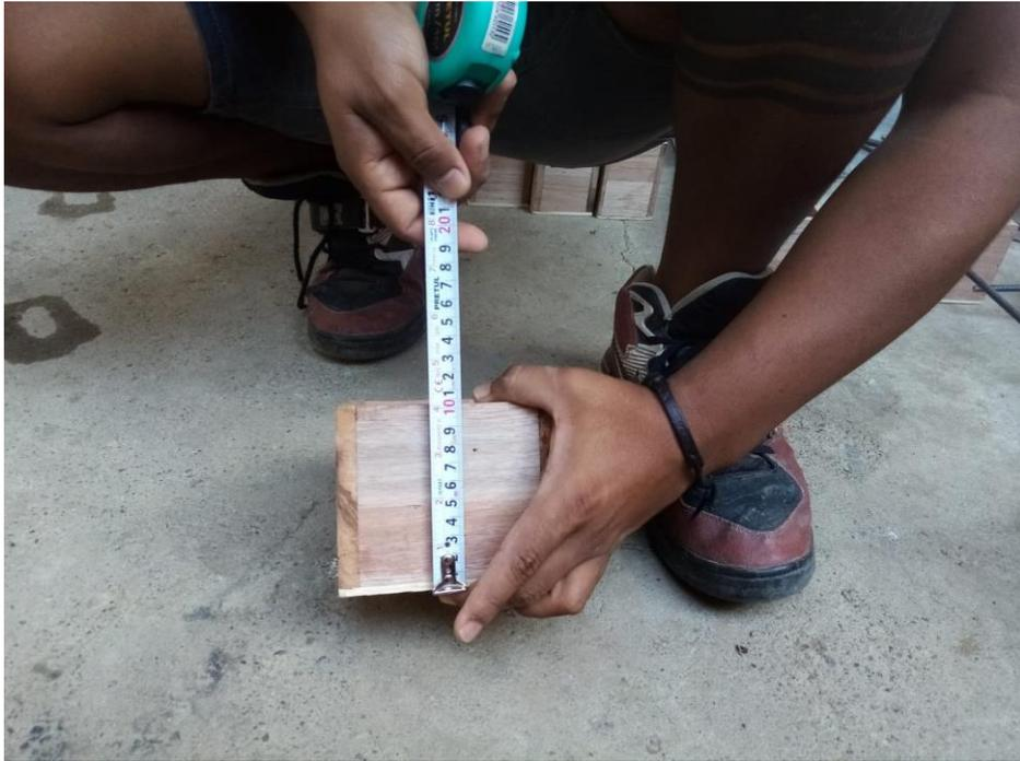
**Figura 47.** Longitud de alto de 10cm para molde de ensayo de adherencia concreto-acero
