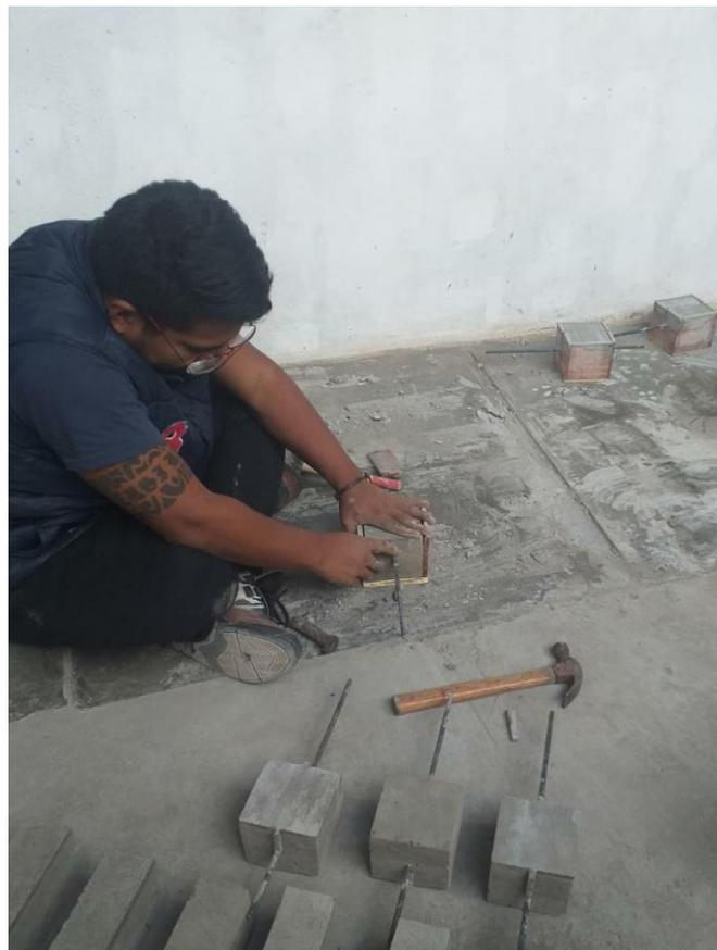
**Figura 69.** *Desenfofrado de probetas cubicas*
