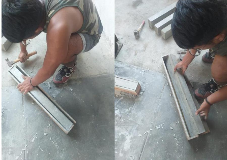
**Figura 67.** *Desencofrado de probetas tipo viga*
