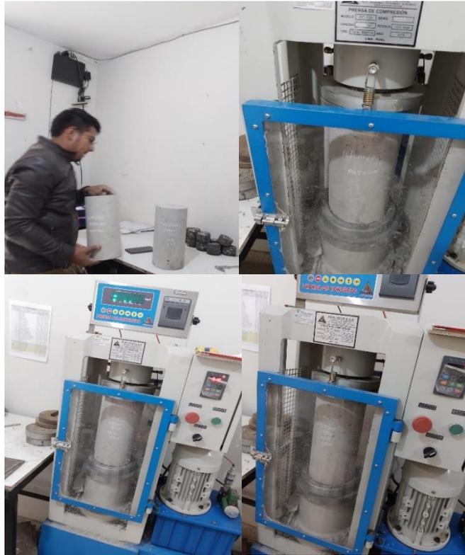
**Figura 94.** Ruptura de probetas a los 28 días para ensayos de compresión
