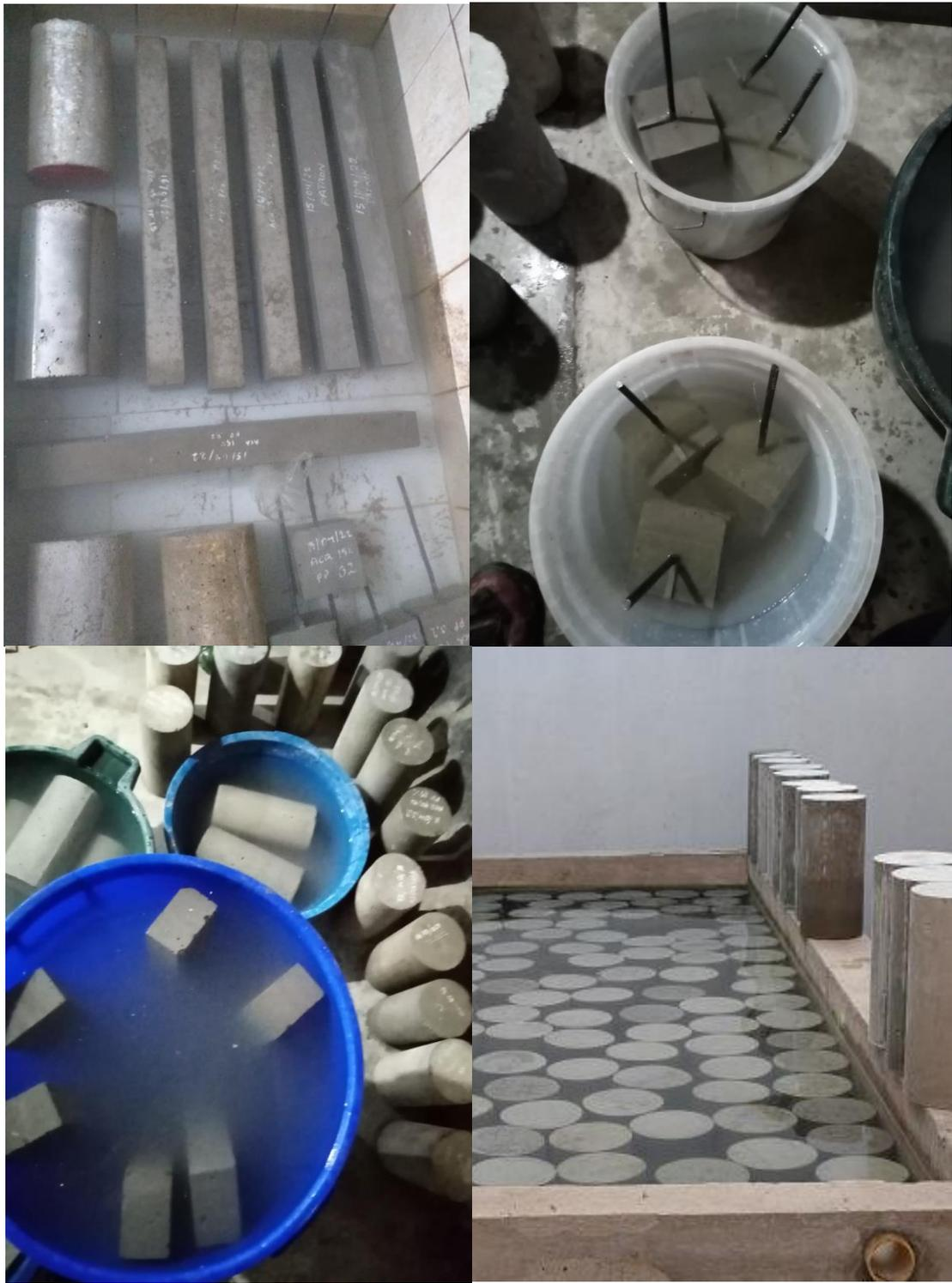
**Figura 76. Curado de probetas**
