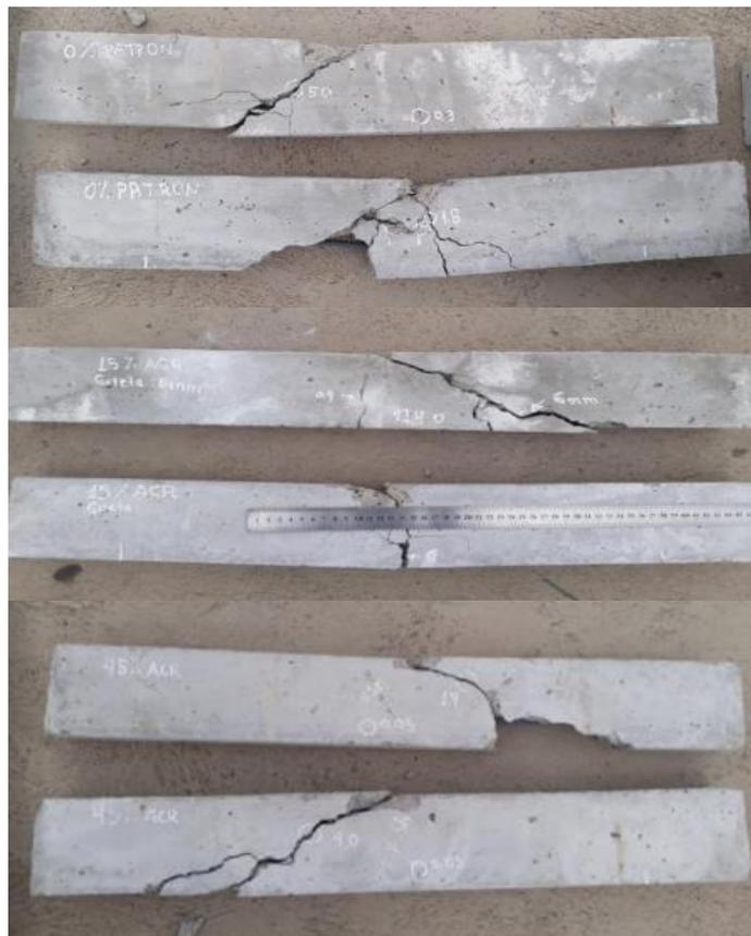
**Figura 79.** *Ensayo de adherencia concreto-acero a los 21 días*
