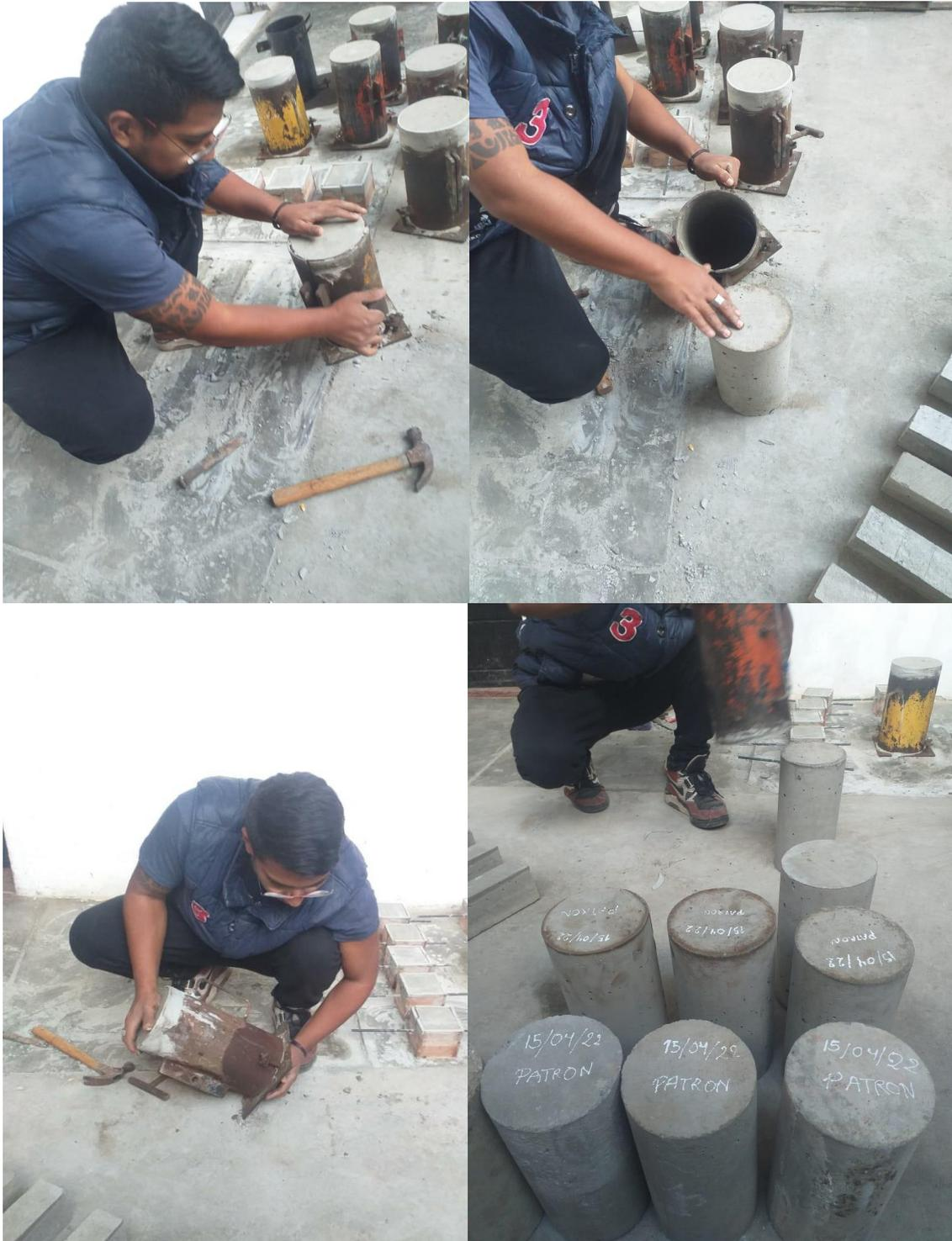
Figura 71. Desencofrado de probetas cilíndricas
