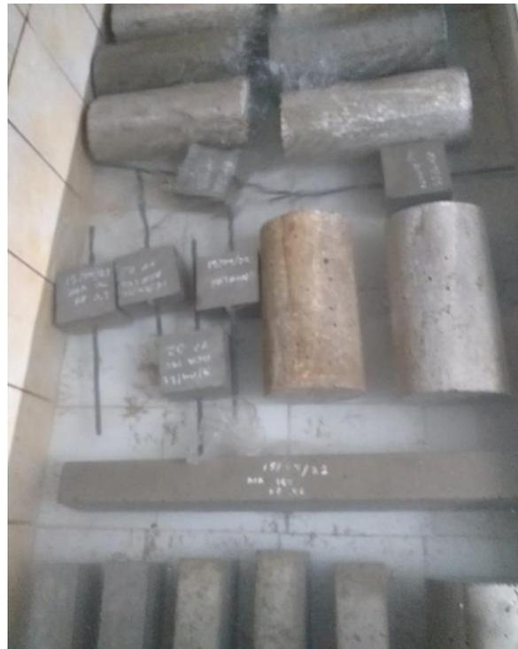
**Figura 75.** *Curado de probetas*
