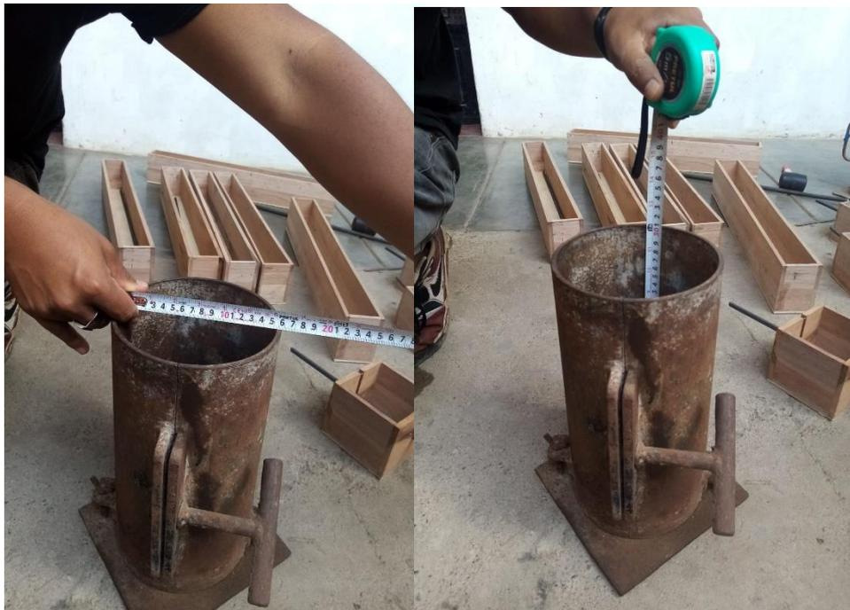
**Figura 58.** *Dimensiones de probetas cilíndricas para ensayos de compresión y tracción*
