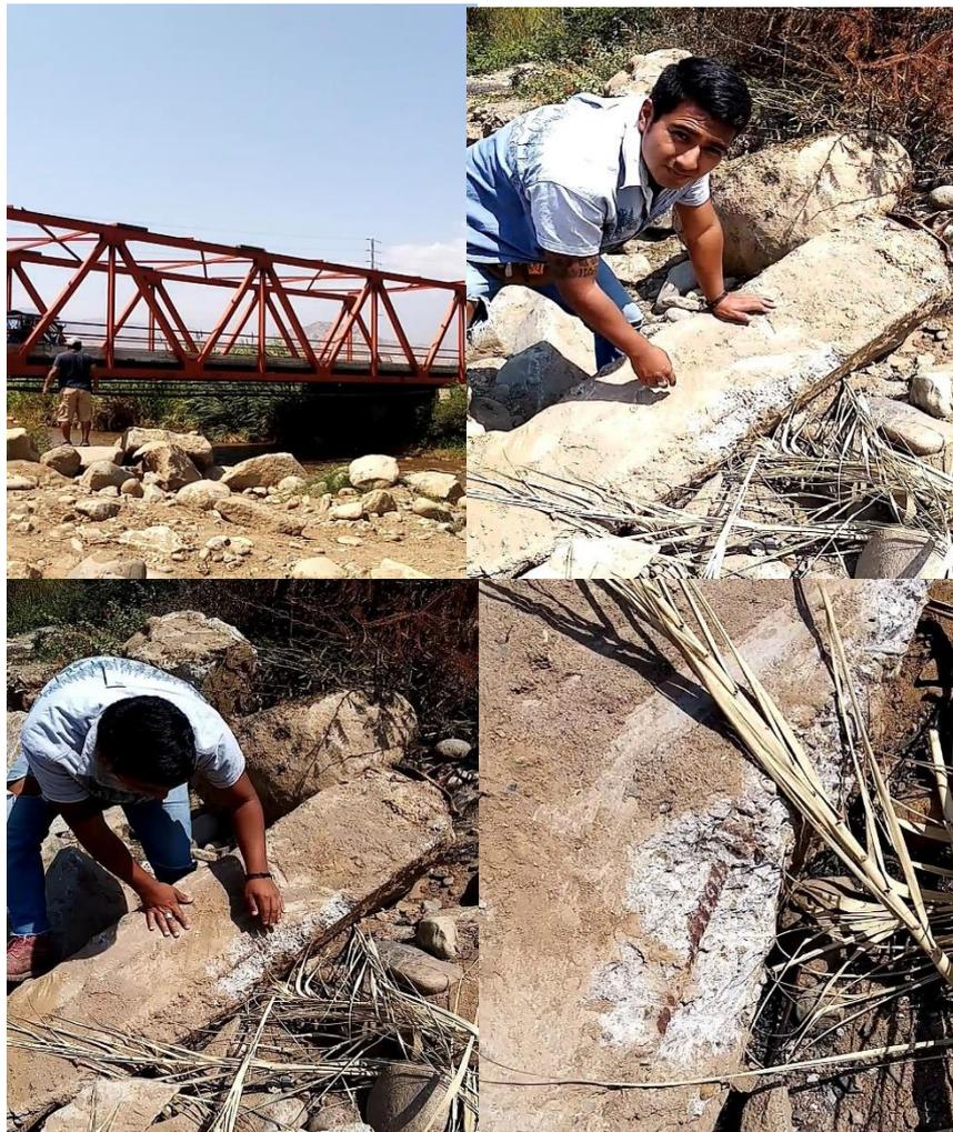
**Figura 24.** *Concreto reciclado de partes de estructuras demolidas en anterior puente Cerro Blanco*
