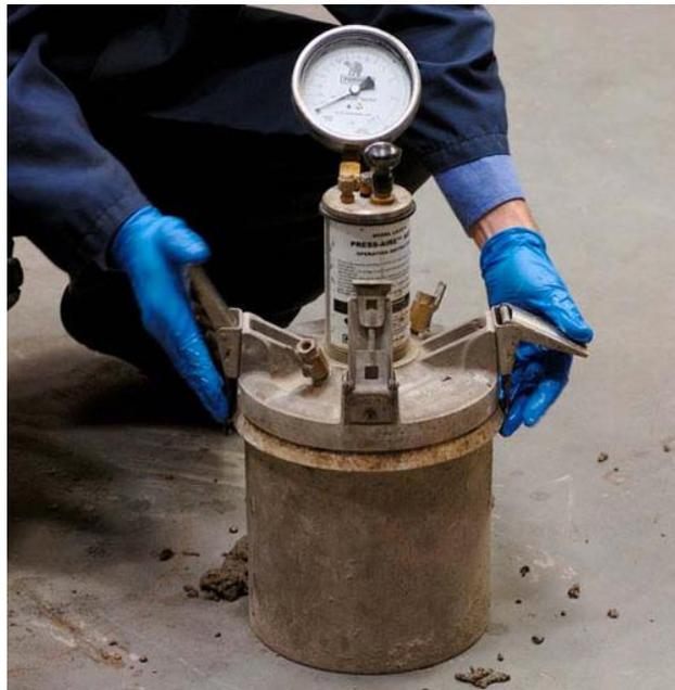
**Figura 3 .** *Contenido de aire. Tomada de “Propiedades físicas y mecánicas del hormigón”, por (Izquierdo, Izquierdo, & Ramalho, 2018)*
