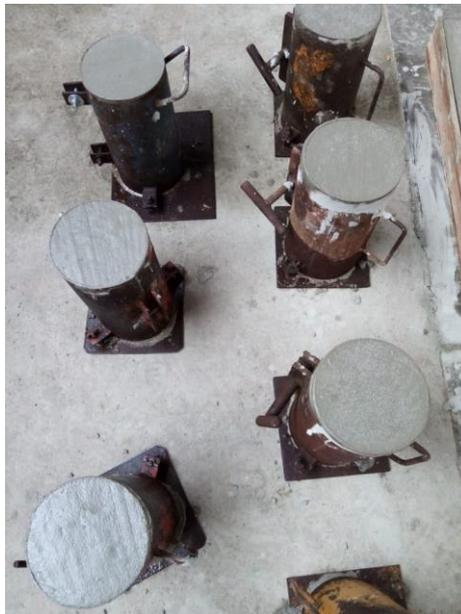
**Figura 10.** *Muestras para ensayo de resistencia a compresión del concreto*
