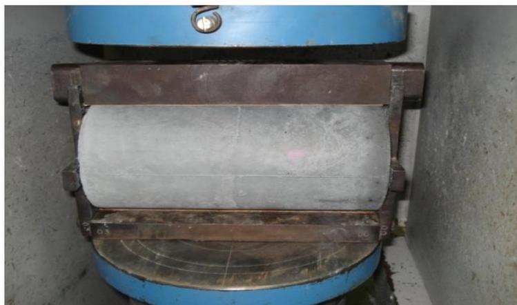
**Figura 7.** *Ensayo de tracción. “Más allá de la resistencia a la compresión: calidad y propiedades del concreto en estado endurecido”, por (ALION, 2019)*
