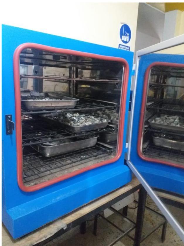
**Figura 20.** Horno para detención de humedad de los agregados
