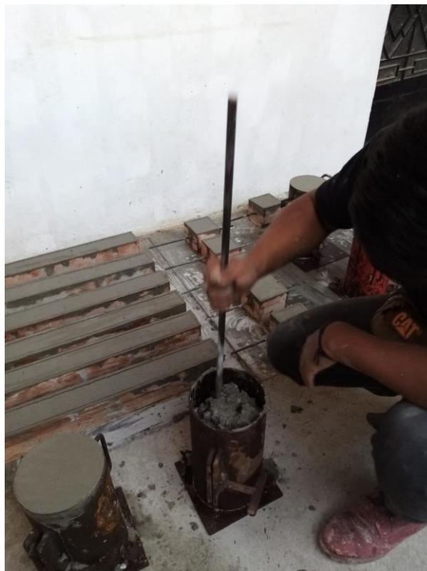
**Figura 62.** Chuzado de segunda capa de molde para dado de ensayo de compresión y tracción
