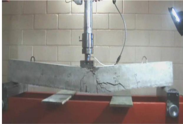
**Figura 8.** *Ensayo de flexión. “Más allá de la resistencia a la compresión: calidad y propiedades del concreto en estado endurecido”, por (ALION, 2019)*
