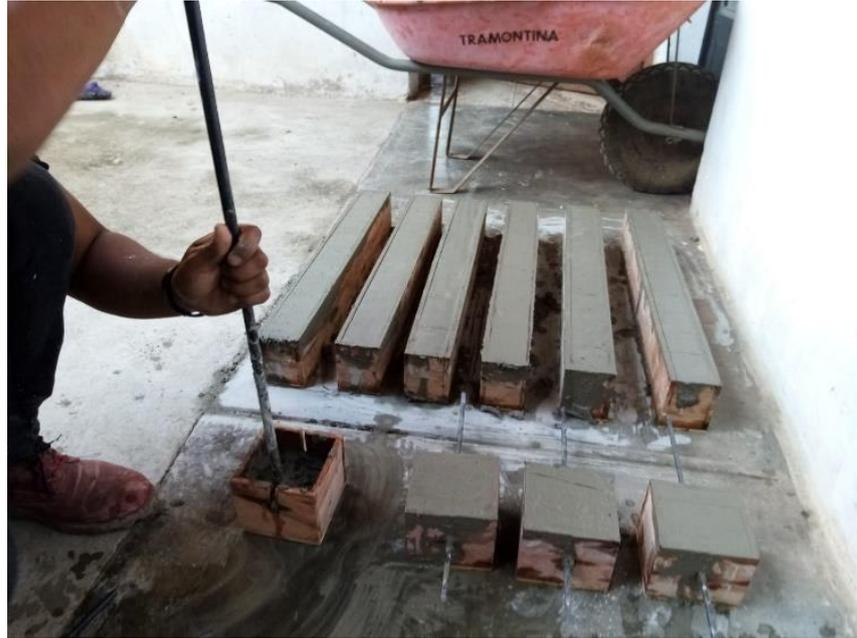
**Figura 51.** *Chuzado de primera capa de molde para dado de ensayo de adherencia*
