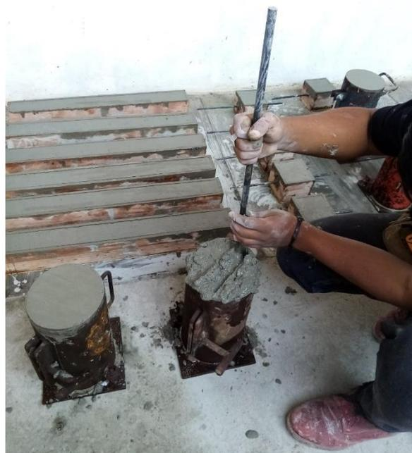
**Figura 64.** Chuzado de tercera capa de molde para dado de ensayo de compresión y tracción
