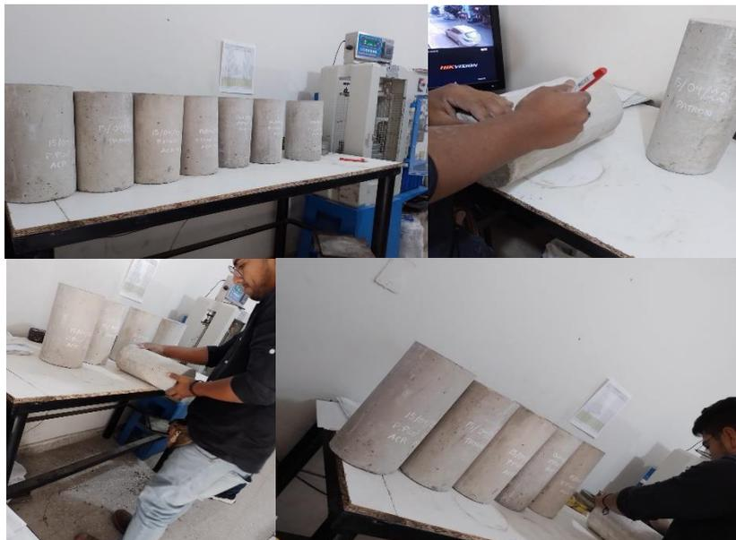
**Figura 89.** *Marcado de probetas para ensayos de compresión*
