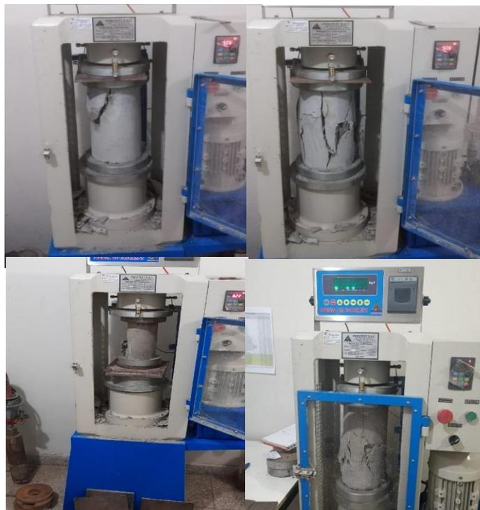
**Figura 93.** Falla de probetas a los 21 días para ensayos de compresión
