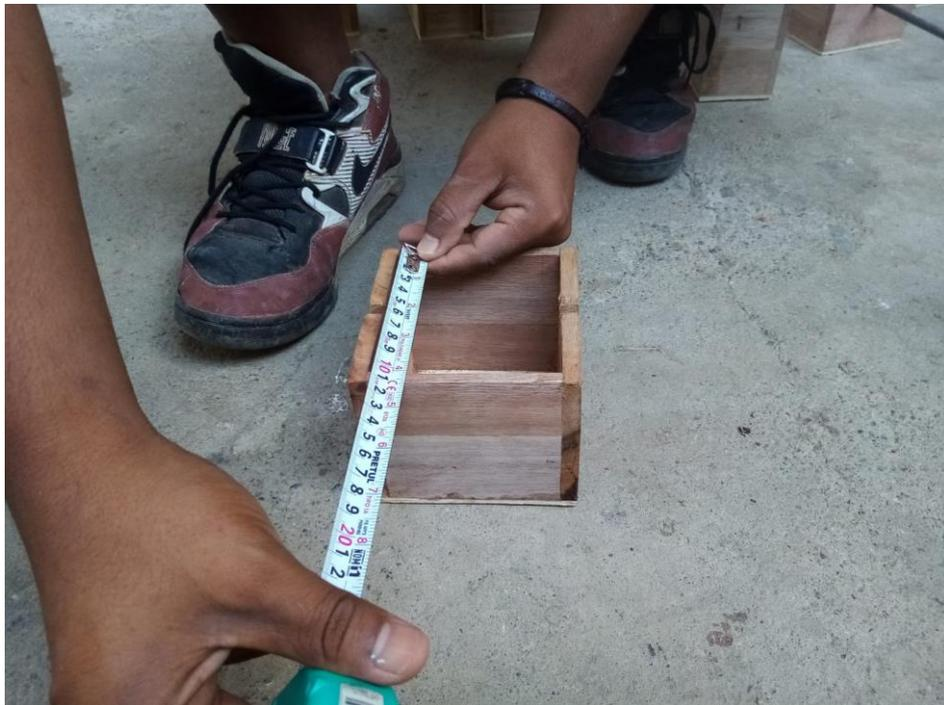
**Figura 48.** Longitud de ancho de 10cm para molde de ensayo de adherencia concreto-acero
