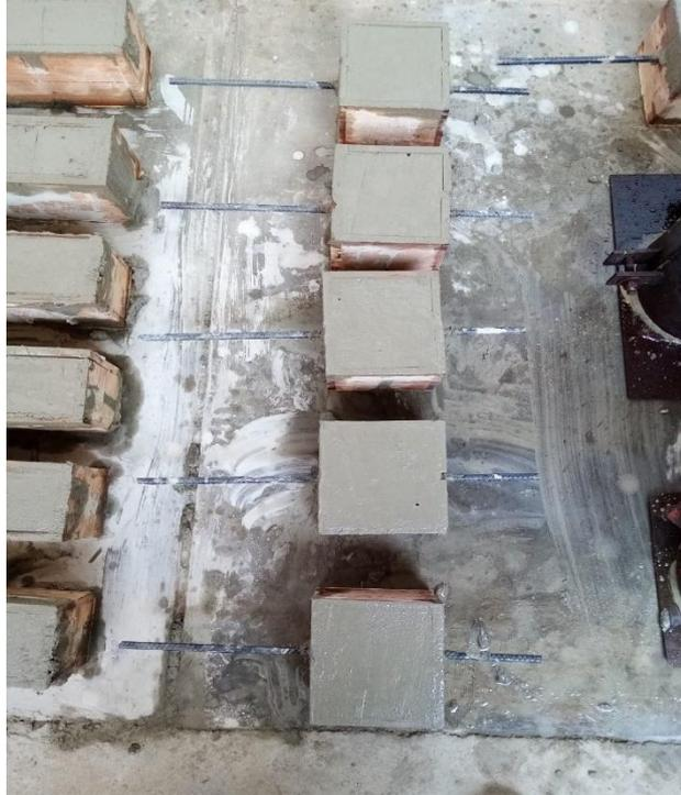
**Figura 57.** *Algunas probetas cúbicas culminadas para ensayo de adherencia concreto-acero*
