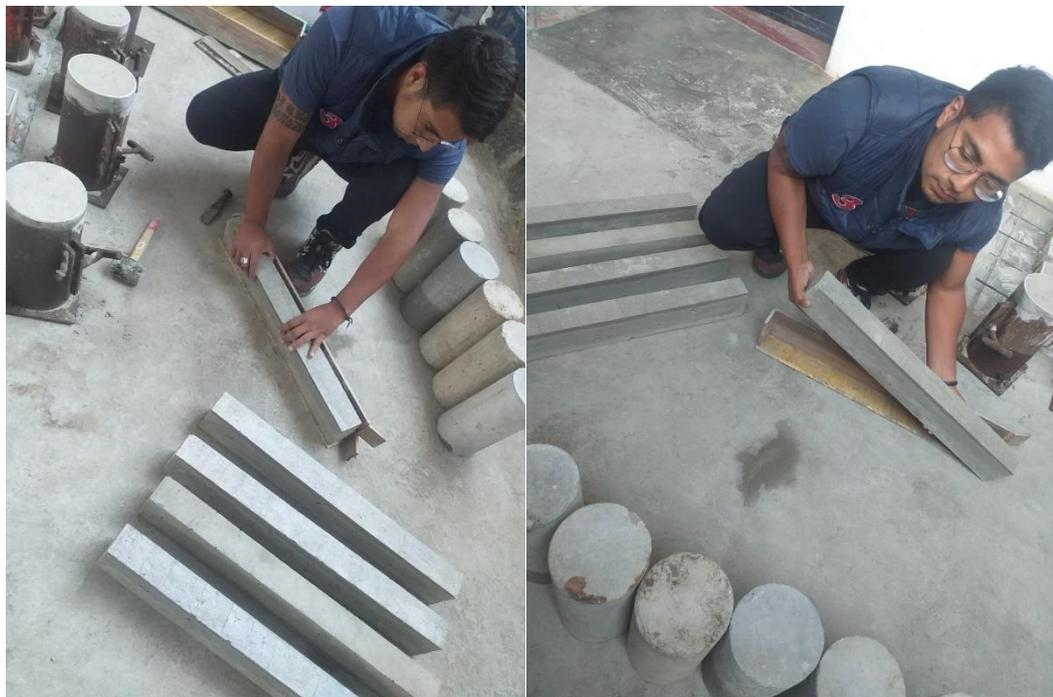
**Figura 68.** *Probetas tipo viga desencofradas*
