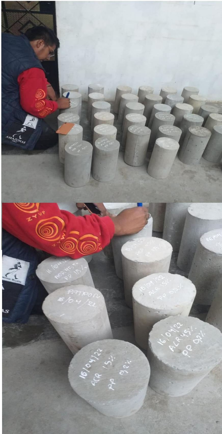
**Figura 73.** Identificación de probetas con fecha y tipo de muestra según combinación de aditivo y ACR
