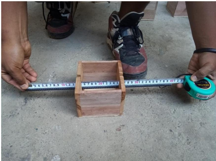
**Figura 50.** Longitud de desarrollo para acero de diámetro de 8mm para ensayo de adherencia concreto-acero
