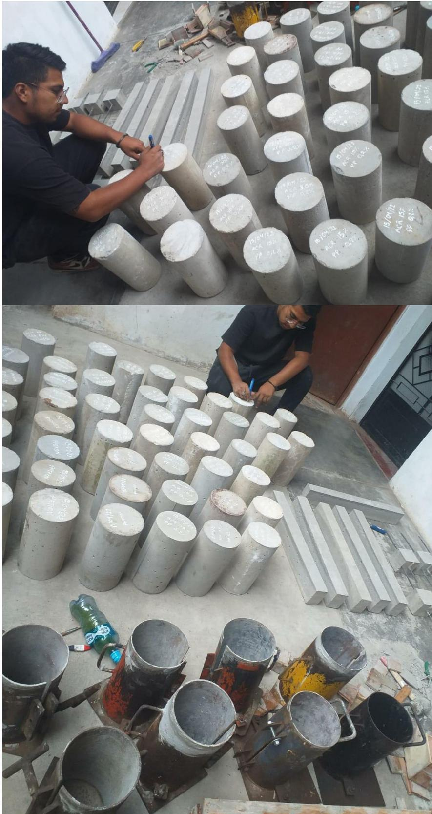
**Figura 72.** Identificación de probetas con fecha y tipo de muestra según combinación de aditivo y ACR
