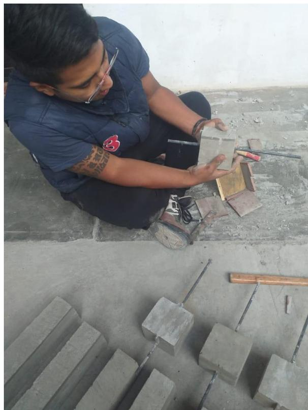
**Figura 70.** *Probetas tipo cubo desenfofradas*
