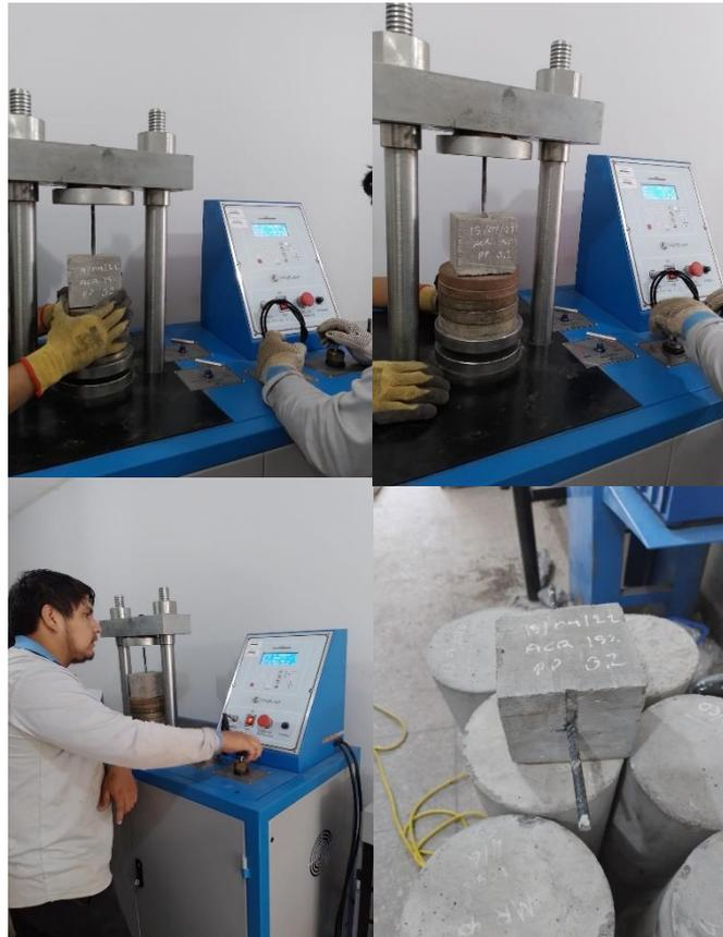
**Figura 85.** *Ensayo de adherencia concreto-acero a los 28 días*
