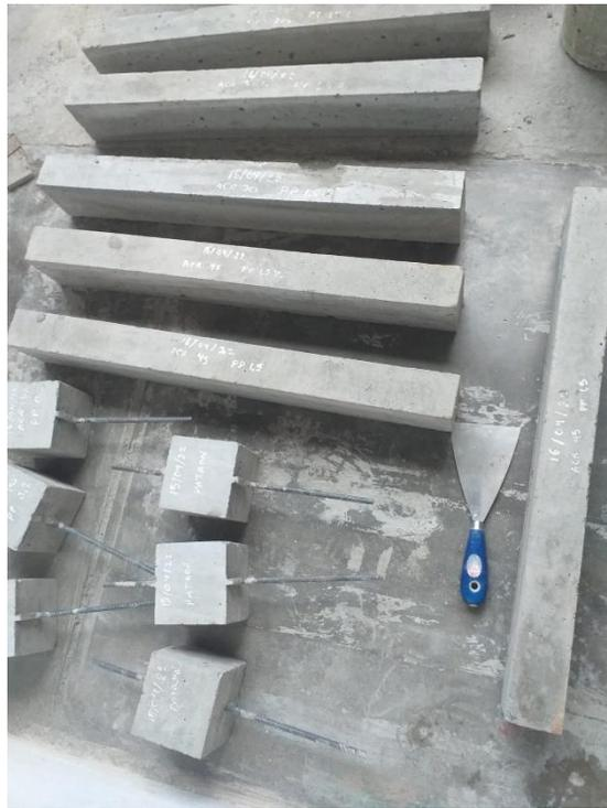
**Figura 74.** *Identificación de probetas con fecha y tipo de muestra según combinación de aditivo y ACR*
