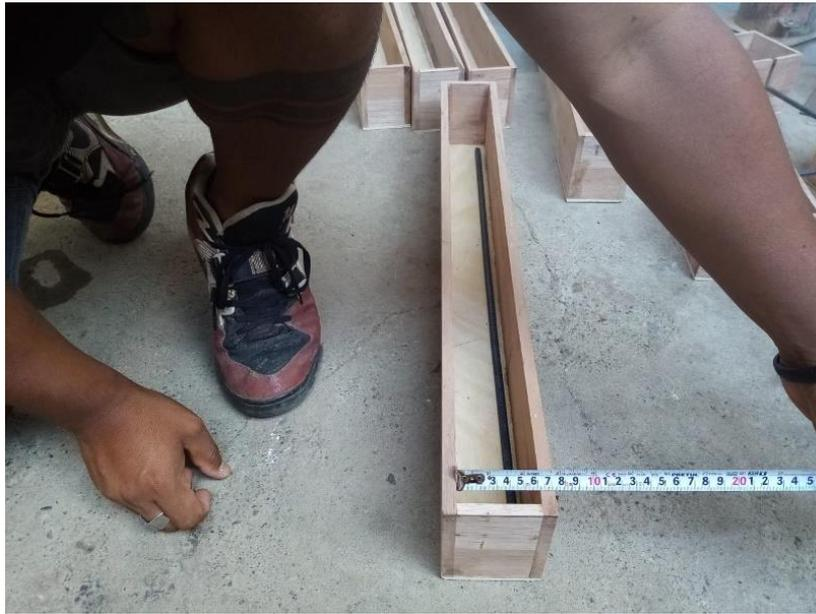
**Figura 35.** Longitud de lancho de 7cm para molde de ensayo de flexión
