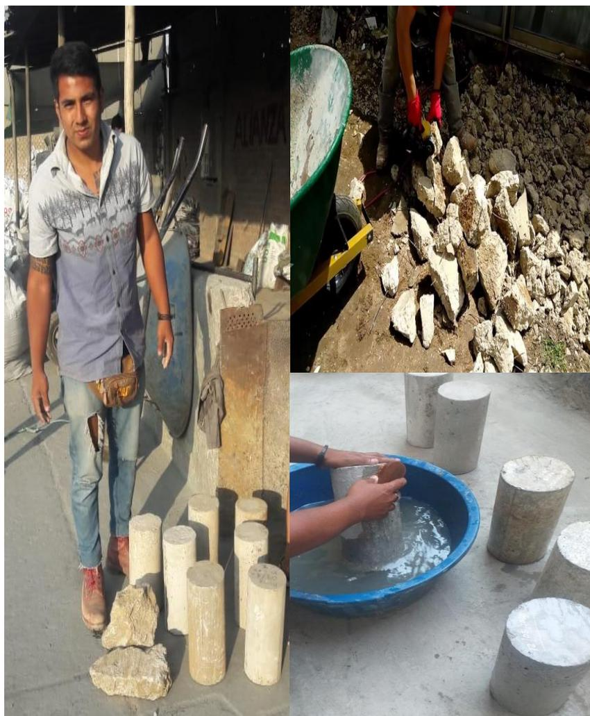
**Figura 25.** *Chancado y limpieza de probetas de material de desecho*
