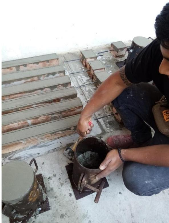
**Figura 63.** Golpeo con combo de goma segunda capa de concreto
