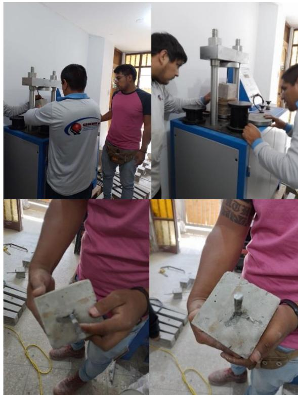
**Figura 84.** *Ensayo de adherencia concreto-acero a los 21 días*
