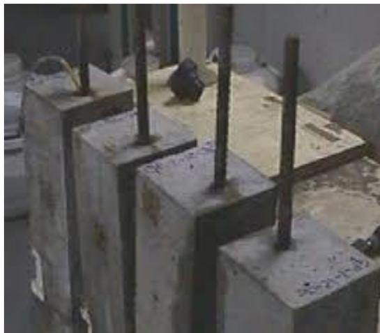
**Figura 9.** *Ensayo de adherencia concreto-acero. “Más allá de la resistencia a la compresión: calidad y propiedades del concreto en estado endurecido”, por (ALION, 2019)*
