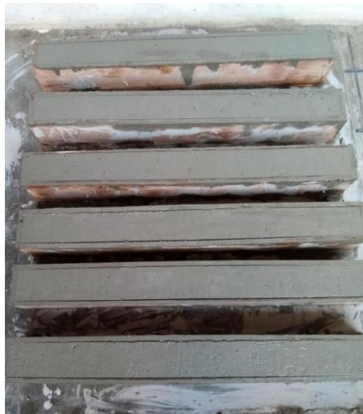
**Figura 12.** *Muestras para ensayo de resistencia a flexión del concreto*
