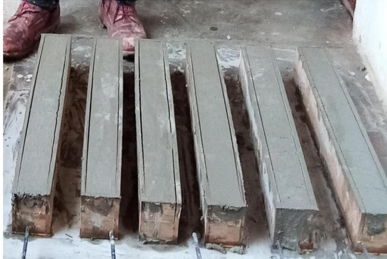
**Figura 13.** Muestras para ensayo de resistencia a flexión del concreto
