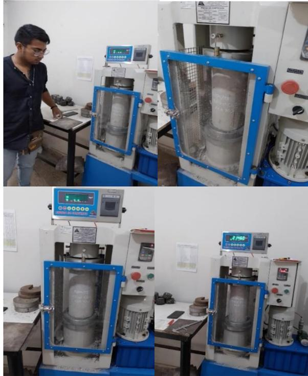
**Figura 90.** Ruptura de probetas a los 7 días para ensayos de compresión
