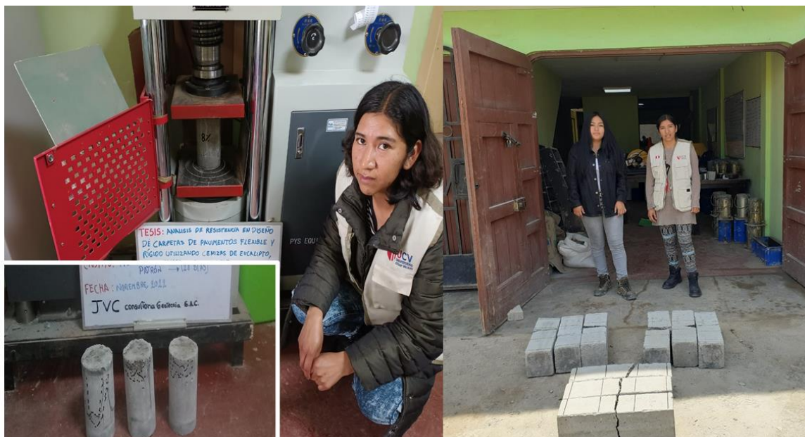
Figura 36: Rotura de probetas de concreto
