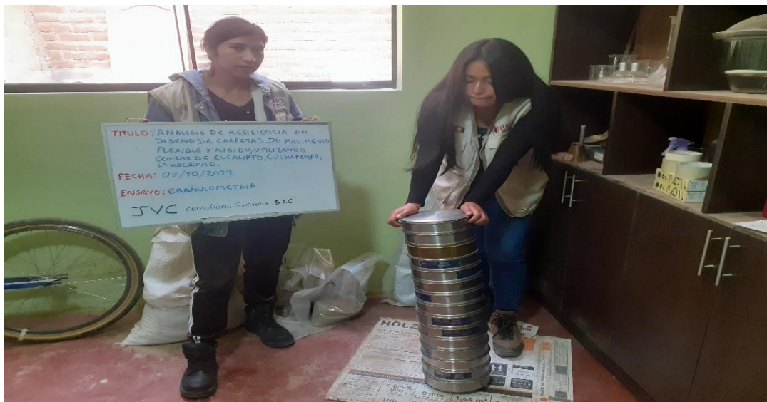
Figura 16: Fotografía de ensayo granulométrico de agregados
