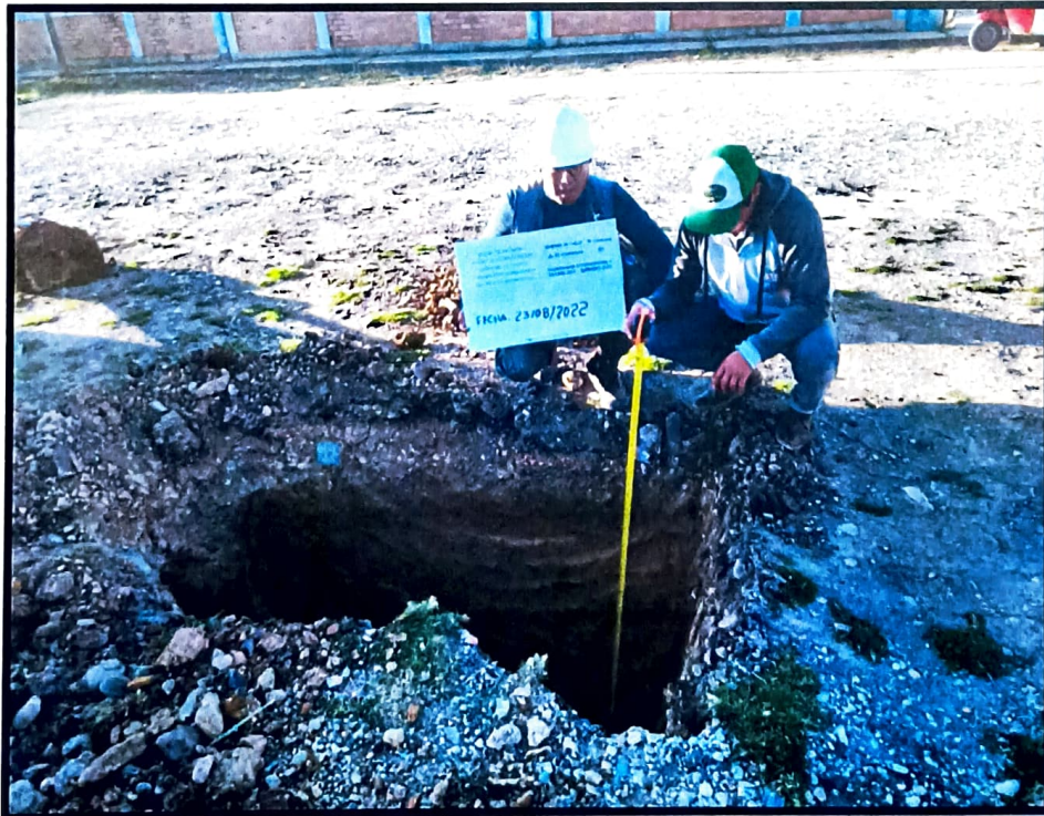
Fotografía 2. Toma de medidas de la calicata N° 01 realizada en la calle Jr El Comercio
