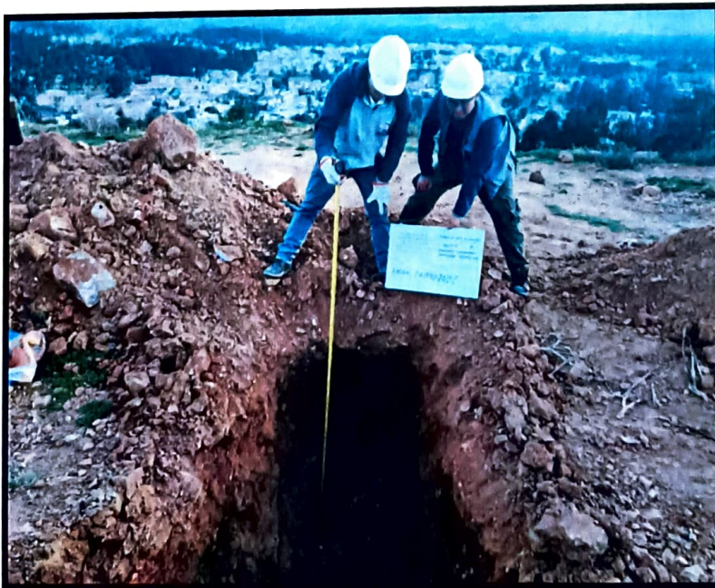
Fotografía 13. Se observa la toma de medidas de la calicata N° 07 en el Psje. El Jardín
