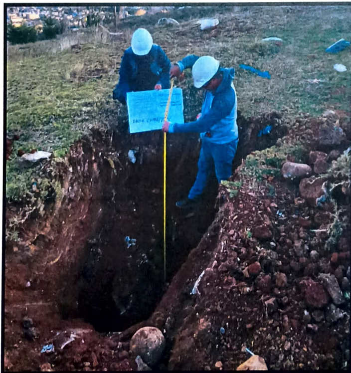
Fotografía 10. Se observa la toma de medidas de la calicata N° 05 realizada en Jr. Esmeralda
