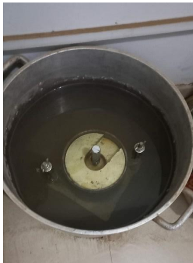
Figura 10. Curado de la probeta.
