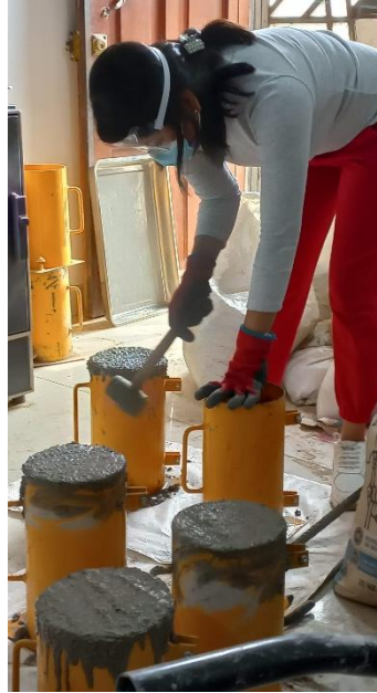
Figura 9. Ruptura de burbujas de aire por acción de los golpes de martillo.
