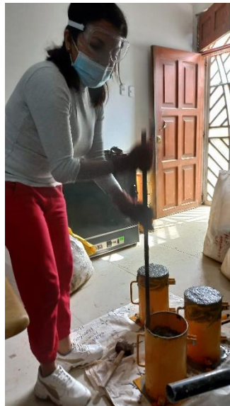
Figura 8. Inserción de varilla en la mezcla.
