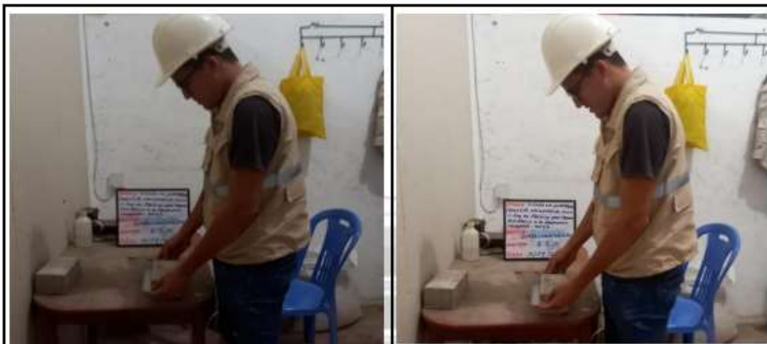
Fotos nº 21-22: En las imágenes podemos observar el Dimensionamiento de los adoquines de concreto
