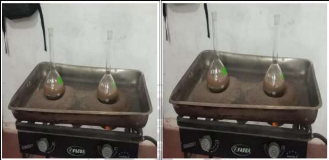
Fotos nº 05-06: En las imágenes podemos observar la realización del ensayo el peso específico
