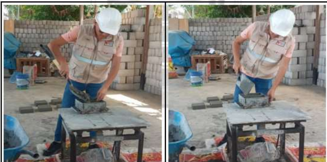
Fotos nº 11-12: En las imágenes podemos observar al personal realizando moldeo de los adoquines de concreto.
