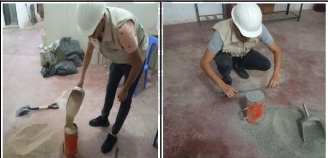
Fotos nº 07-08: En las imágenes podemos observar realización del ensayo de peso unitario.
