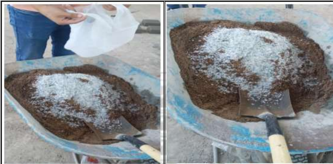
Fotos nº 09-10: En las imágenes podemos apreciar los materiales a utilizar para el diseño de concreto con incorporación de fibras de Plástico.
