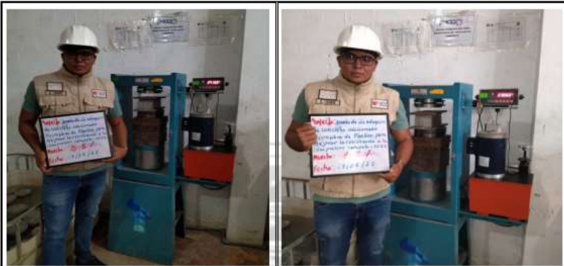
Fotos nº 17-18: En las imágenes podemos observar la resistencia a la compresión axial de los adoquines de concreto
