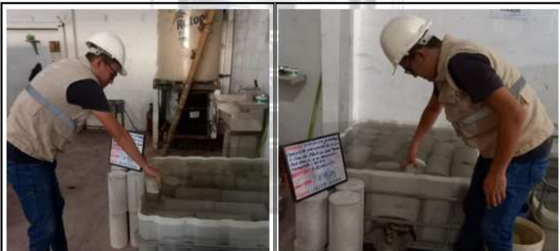
Fotos nº 19-20: En las imágenes podemos observar la absorción de los adoquines de concreto
