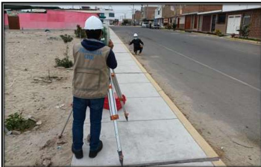
*Figura 1. Levantamiento topográfico (toma de puntos)*
