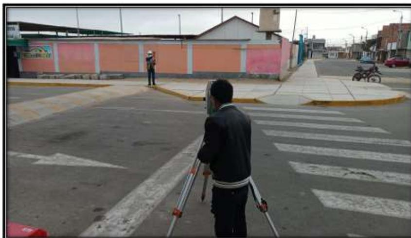
Figura 2. Levantamiento topográfico (toma de puntos)
