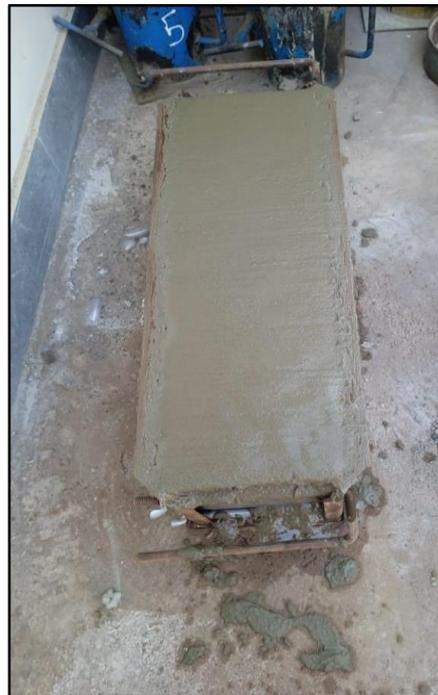
MOLDEO DE LAS BRIQUETAS Y VIGAS
