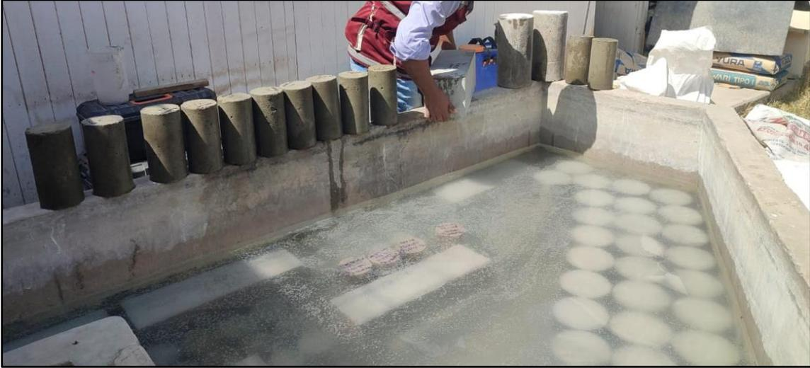
CURADO DEL CONCRETO – PROBETAS Y VIGAS
