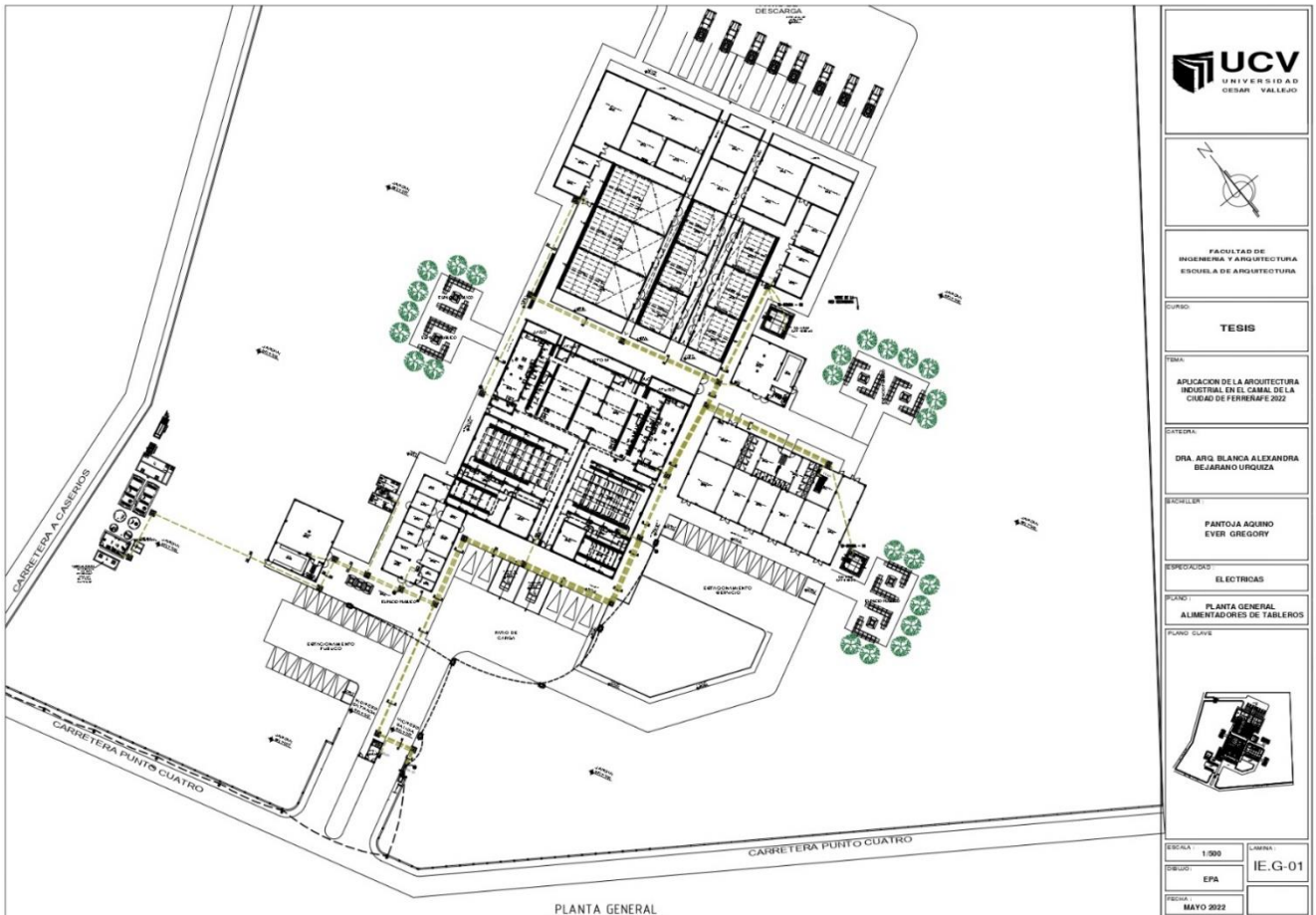
Figura 63: Planta general distribución de tableros
