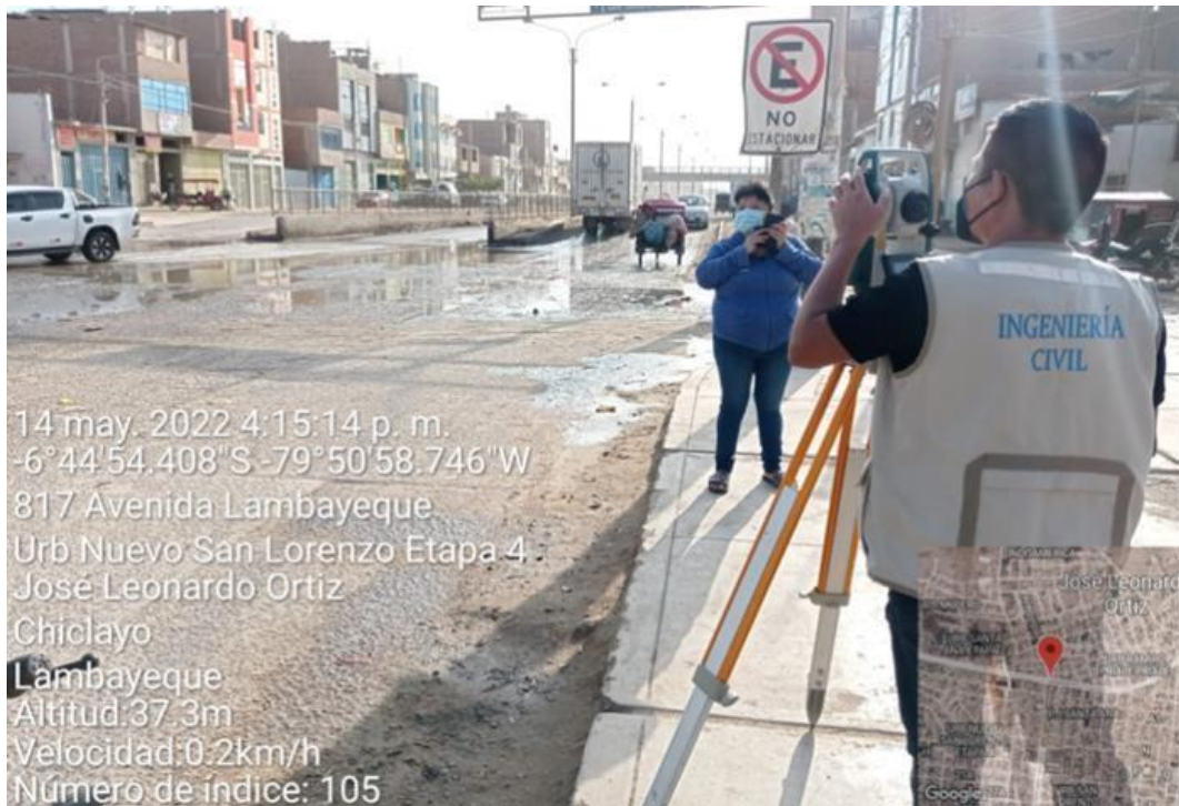
Figura 5 Lectura de puntos en la estación total.
