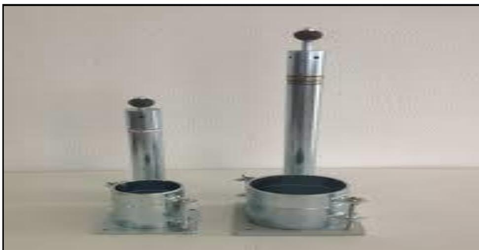
Figura 5. Equipos de compactación para Proctor modificado
