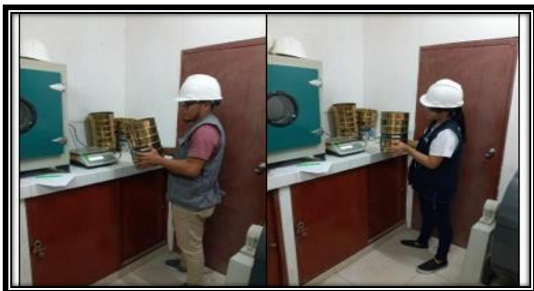
Figura 22. Análisis granulométrico por tamizado
