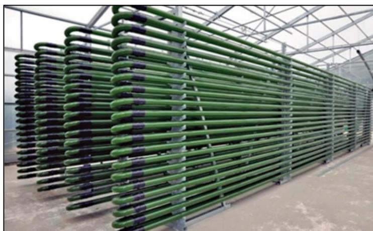
Figura 15. Diseño de un biorreactor tubular horizontal.
