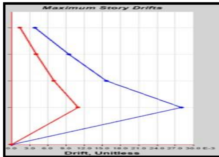
Figura 30: Distorsión en entre piso en X Fuente: Elaboración propia
