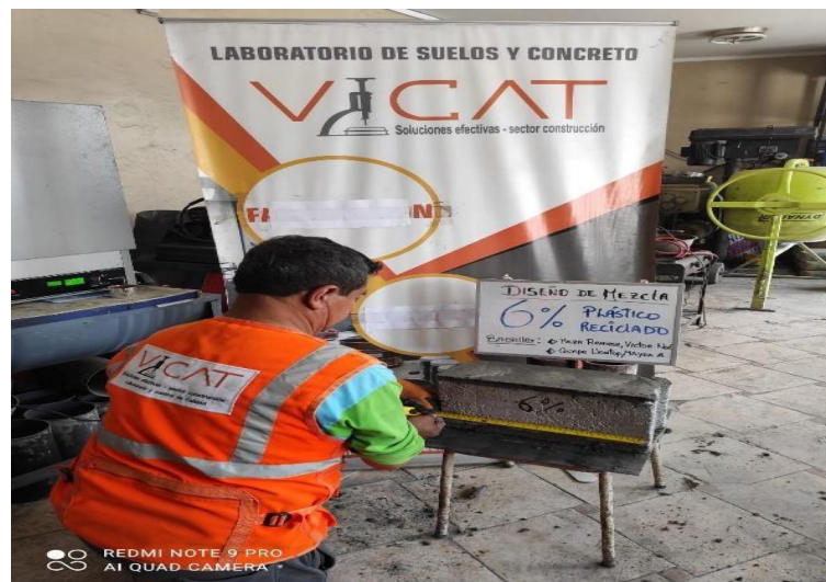
Figura 18. Dimensionamiento de Bloques Fuente: Elaboración Propia
