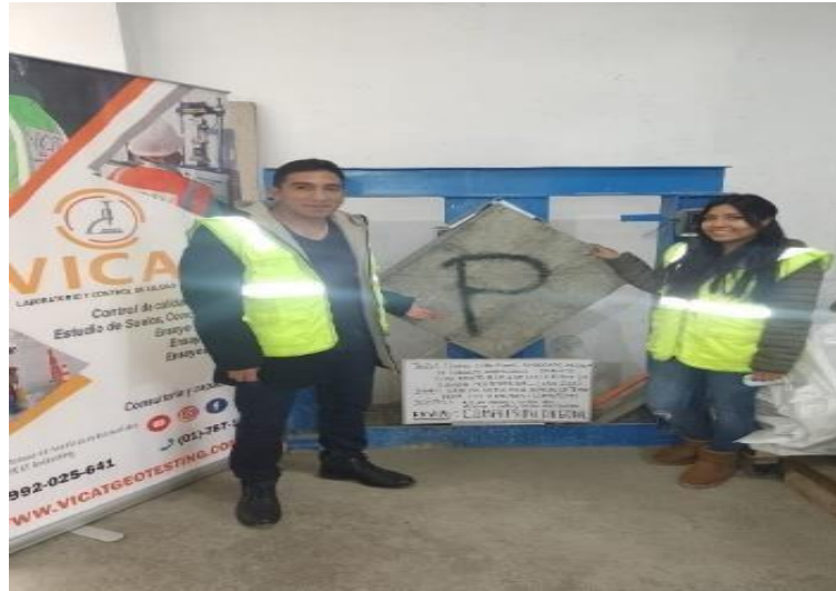
Figura 15. Ensayo de Compresión Diagonal del Patrón Fuente: Elaboración Propia
