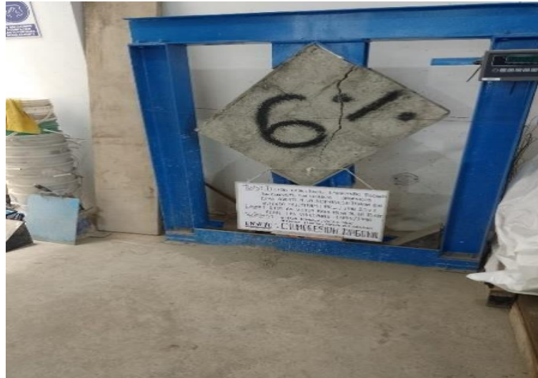
Figura 17. Ensayo de Compresión Diagonal del 6% de Plástico Reciclado Fuente: Elaboración Propia
