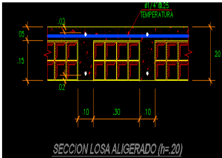
Figura 23. Detalle de losa aligerada
