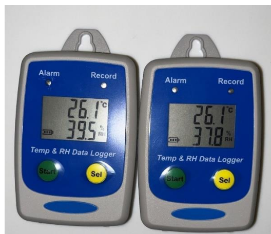
Figura 8. Equipo de medición de temperatura Datalogger DTR-305.
